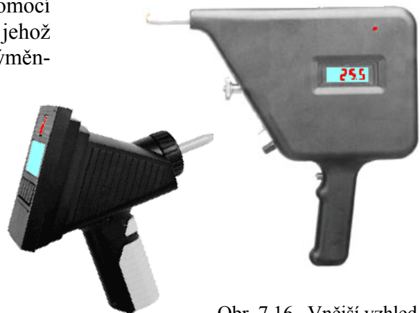
Obr. 7.16. Vnější vzhled simulátorů ESD [40]
