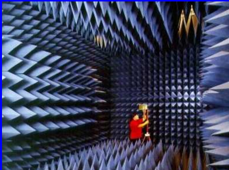
Interiér plně bezodrazové komory Elliott Labs (UK)
