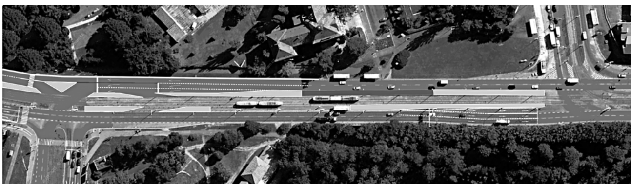
Poslední fotomontáž dokumentuje stav, který měl být záměrem projektanta a fungujícím cílovým stavem. Autobusy vyjíždějící z ulice Na Chmelnici měly získat separátní volno, které by jim umožnilo bezpečný přejezd dvou pruhů a nájezd na tramvajové těleso ve směru do centra. Ve směru z centra je vytvořena předřazená světelná závora pro odbočující automobily, která umožní vyjetí autobusu z tramvajového tělesa a zařízení se před odbočující automobily. Jelikož bus v přímém směru může využít nekolizní signalizaci pro tramvaje a sjet v křižovatce do přípojovacího pruhu, může být přímý směr oddělen pomocí vodorovných dělicích prahů v celé délce od předřazené světelné závory, a zajistit tak kázeň řidičů motorových vozidel. Zdroj: Ortofotomapa
