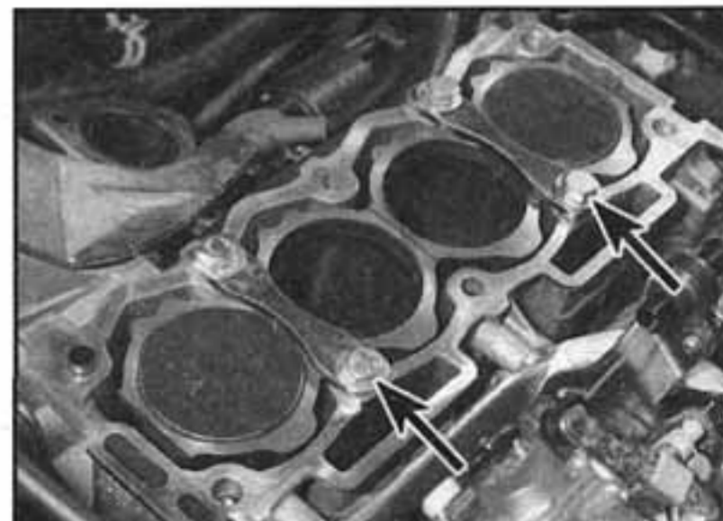
12.21 Vložky válců MUSÍ být upevněny v pozici před otočením klikového hřídele (šipky vyznačují svorky)
