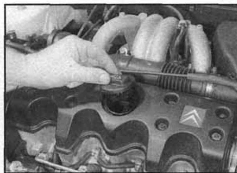
3.11c ...poté vyšroubujeme uzávěr plnicího hrdla z víka hlavy válců
