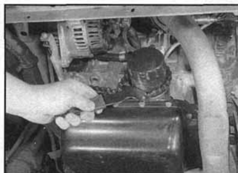
3.7a Uvolníme olejový filtr pomocí demontážního nástroje
