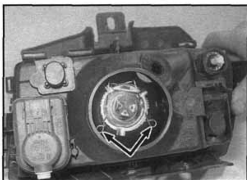
5.4 Společně stlačíme smyčkové koncovky upevňovací svorky žárovky (viz šipky) – světlomet je demontován pro lepší přehlednost
