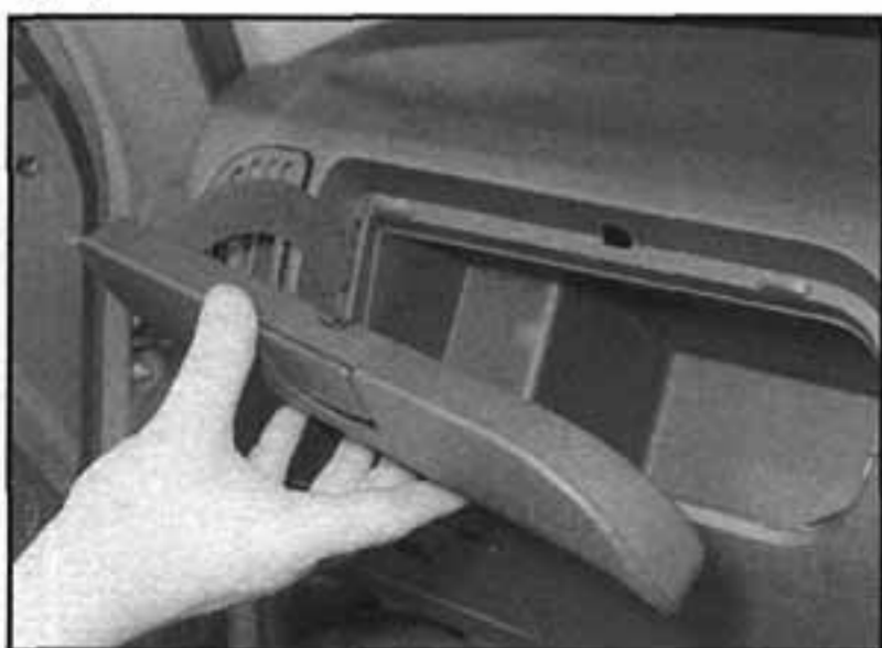
26.40 Demontáž víka odklád. schránky
