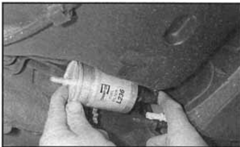
18.6 Usadíme nový palivový filtr do jeho patřičné pozice a ujistíme se, že šipka na něm ukazuje ve směru průtoku paliva
