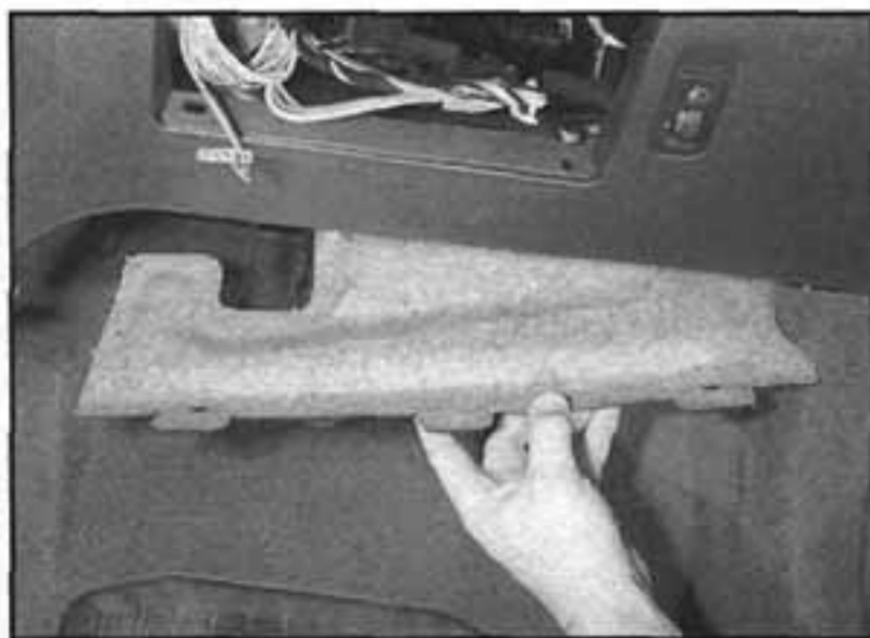
13.5 Demontáž obložení pod přístrojovou deskou
