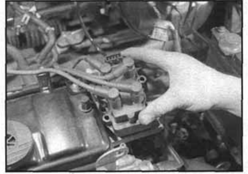
3.4 Uvolníme čtyři upevňovací šrouby a demontujeme vysokonapěťovou zapalovací cívku z její montážní vzpěry
