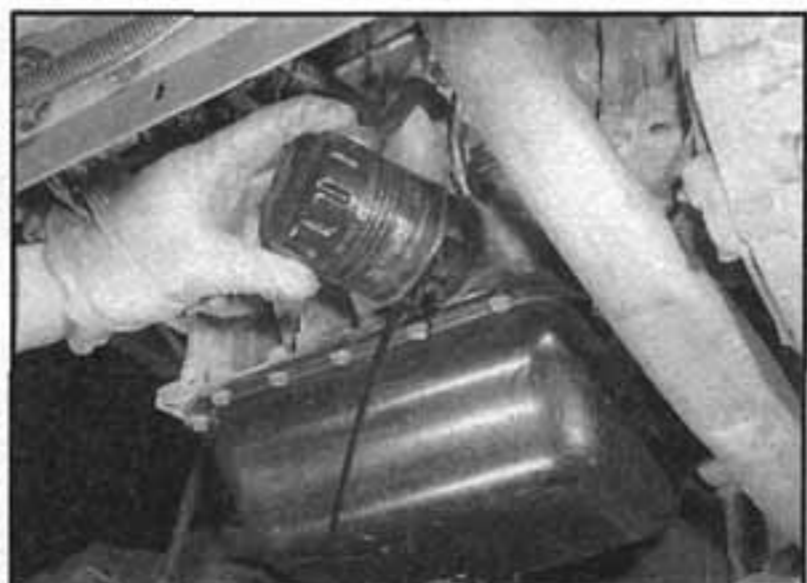
3.7b ...poté vyšroubujeme filtr rukou z vozidla
