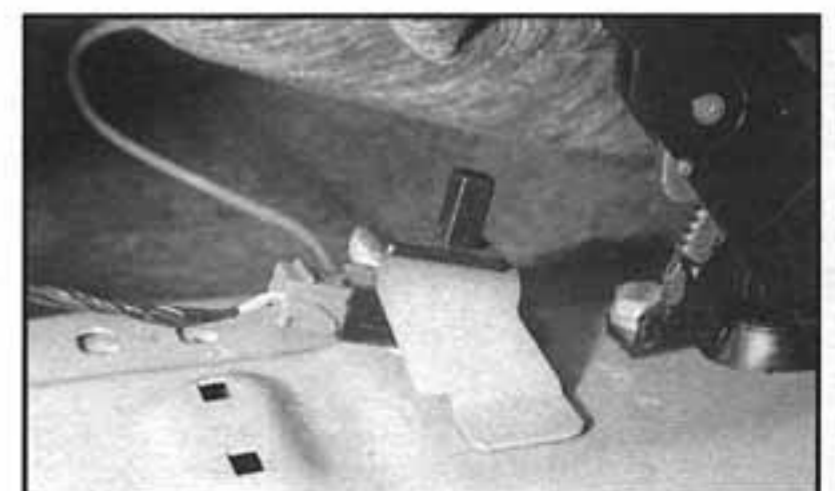
22.3 Nadzvedneme koberec pro lepší přístup ke spínači ruční brzdy
