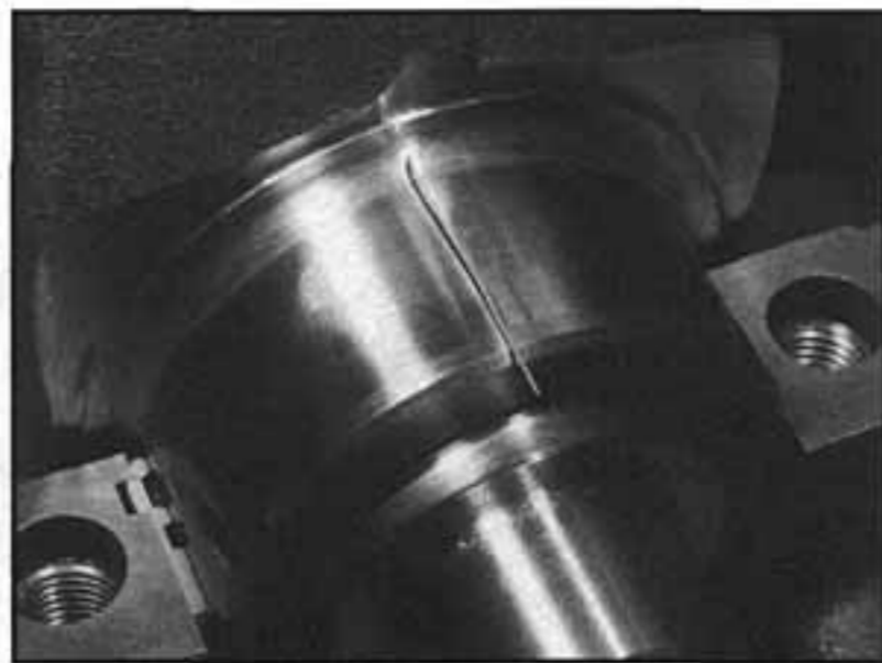
17.16 Podélně položíme na ložiskový čep klikového hřídele plastickou nit
