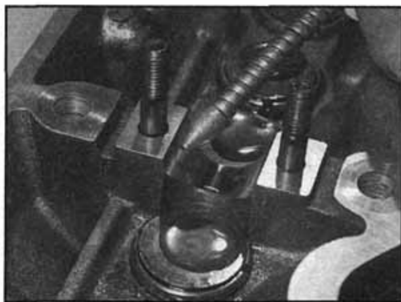
9.12 Před montáží vačkového hřídele pečlivě namažeme plochy ložiska vačkového hřídele
