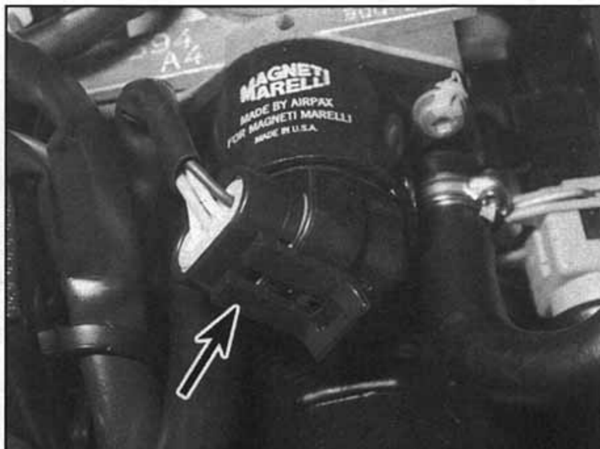
14.6 Odpojíme konektor kabeláže z krokového elektromotoru regulace volnoběžných otáček
