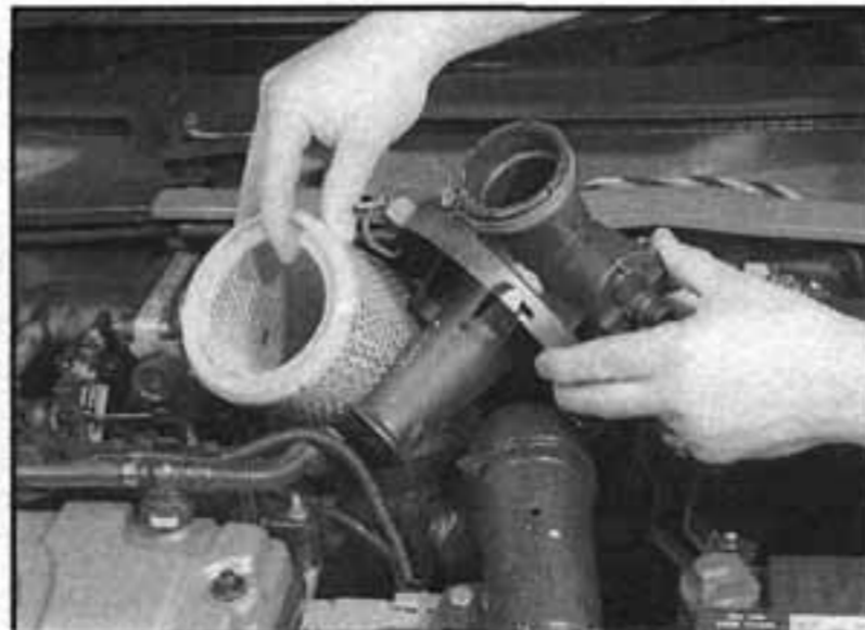
19.12 Vyjmeme z pouzdra vzduchového filtru vložku
