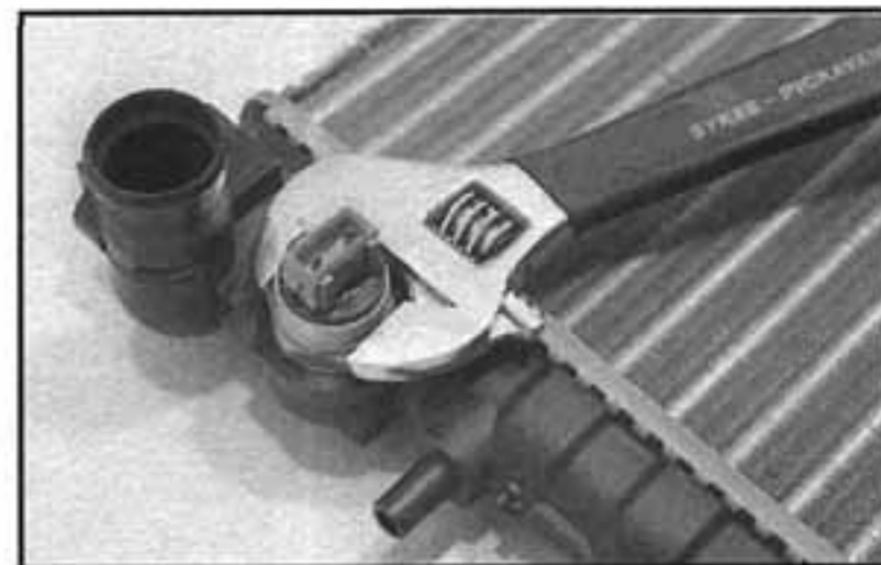
6.16 Opatrně vyšroubujeme spínač (chladič je na obrázku demontován pro lepší přehlednost)
