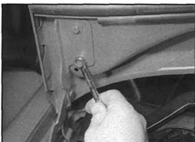
8.3 Vyšroubujeme jeden ze šroubů závěsu kapoty
