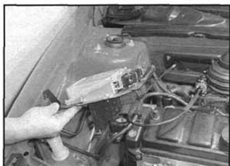
14.26c Uvolníme držák z karoserie a demontujeme ji kompletně s ECU
