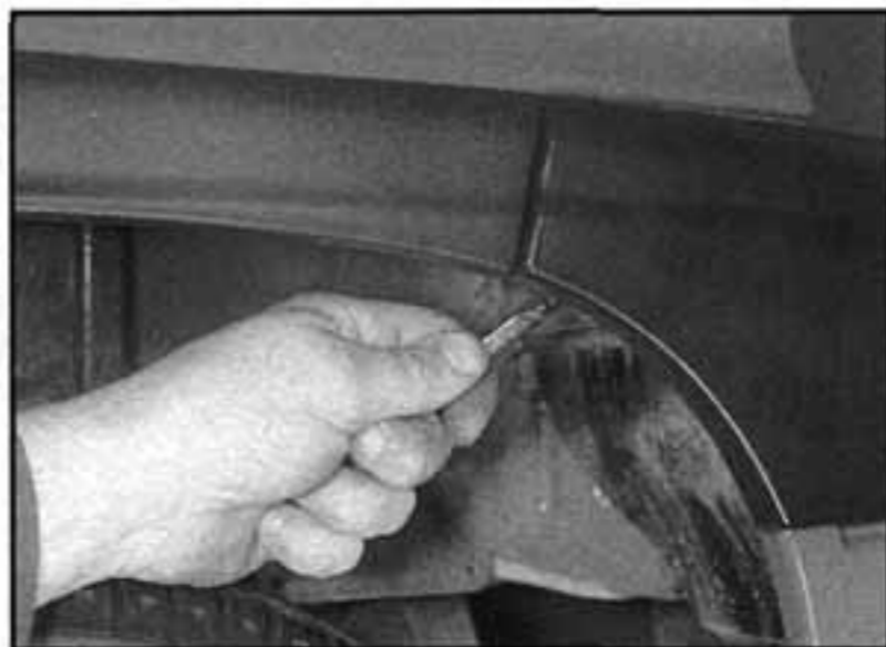
7.7 Demontáž upevňovacího šroubu konce zadního nárazníku
