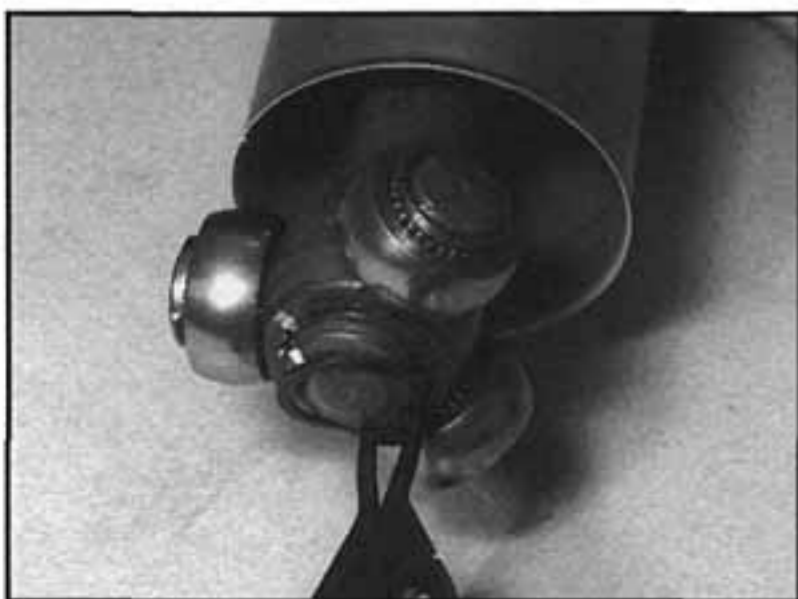
4.16 Demontáž pojistného kroužku vnitřního kloubu
