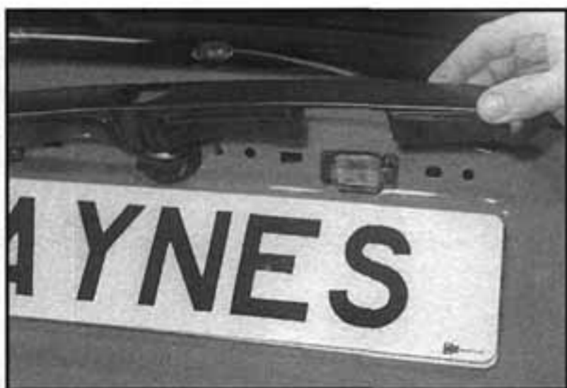
16.10b ...a vytáhneme kryt osvětlení poznávací značky z výklopné zádě
