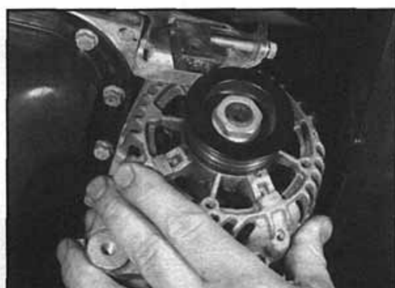
7.4c ...poté sundáme alternátor z jeho upevňovacích vzpěr a vyjmeme ho z motorového prostoru
