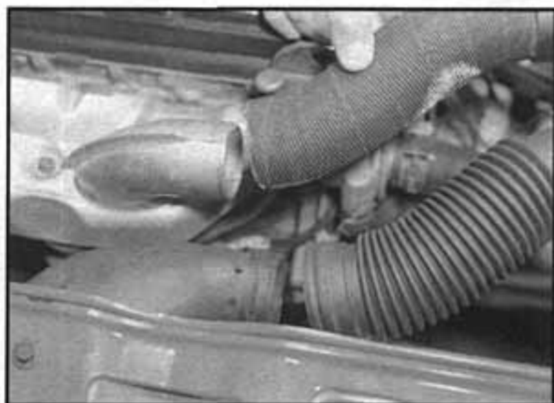
2.1 Odpojíme přívodní hadice teplého a studeného vzduchu
