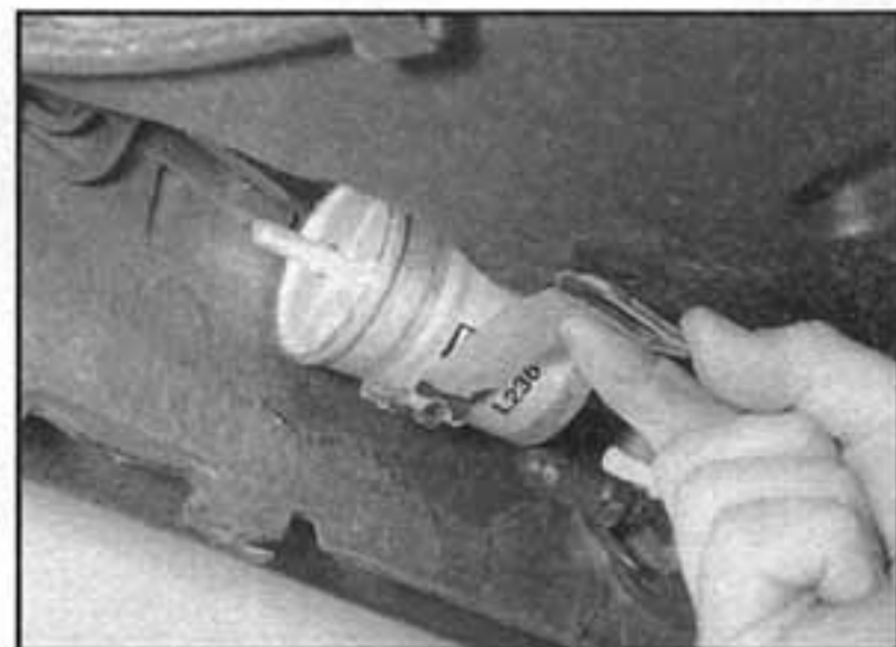
18.8 Připevníme k nádrži upevňovací pás filtru
