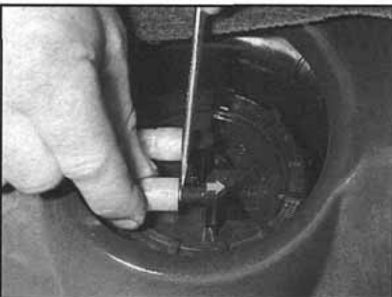
6.5a Pokud jsou použity zacvakávací rychlosvorky, stiskneme jejich kovový středový kroužek a uvolníme je...
