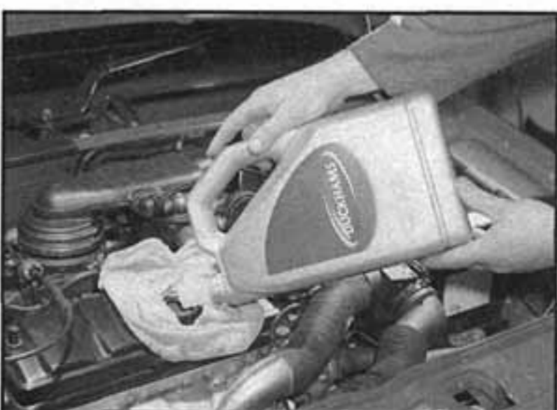
3.11d Nalijeme do motoru nový olej předepsaného typu
