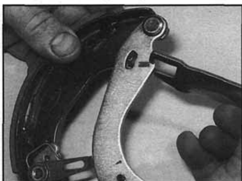
5.10b ...a demontujeme vzpěru seřizovací páky
