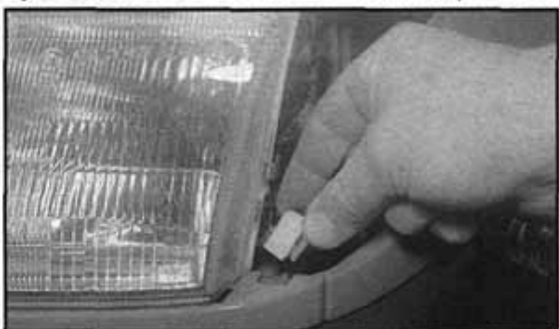
23.2 Demontujeme podkovovitou upevňovací svorku z otvoru směrového světla
