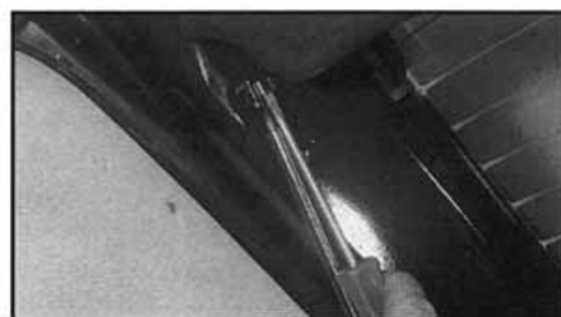
15.15 Vypáčení horní pružné svorky vzpěry výklopné zádě
