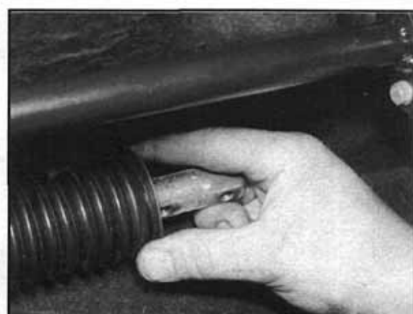
15.4 Stáhneme manžetu z převodky řízení
