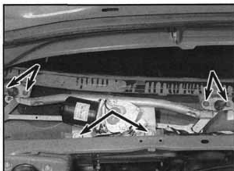
16.8a Demontujeme šrouby sestavy elektromotoru stěračů (viz šipky)...
