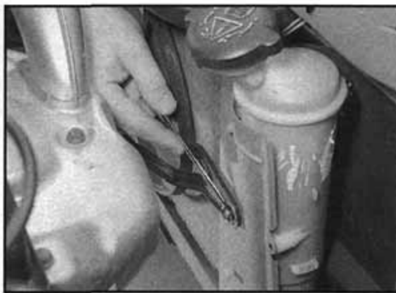
3.8a Uvolníme a vyjmeme upevňovací šrouby...
