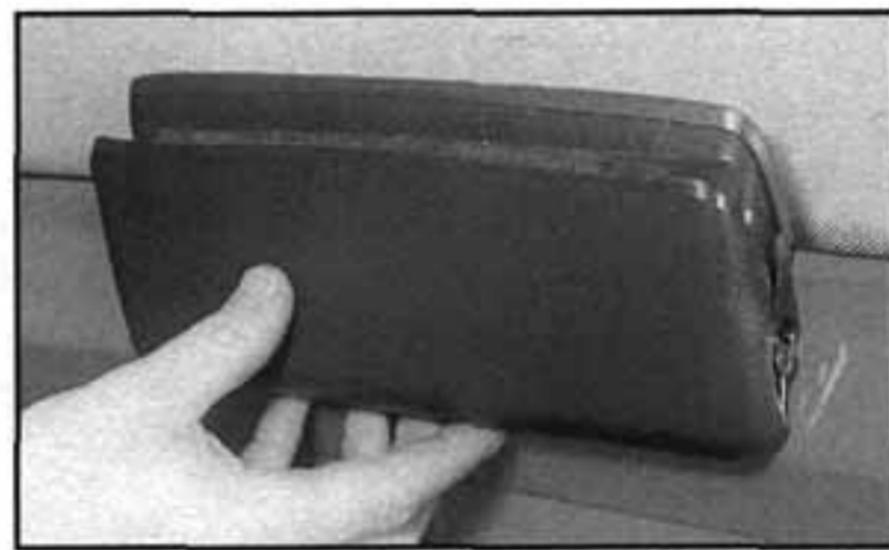
5.38b ...a demontujeme kryt pro přístup k držáku žárovky
