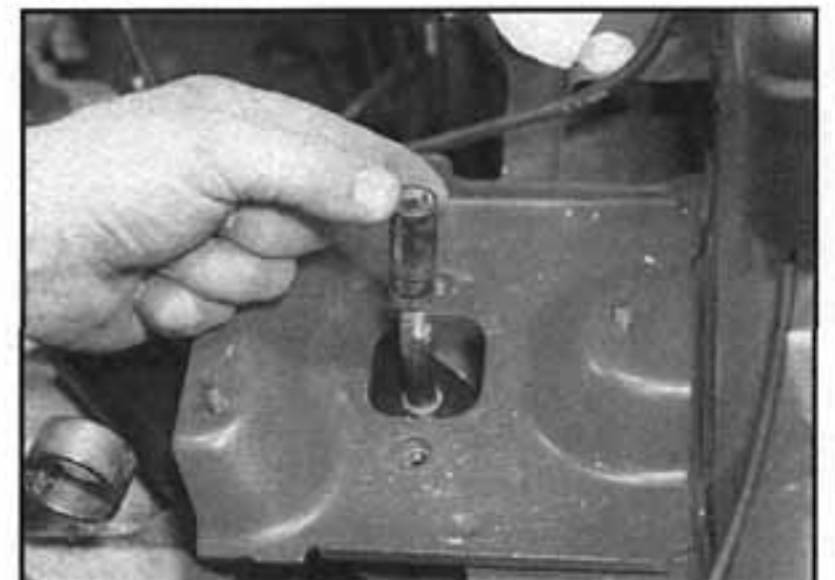
18.15d Stáhneme vymežovací podložku z čepu
