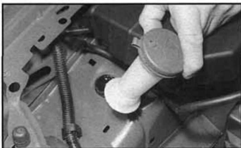
18.2 Můžeme vyšroubovat a demontovat plnicí hrdlo z horní části nádoby
