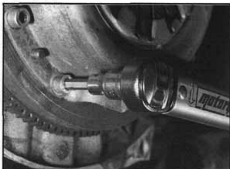
5.18 Utáhneme stejnoměrně šrouby přítlačného kotouče a v příčném uspořádání je utáhneme dle jejich utahovacího momentu
