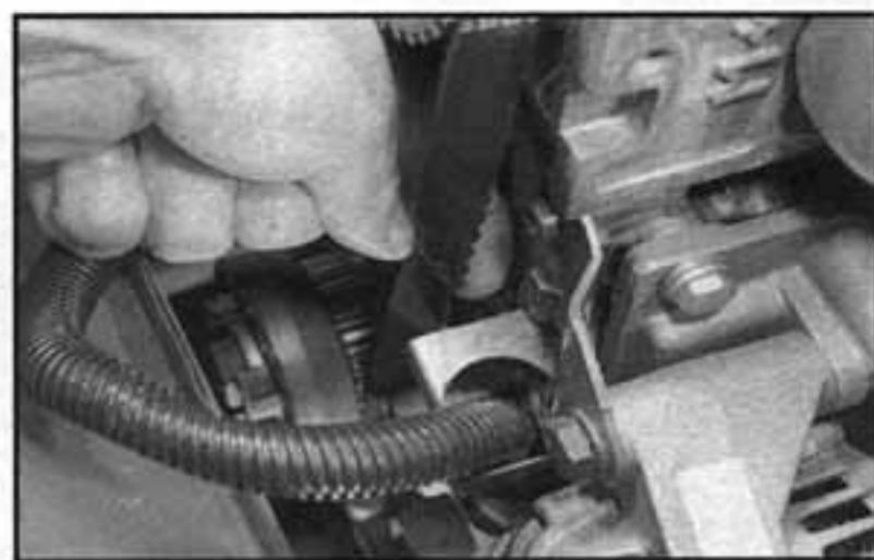
6.15b Pokud je napnutí rozvodového řemenu správné, mělo by být možné otočit jej mezi klikovým a vačkovým hřídelem o 90° nebo promáčknout
