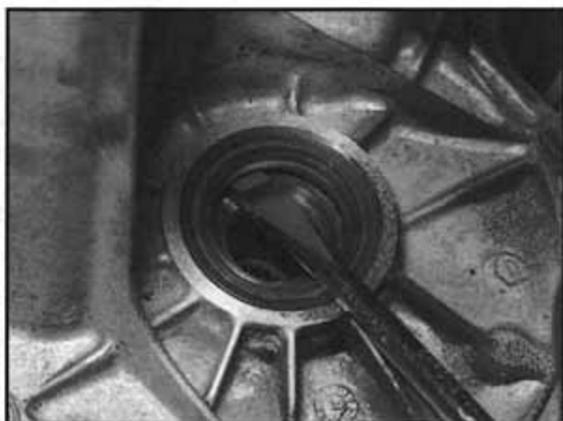
5.4 Opatrně vypáčíme pomocí plochého šroubováku olejové těsnění z převodovky
