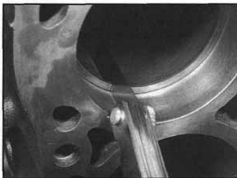
16.5 Měření vůle v zámku pístního kroužku
