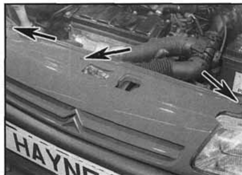
23.4a Upevňovací šrouby mřížky chladiče/rámečku světlometu (viz šipky)
