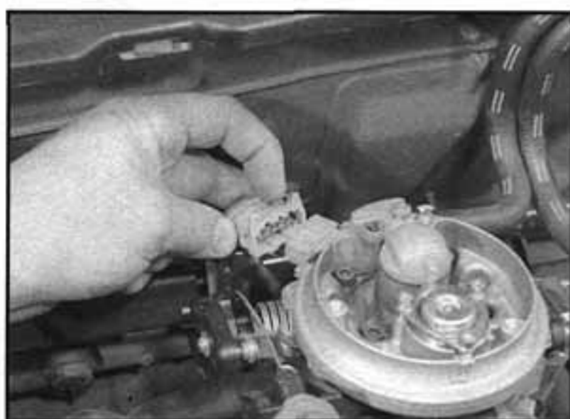
14.3 Odpojíme kabelový svazek od vstřikovací trysky
