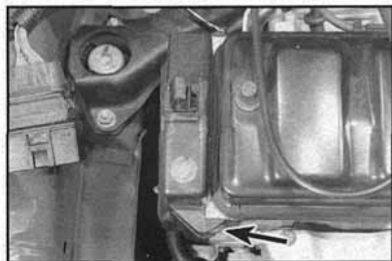
5.1b Uvolníme a demontujeme dva upevňovací šrouby (druhý šroub – viz šipka)...
