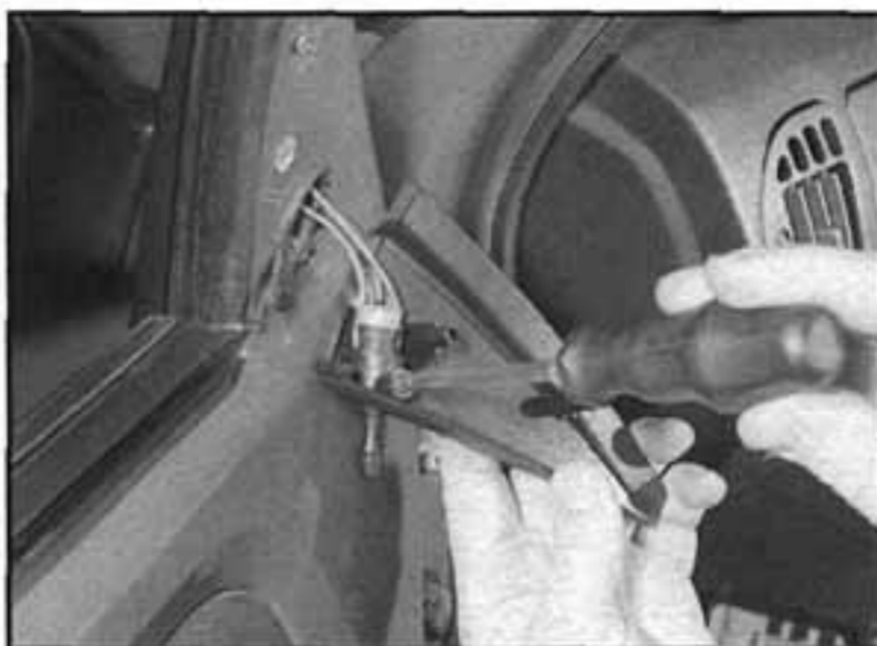
19.2b ...demontujeme upínací šroub nastavovacího knoflíku (na obrázku je manuálně ovládané zrcátko)...
