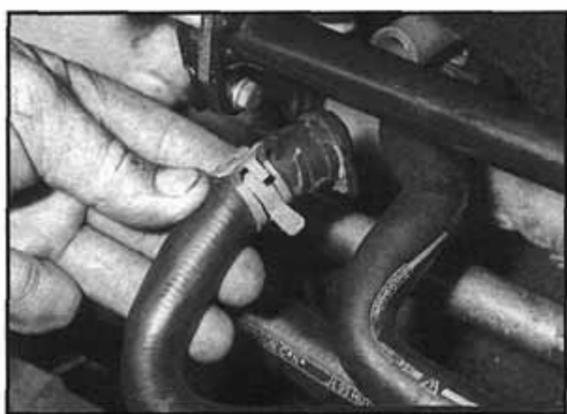
9.13a Odpojíme hadice chladicí soustavy topení od potrubí výměníku tepla na stěně mezi motorovým prostorem a prostorem pro nohy řidiče
