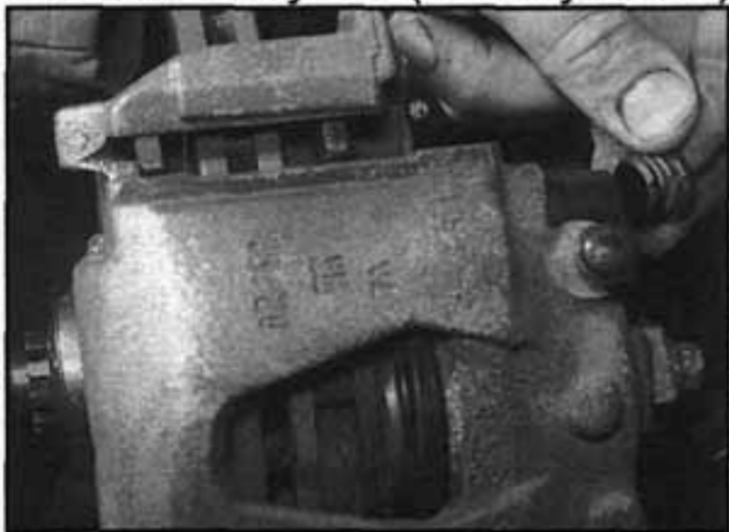
4.31 Demontujeme protiprachové čepičky vodicích čepů...
