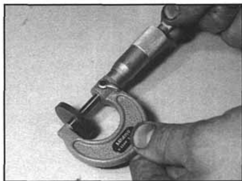
10.15b ...nicméně, distanční podložky by měly být změřeny pro určení jejich správné tloušťky
