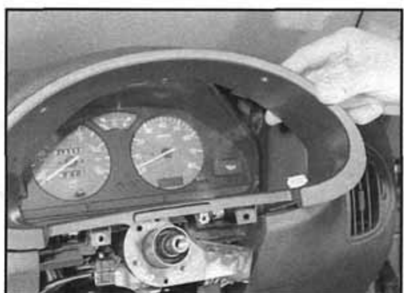
9.4c ...poté vyjmeme rámeček přístrojové desky
