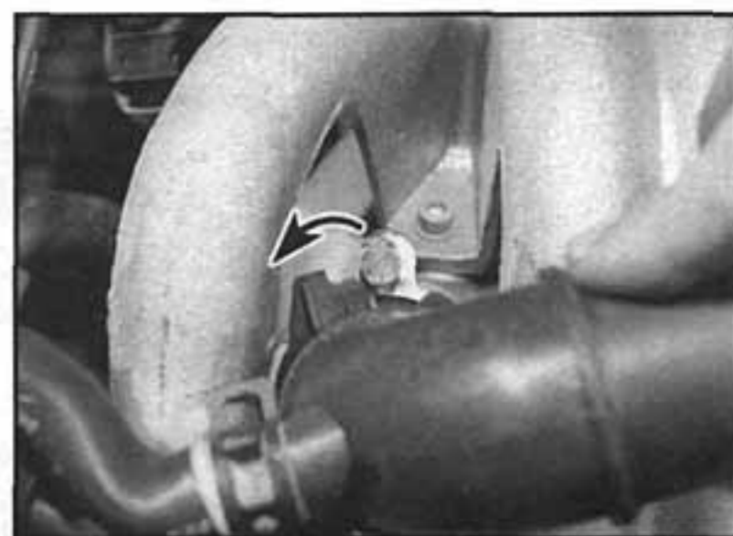
2.3 Uvolníme sací kanál ze vstupního potrubí jeho otočením proti směru pohybu hodinových ručiček
