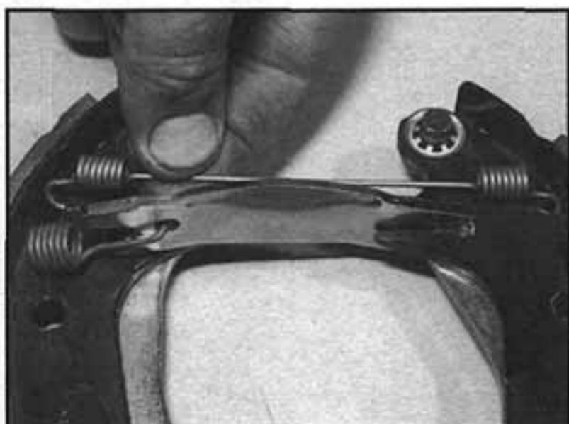
5.15a Namontujeme horní vratnou pružinu k čelistem...
