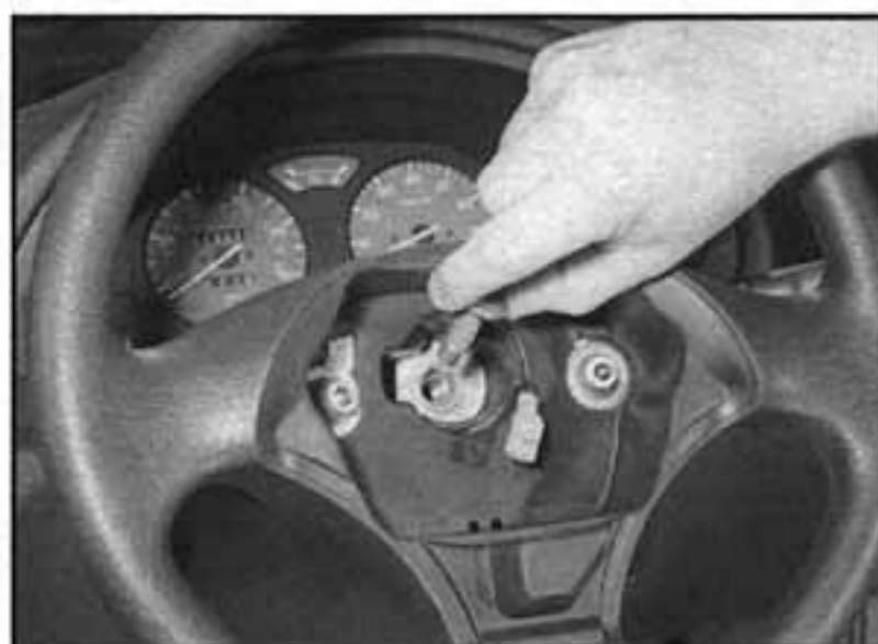
11.5a Po uvolnění středu volantu demontujeme šroub...
