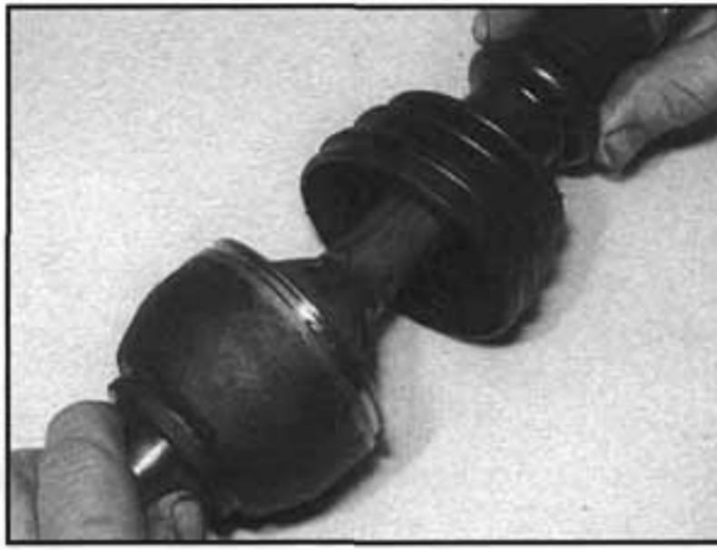
4.7 Nasunutí manžety vnějšího kloubu na hnací hřídel
