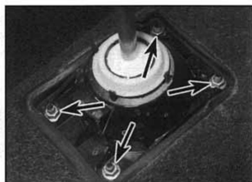
4.6a Upevňovací matice řadicí páky (viz šipky)
