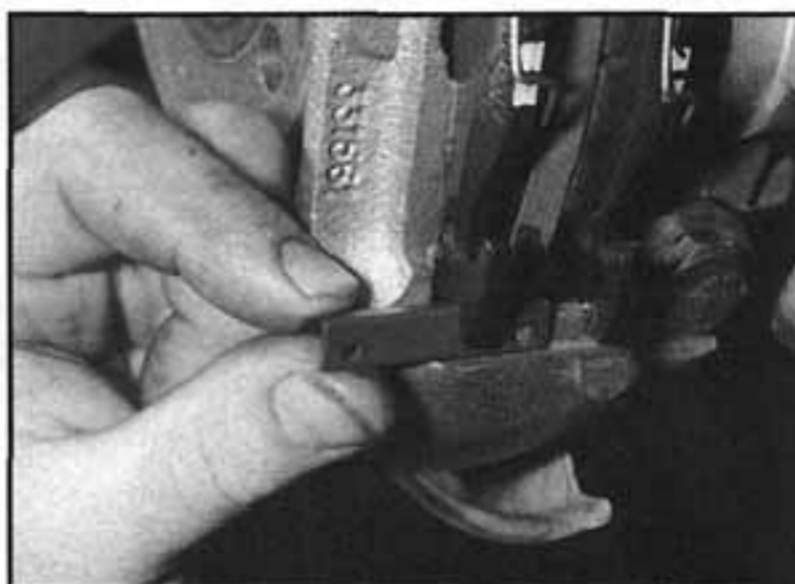
6.2b ...poté stáhneme přídržnou lištu destičky...
