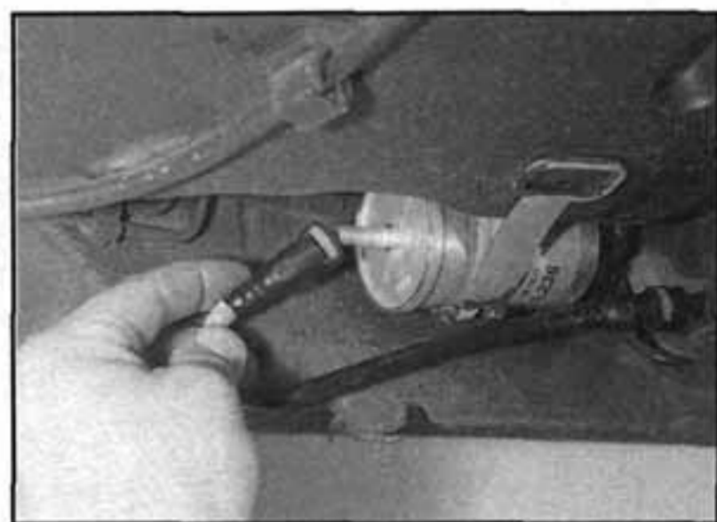
18.4b ...pro uvolnění šroubení palivové hadice
