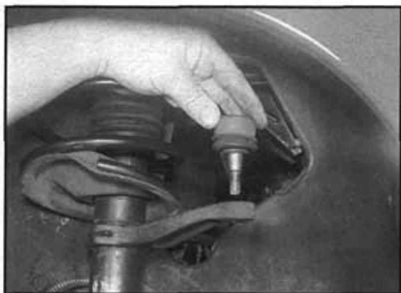
19.2b ...oddělíme konec řídicí tyče od řídicí páky na vzpěře nápravy
