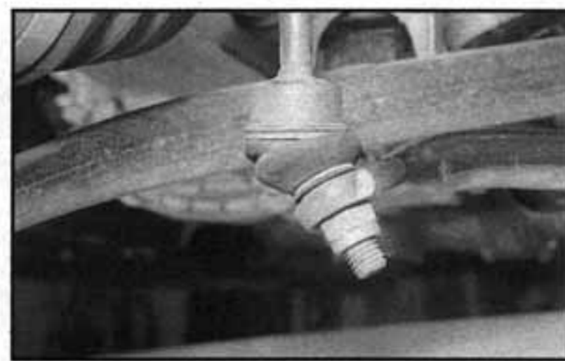
5.16 Kontrola stavu pryžových manžet kulového kloubu závěsného spojení
