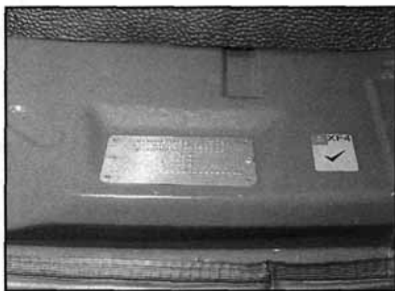
Identifikační číslo vozidla (VIN) je uvedeno na štítku, který je připevněn v zavazadlovém prostoru
