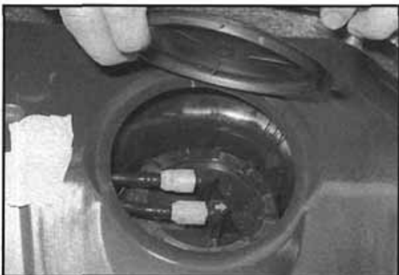
6.4 Demontujeme pravý kryt pro odhalení sacího síta
