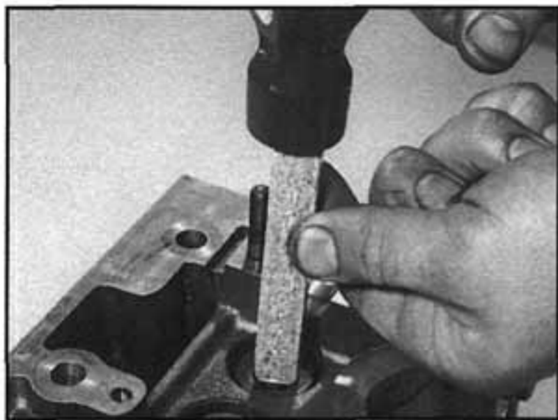
8.5 Demontujeme nástroj pro stlačení spirálových pružin a ťukneme na konec ventilu pro usazení upínacích pouzder
