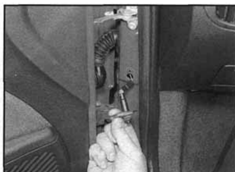
4.19b ...a vyjmeme ho ze sloupku dveří pro lepší přístup ke kabeláži
