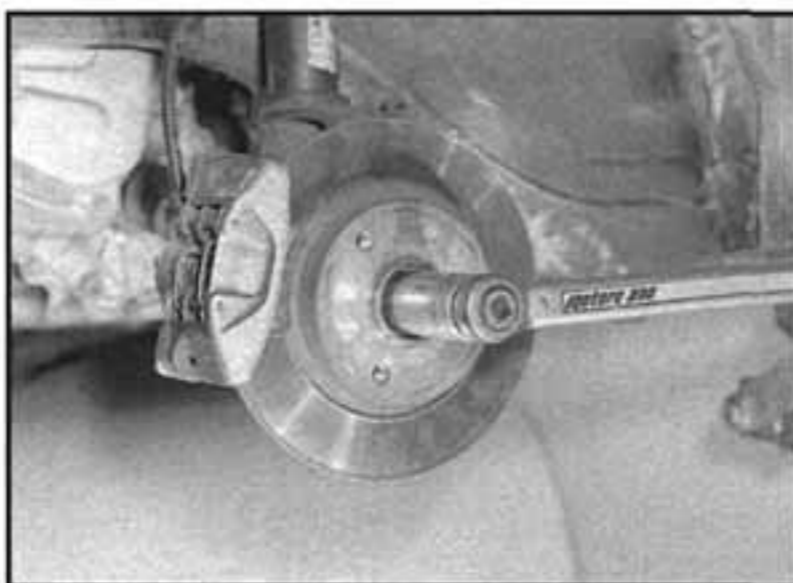
2.23 Utáhneme novou matici hnacího hřídele dle jejího patřičného utahovacího momentu
