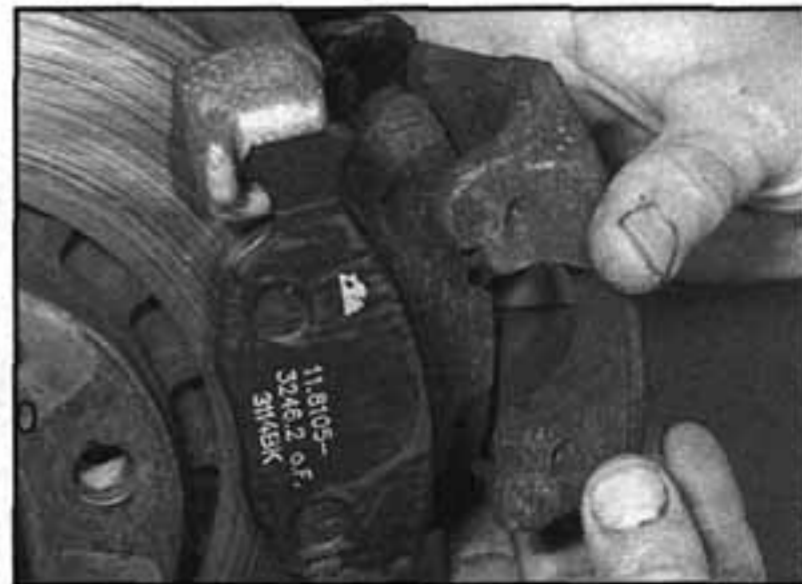
4.32b ...a stáhneme třmen a sestavu vnitřní brzdové destičky - třmen kotoučové brzdy ATE (chlazený kotouč)
