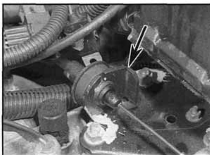
3.2b ...a uvolníme vnější táhlo z konzoly převodovky (viz šipka)
