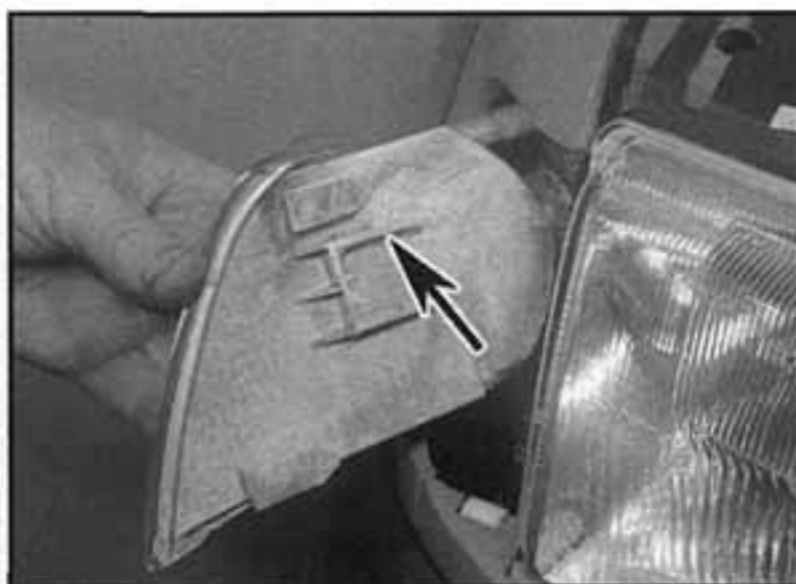
5.14 ...kterou můžeme lépe vidět po demontáži jednotky (viz šipka)
