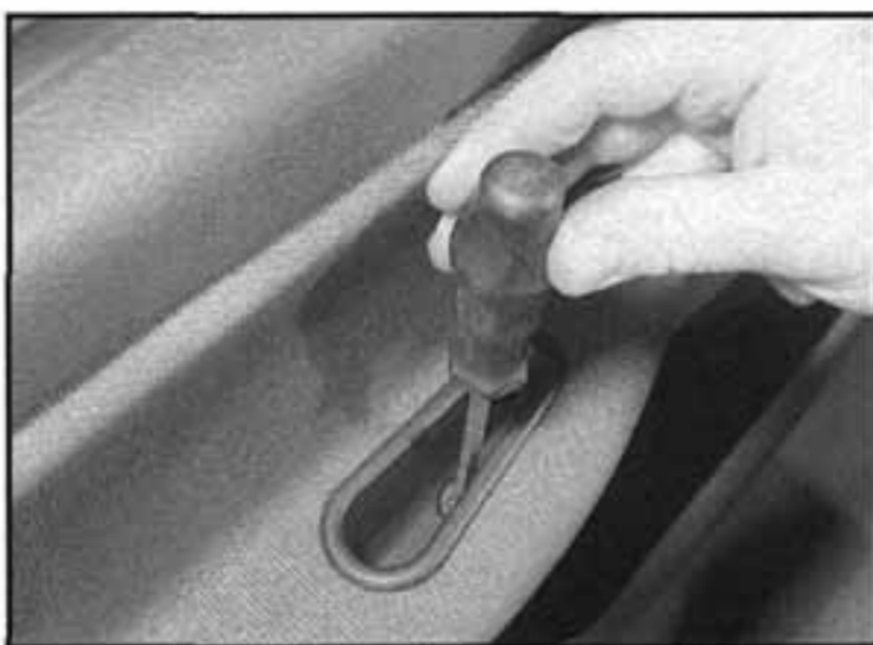
12.5a Demontujeme šroub uvnitř madla dveří...
