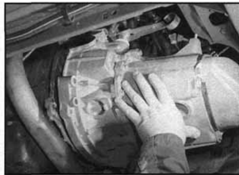
8.21 Vyjmeme převodovku z motoru
