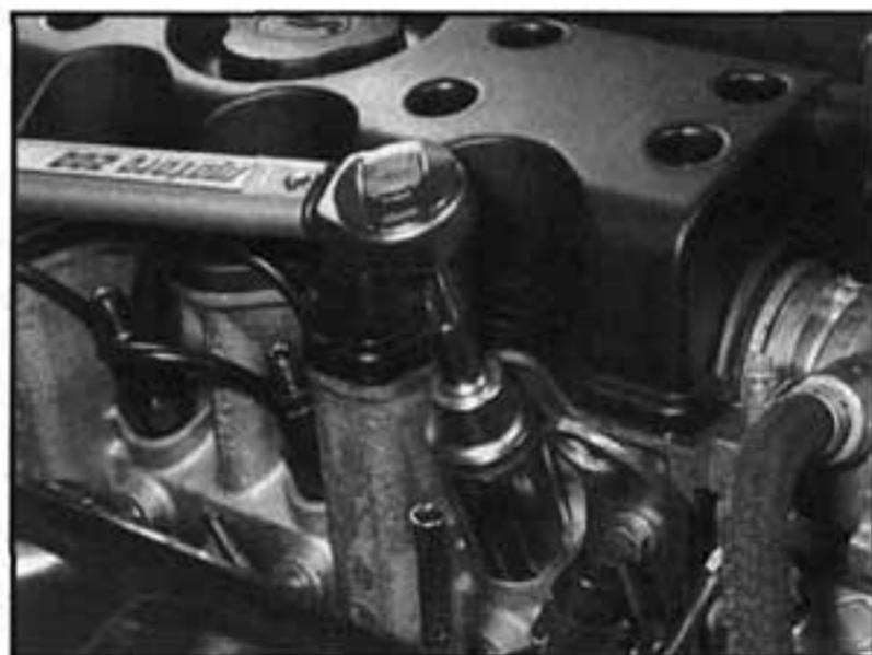
15.9 Namontujeme vstřikovací ventil a utáhneme ho dle jeho patřičného utahovacího momentu
