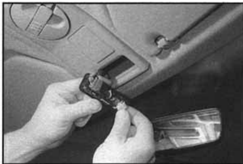
6.2b ...poté vytočíme držák a demontujeme žárovku
