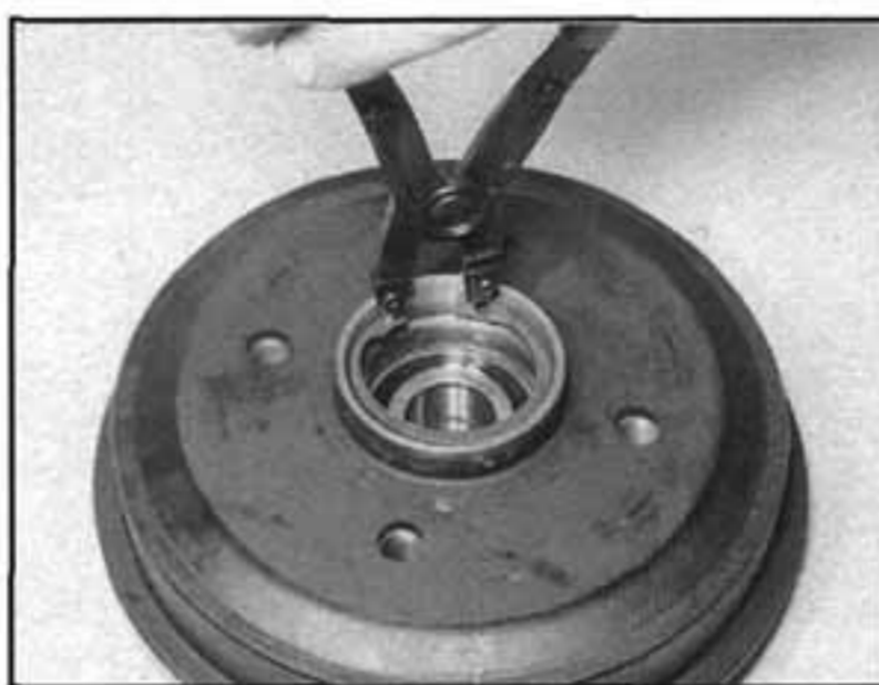
7.2 Vytáhneme pojistný kroužek ložiska zadního kola
