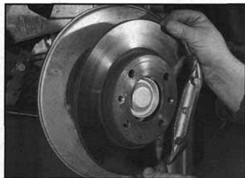
9.4 Demontáž zadního brzdového kotouče
