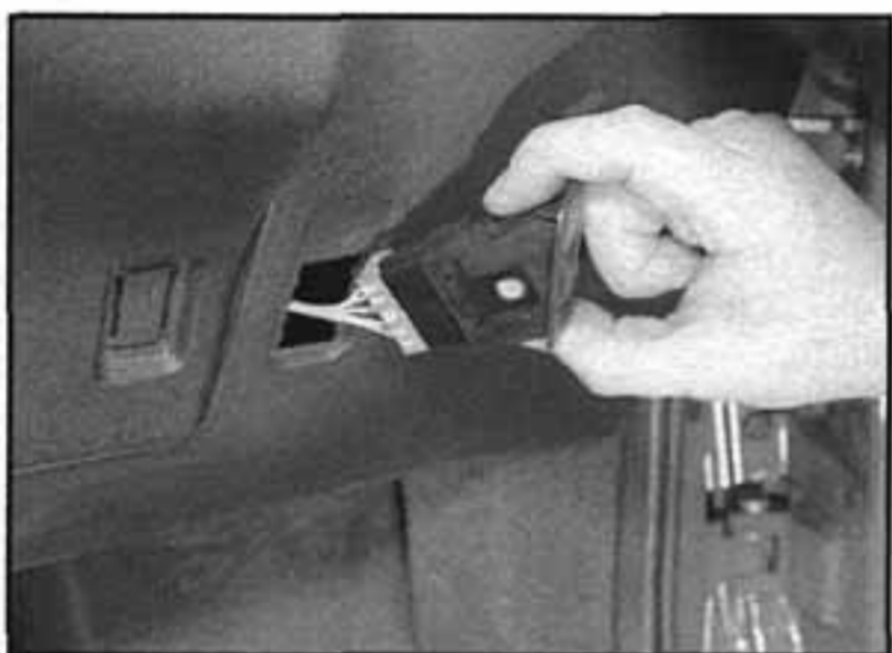
4.17b ...poté ho vyjmeme v přístrojové desce a odpojíme kabeláž
