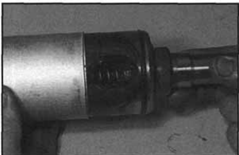
4.26a Umístíme vnější díl na hvězdici kloubu...
