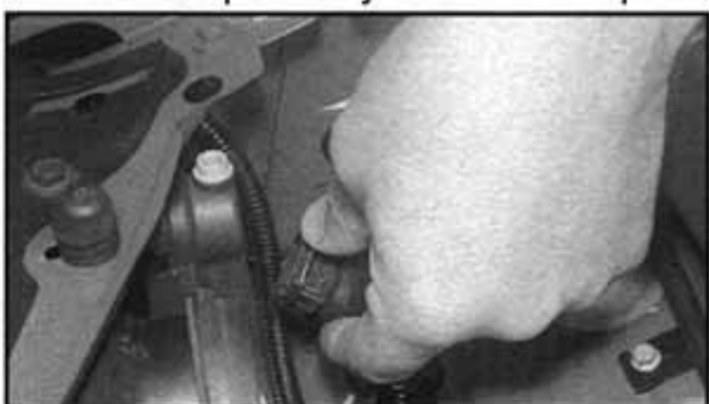
7.2 Odpojení konektoru kabeláže motoru seřízení světlometu
