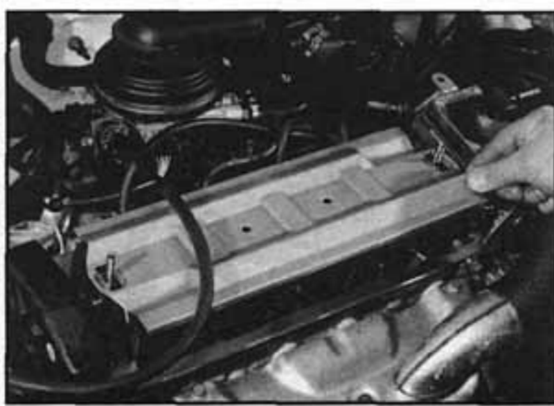
4.6b ...a sejmeme usměrňovací plech
