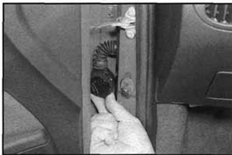
11.1 Otočením objímky odpojíme konektor kabelového svazku dveří
