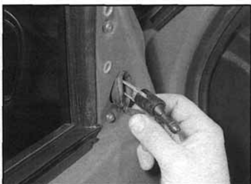
19.2d ...a vytáhneme průchodku nastavovače
