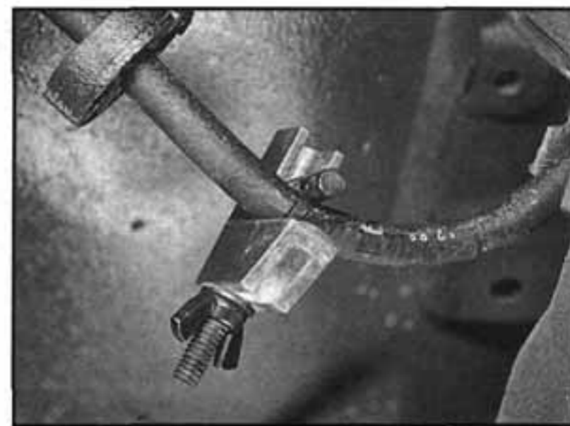
11.3 Pro minimalizování ztráty kapaliny namontujeme hadicovou svorku
