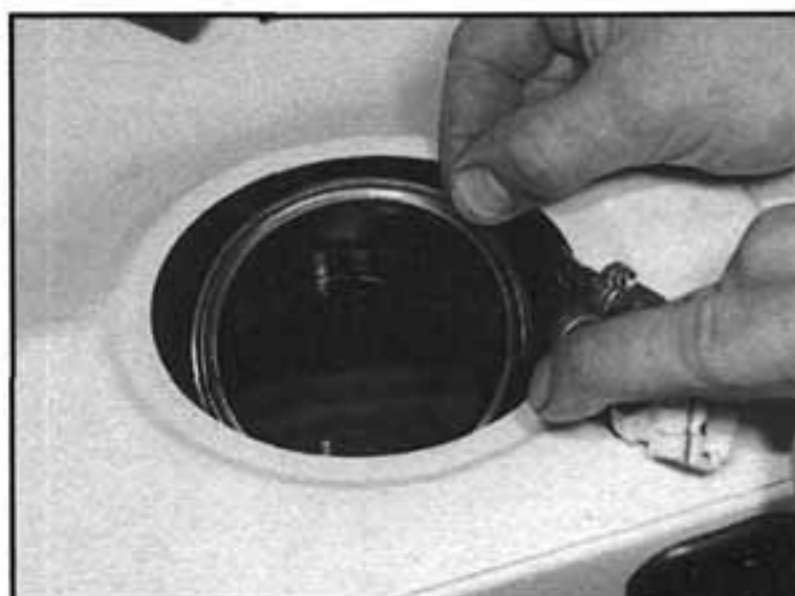
9.7b ...a sejme gumový těsnicí kroužek
