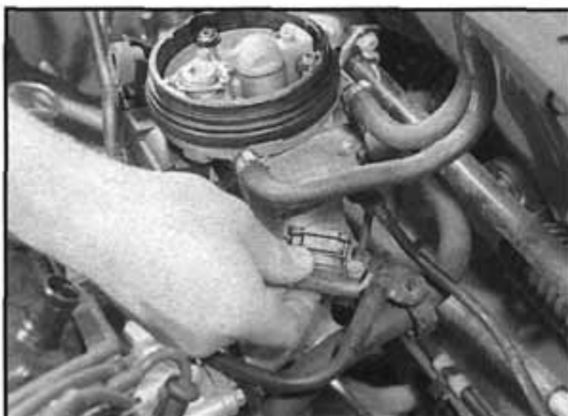
14.17 Odpojíme kabeláž od potenciometru škrticí klapky
