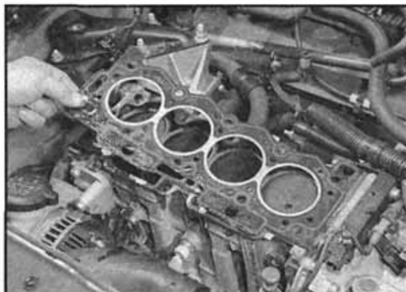
12.20 Sejme těsnění z horní části bloku motoru
