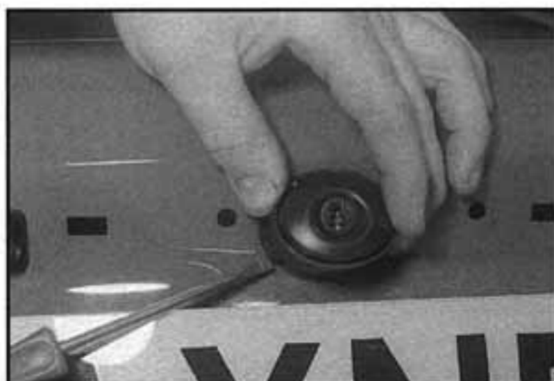
16.11 Stiskneme příchytky válcové vložky zámku...
