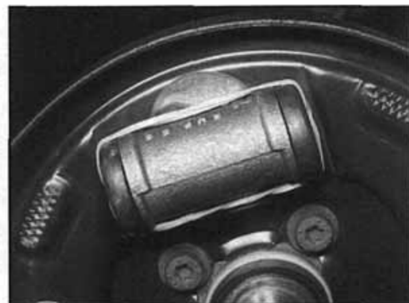
5.8 Gumový pás umístěný přes brzdový váleček kola
