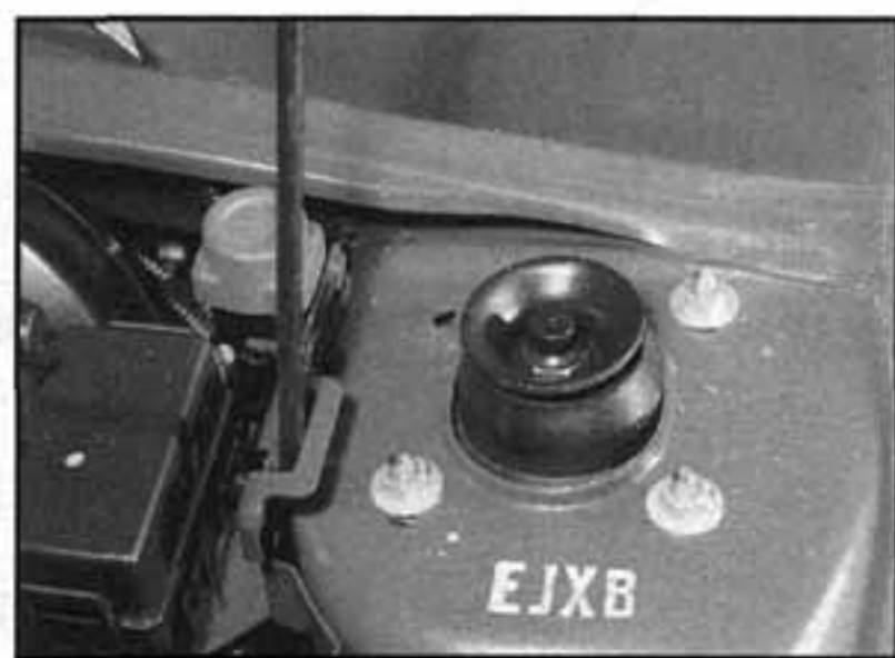
3.6 Montážní matice vzpěry nápravy (na obrázku je model s posilovačem řízení)
