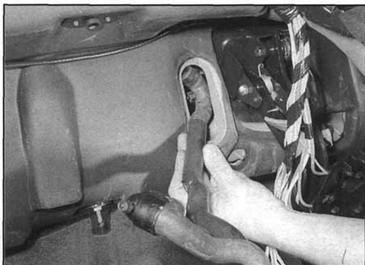
9.13c ...a protáhneme hadice přes otvor stěny mezi motorovým prostorem a prostorem pro nohy řidiče
