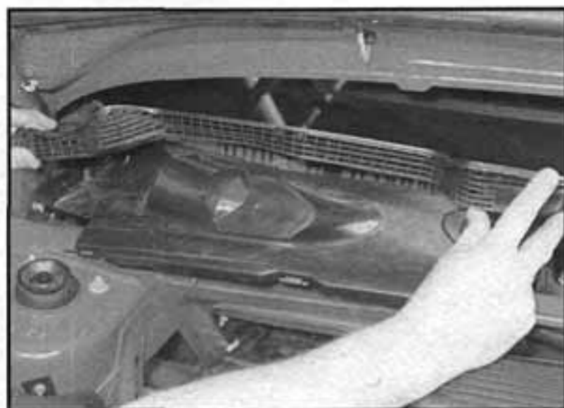
16.4c ...poté uvolníme a demontujeme plechový kryt mezi čelním oknem a víkem motorového prostoru
