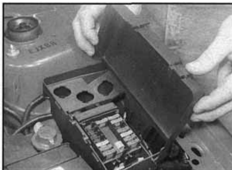
3.4 Demontáž krytu pojistkové skříňky pro lepší přístup k pojistkám v motorovém prostoru
