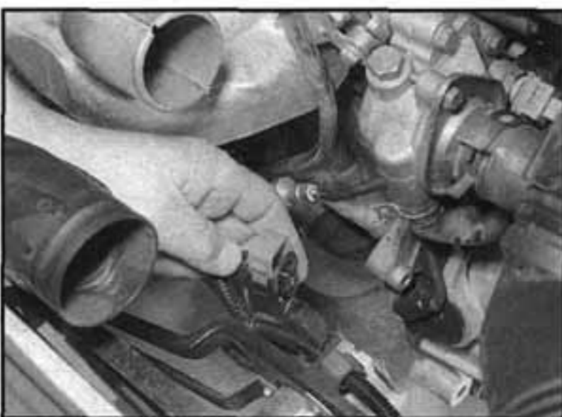
5.5b ...a odpojíme konektor kabeláže z ventilátoru
