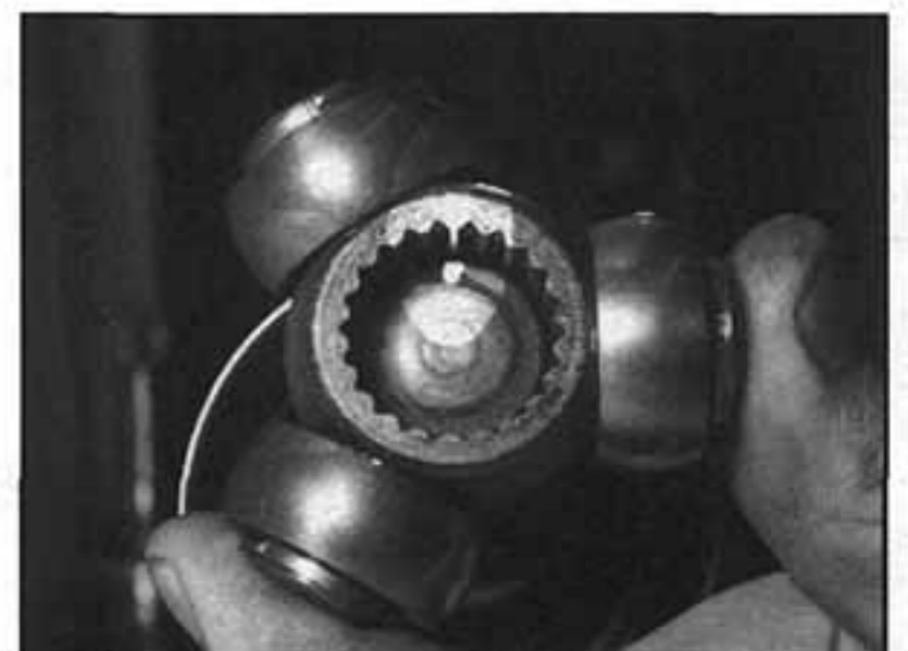
4.17b Vyjmutí vnitřního kloubu. Dáváme pozor na seřizovací značky
