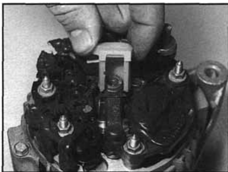
8.5 Vytáhneme umělohmotný kryt pro odkrytí hřídele motoru
