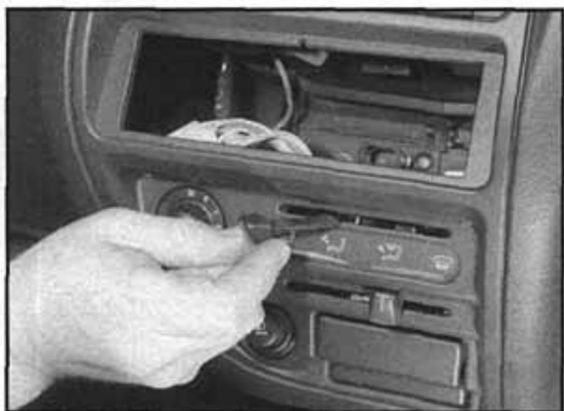
9.3 Opatrně vypáčíme dva umělohmotné knoflíky z posuvného ovládání topení
