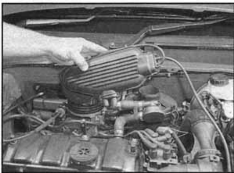
19.2b ...poté nadzvedneme potrubí z tělesa škrticí klapky a pouzdra vzduchového filtru
