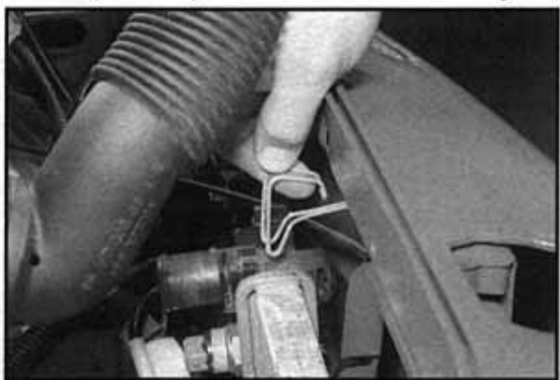
3.9 Uvolníme dvě upevňovací pružné svorky chladiče
