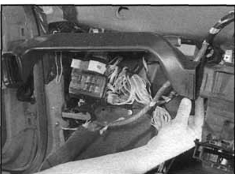
9.11 Odpojíme vzduchové potrubí z každé strany sestavy topení
