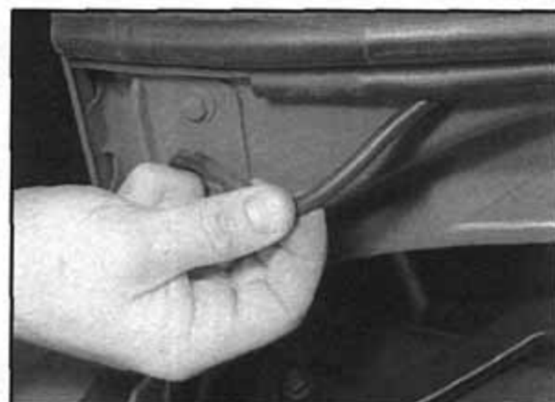
8.2c ...uvolníme hadičku z gumového těsnění...
