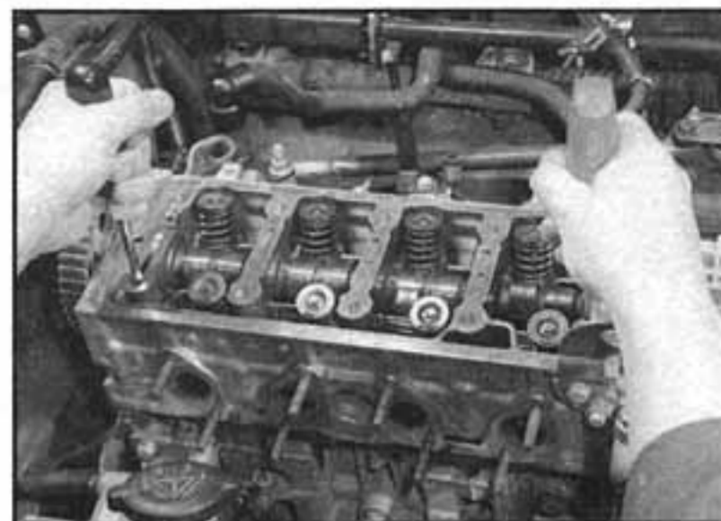
12.19a Namontujeme dva silné šroubováky do otvorů pro šrouby hlavy válců a zlehka hlavu válců nakloníme pro uvolnění z bloku válců
