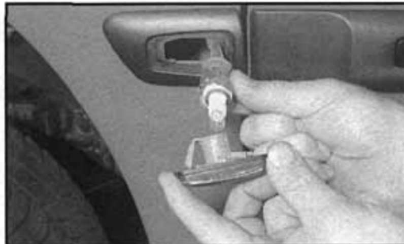
5.22a Demontujeme držák žárovky bočního ukazatele...
