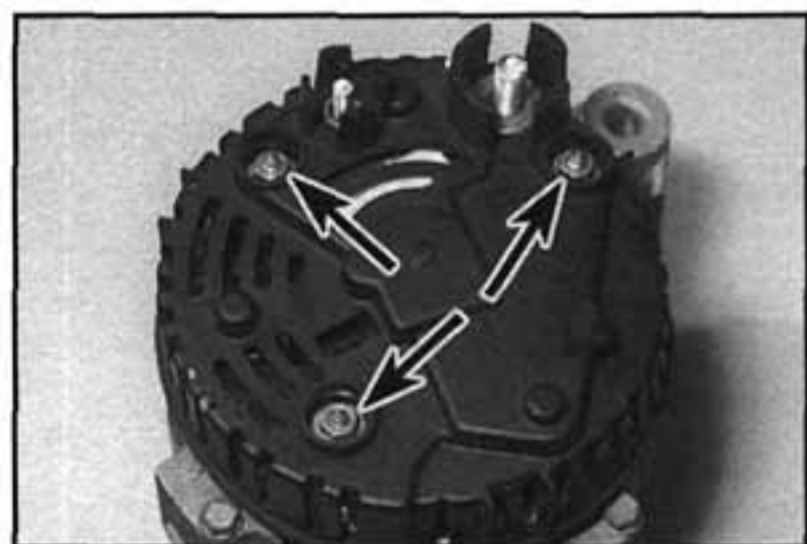
8.3a U alternátoru Valéo uvolníme upevňovací matice (viz šipky)...
