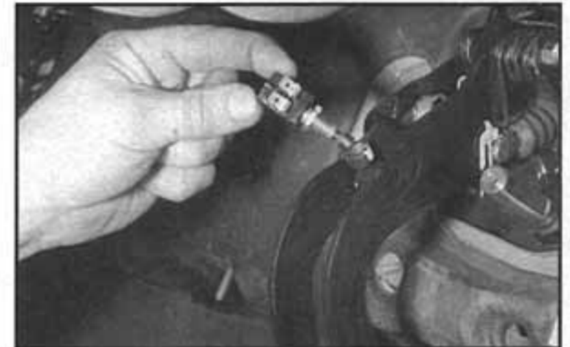
21.7b ...a vyjmeme spínač z horní části brzdového pedálu
