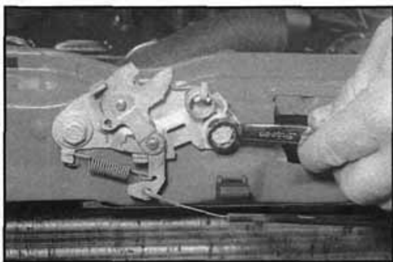
10.2 Vyšroubujeme upevňovací šrouby zámku kapoty
