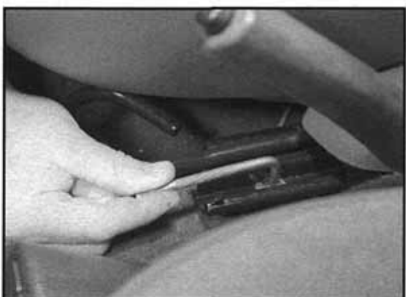
24.6 Demontáž vnitřního šroubu přední vodící lišty sedadla
