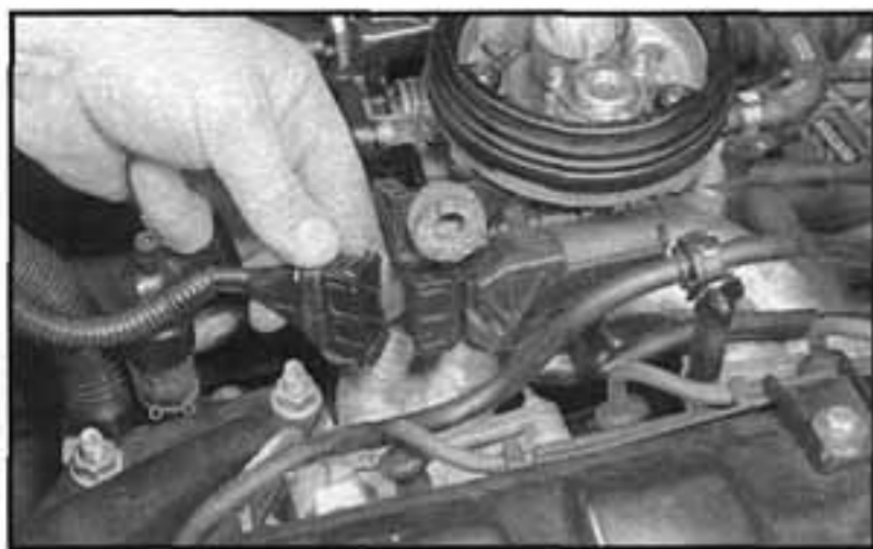
14.14 Odpojíme konektor kabeláže od krokového elektromotoru regulátoru volnoběhu
