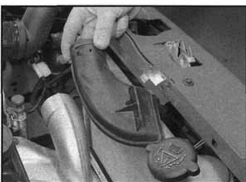
3.10b Demontáž potrubí přívodu vzduchu z předního čela karoserie
