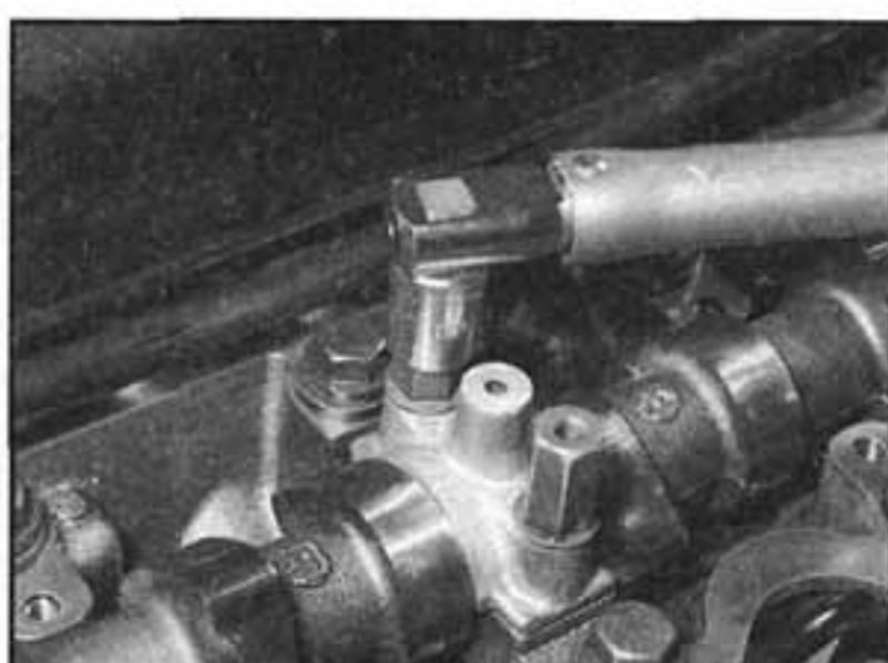
9.15b ...utáhneme je rovnoměrně a postupně dle jejich patřičného utahovacího momentu
