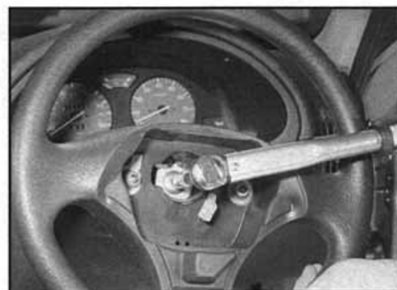
11.6 Utáhneme šroub volantu dle jeho patřičného utahovacího momentu
