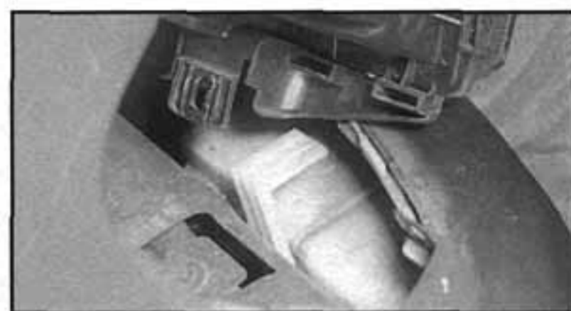
7.5 Ukázka upevňovací svorky světlometu ve tvaru L a drážky na spodní straně světlometu, ve které je svorka uchycena
