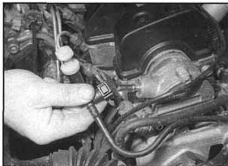
25.4 Odpojíme podtlakovou hadici, a to uvolněním spojení se západkou
