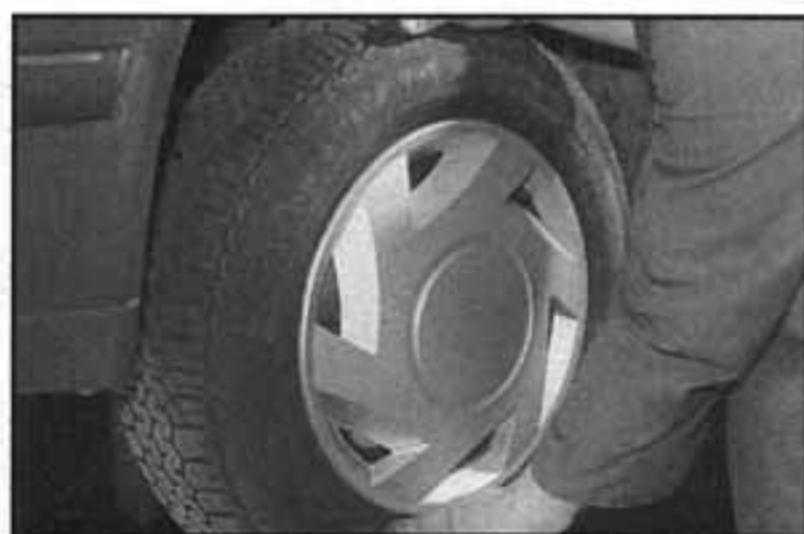
8.4 Uchopíme kolo, zavikláme jím a zkontrolujeme tak stav jeho ložisek
