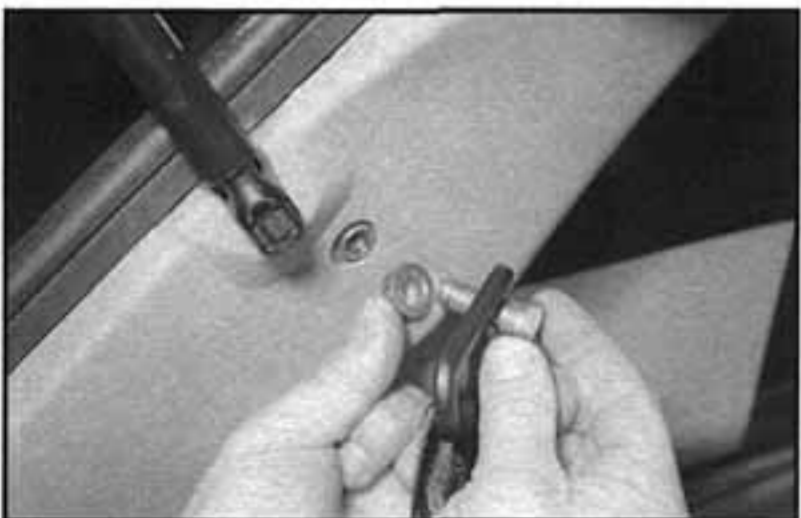
25.21b ...poté demontujeme horní upevňovací šroub zadního bezpečnostního pásu, a to společně s montážní deskou a vymežovací podložkou
