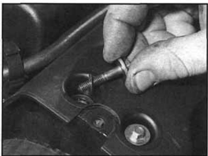
4.3 Vyšroubujeme osm upevňovacích šroubů a demontujeme je s jejich podložkami
