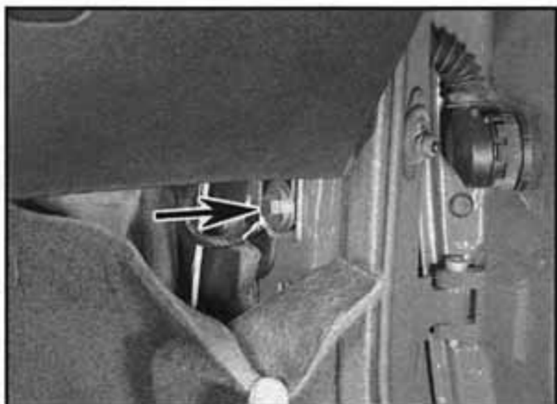
28.11a Demontujeme šroub (viz šipka) z každého spodního předního rohu panelu přístrojové desky...
