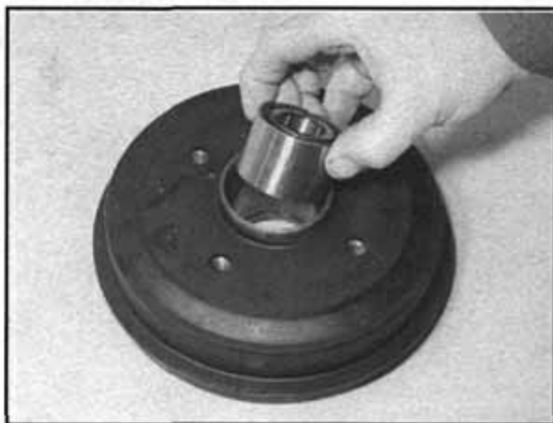
7.9a Usadíme ložisko do náboje...
