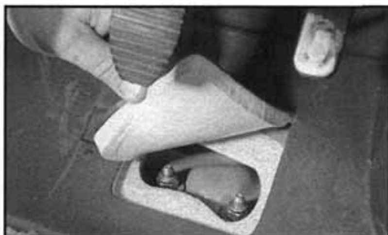
4.5 Zadní matice spodního ramene najdeme, pokud vyzvedneme pěnovou podlášku
