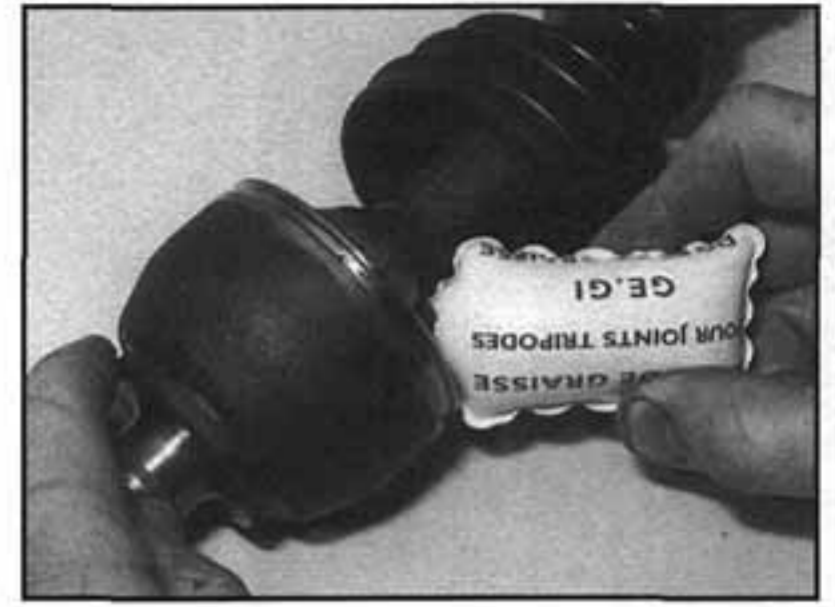
4.8 Naplníme kloub vazelínou, která je dodána v sadě náhradních dílů
