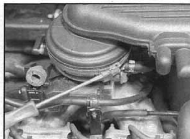
2.3 Uvolníme upevňovací svorky, poté vyzvedneme boční potrubí z horní části skříně škrticí klapky a tělesa vzduchového filtru
