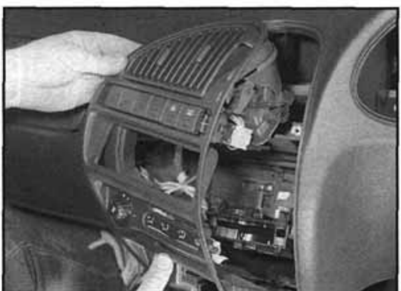
9.7b Vyjmeme ovládací panel z přístrojové desky
