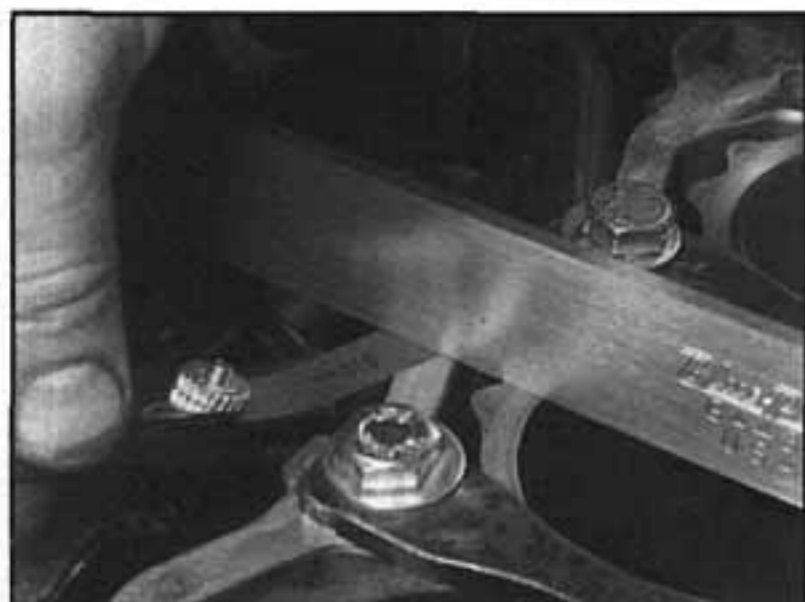
11.26 Kontrola výstupku vložky válce – hliníkový blok motoru
