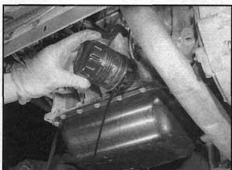
3.7b ...poté vyšroubujeme filtr rukou z vozidla
