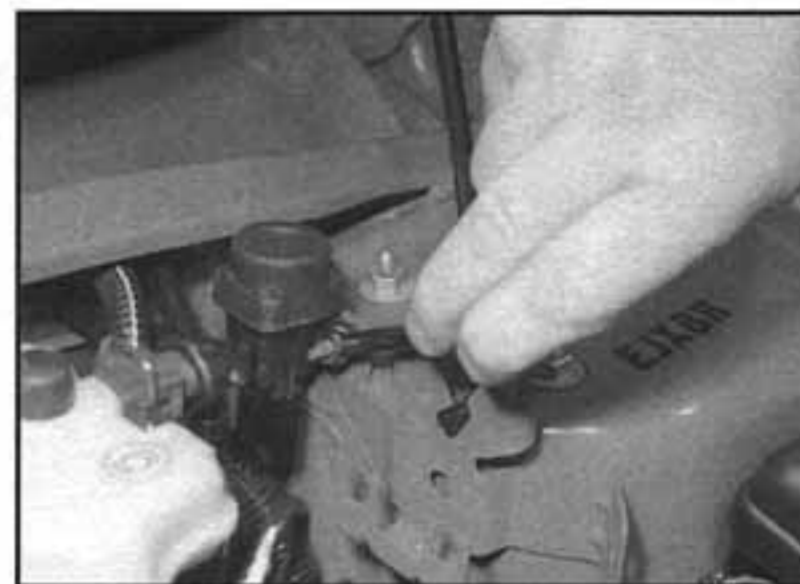
16.6 Vyšroubujeme 2 upevňovací matice a demontujeme pohybový snímač
