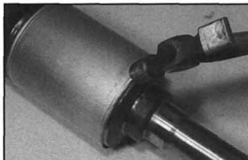
4.26c ...a zajistíme vnější díl kloubu rozklepáním krytu okolo hrany
