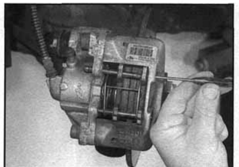
4.21a Uvolníme upevňovací čepy brzdové destičky z třmenu pomocí důlčiku
