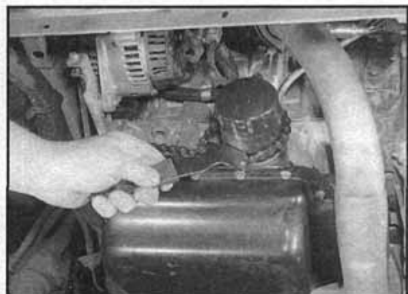
3.7a Uvolníme olejový filtr pomocí demontážního nástroje
