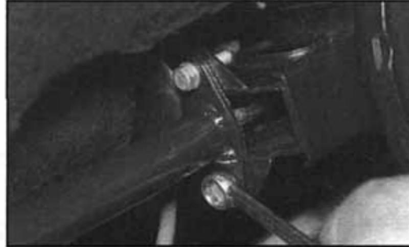
16.13 Vyšroubujeme upevňovací šroub příčných táhel
