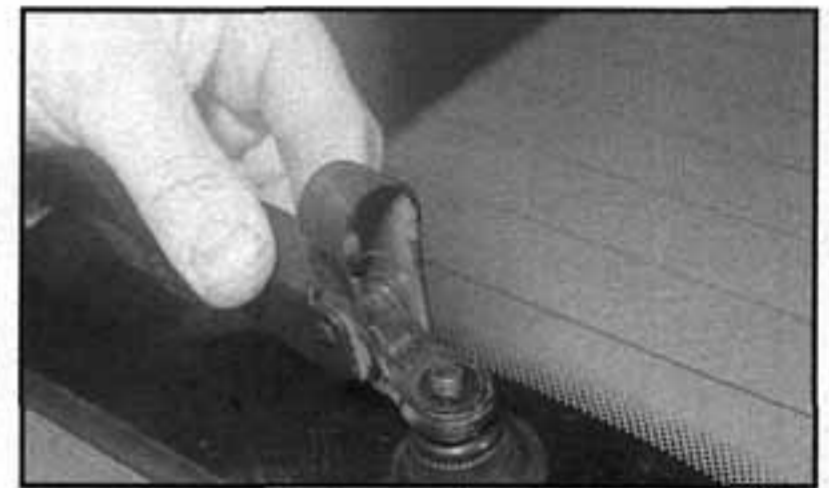
15.3c Demontáž raménka stěrače výklopné zádě
