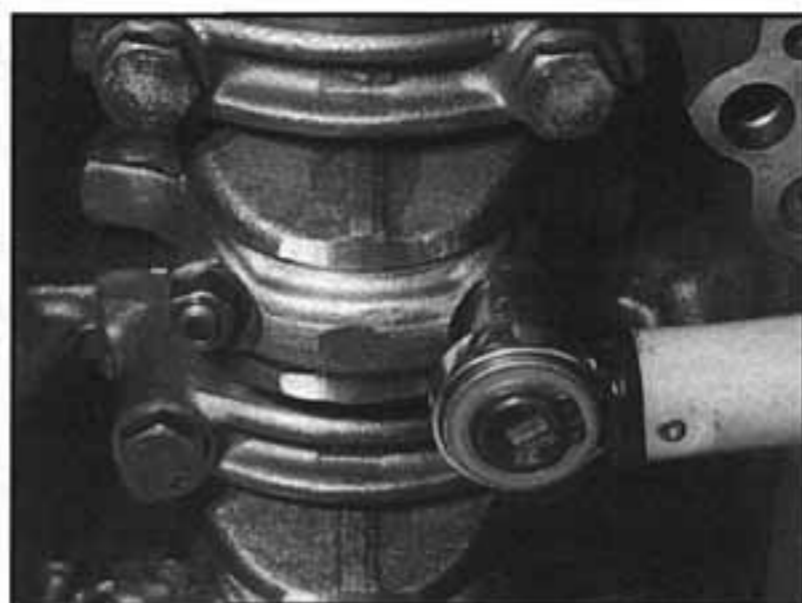
18.20 Utáhneme matice víka ojničního ložiska dle jejich patřičného utahovacího momentu
