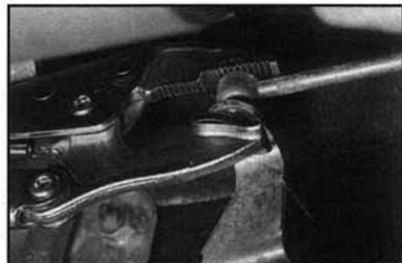
4.8 Ujistíme se, že jsou řadicí táhla bezpečně zamáčknuta do jejich kulových čepů
