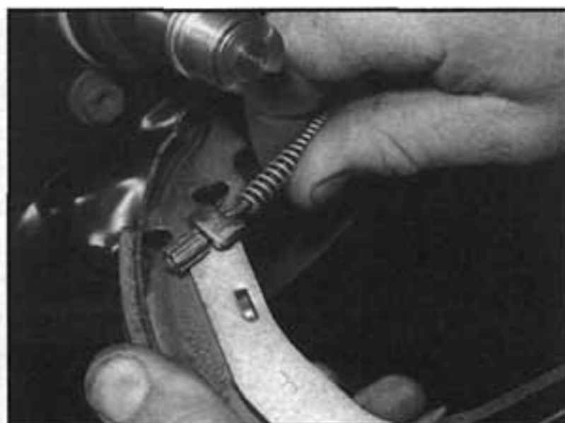
5.7 Vyhákneme táhlo ruční brzdy z páky na úběžné brzdové čelisti
