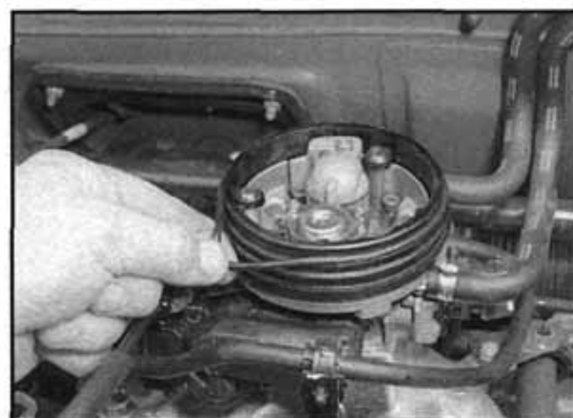
12.9 Případně namontujeme nový těsnicí O-kroužek na potrubí vzduchového filtru
