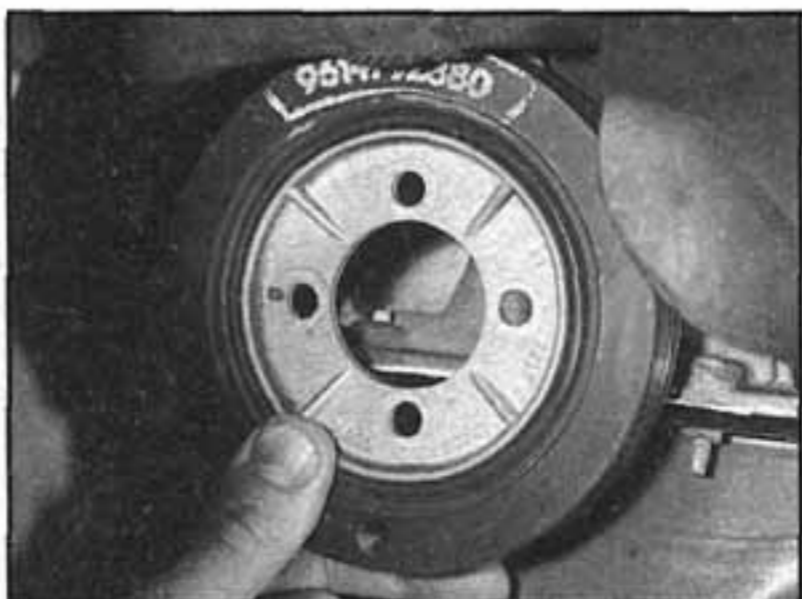
5.9b ...a demontujeme řemenici klikového hřídele z motoru
