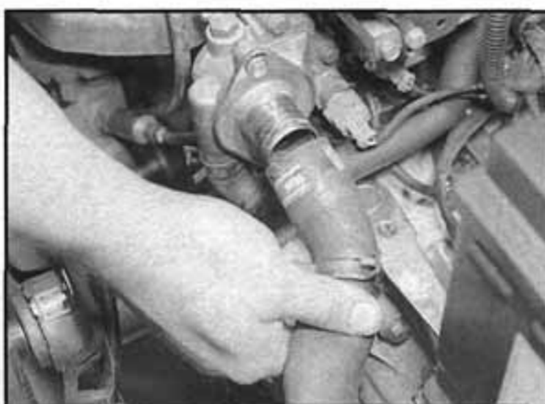
4.3b ...a odpojíme všechny hadice chladičové soustavy od tělesa termostatu
