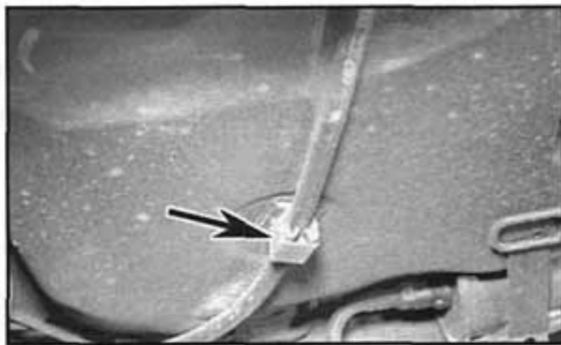
19.7 Typická upevňovací svorka táhla ruční brzdy (viz šipka)
