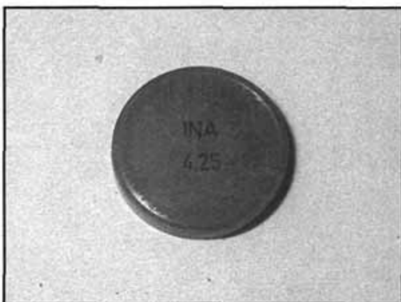
10.15a Tloušťka distanční podložky je vylisovaná na spodní ploše podložky...
