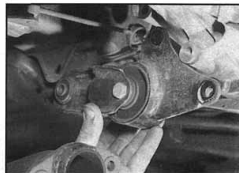
18.24 Vyšroubujeme zadní montážní článek z držáku na karoserii
