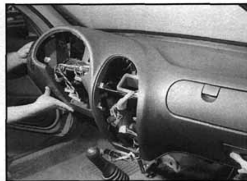
28.14 Demontáž panelu přístrojové desky
