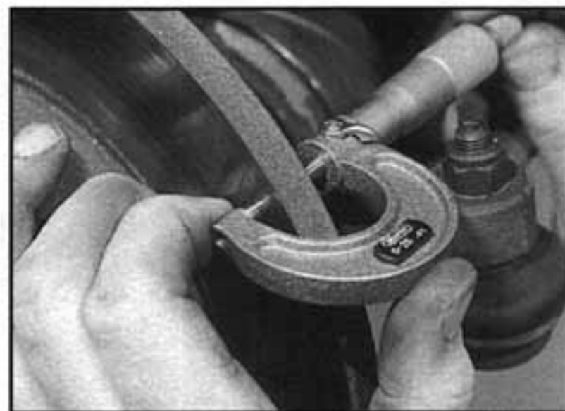
7.3 Použijeme mikrometr a změříme tloušťku kotouče
