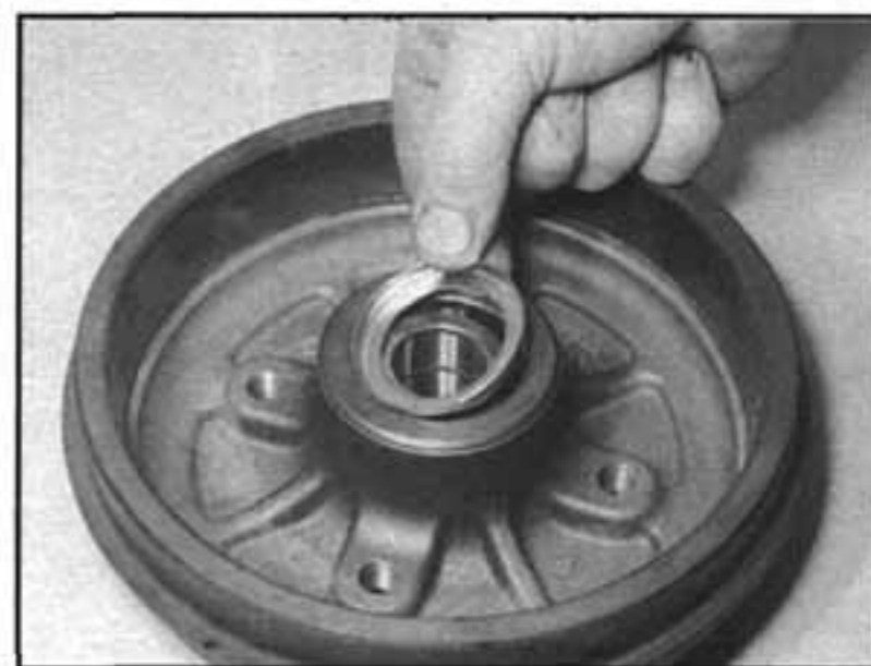
7.11a Nasadíme nový olejový těsnicí kroužek...
