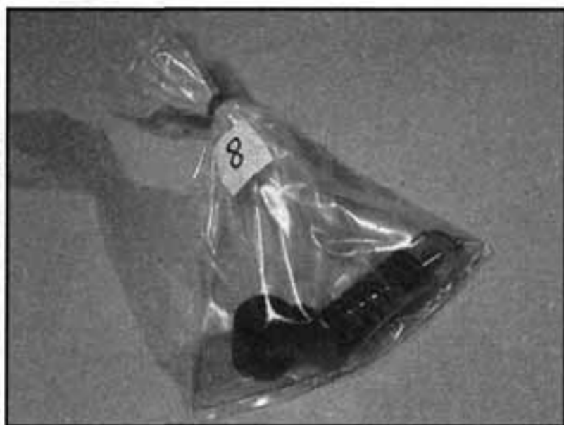
6.7 Uložte každý ventil a jeho příslušné součásti do polyethylenového sáčku
