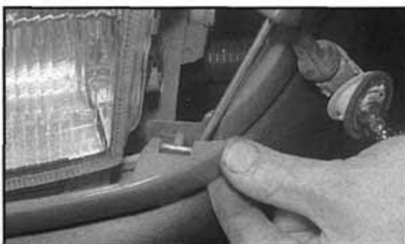
23.3 Páčíme konec rámečku světlometu směrem dopředu pro uvolnění pojistného kolíku
