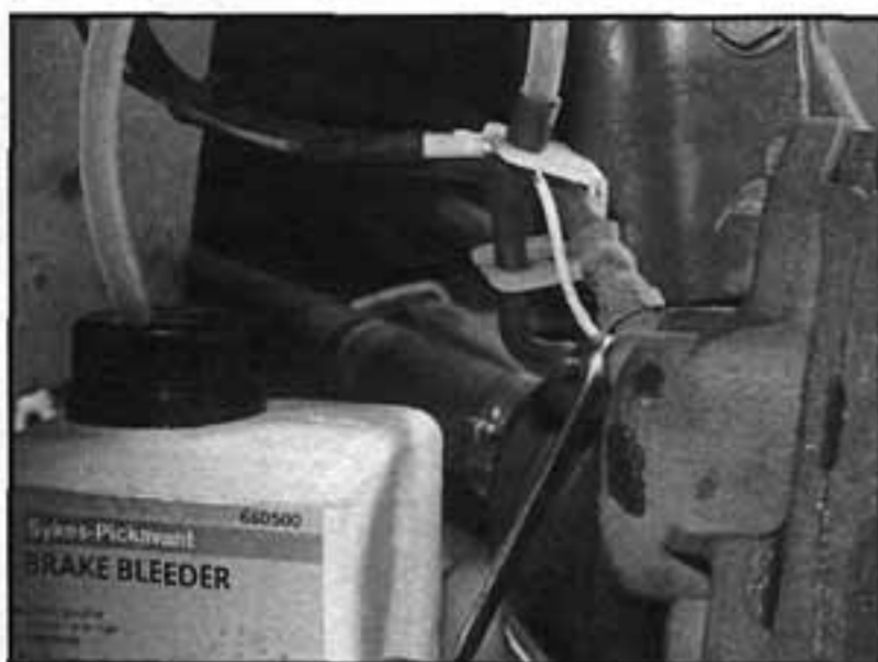
2.22 Odvzdušnění brzdy s použitím odvzdušňovací soupravy s jednocestným ventilem
