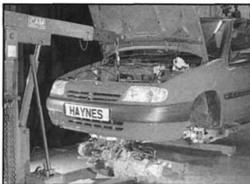
4.28 Spustíme sestavu motoru/převodovky spodní částí motorového prostoru
