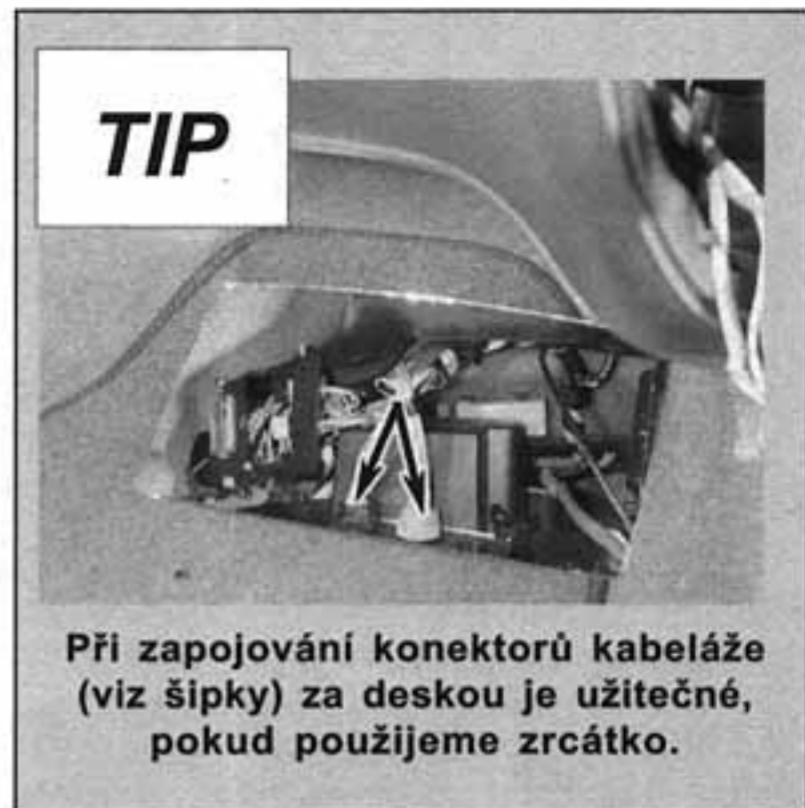
28.8 Odpojíme kabeláž airbagu/napínače bezpečnostního pásu
