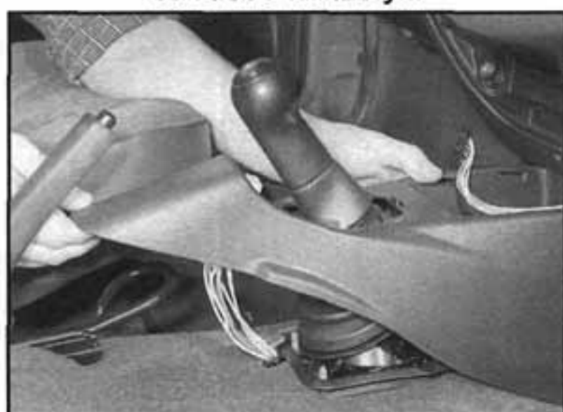
27.10 Vyzvedneme středovou konzolu přes řadicí páku a demontujeme ji
