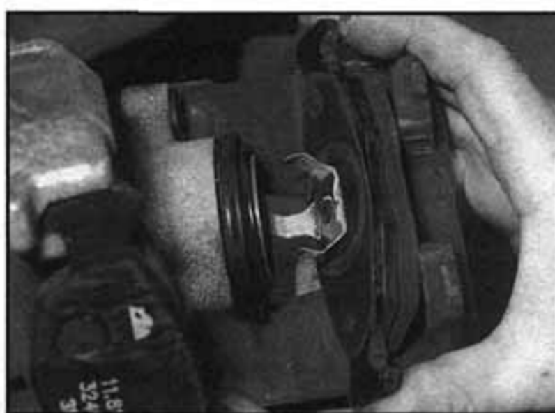
4.35 Zacvakneme vnitřní brzdovou destičku do pístu brzdového třmenu...
