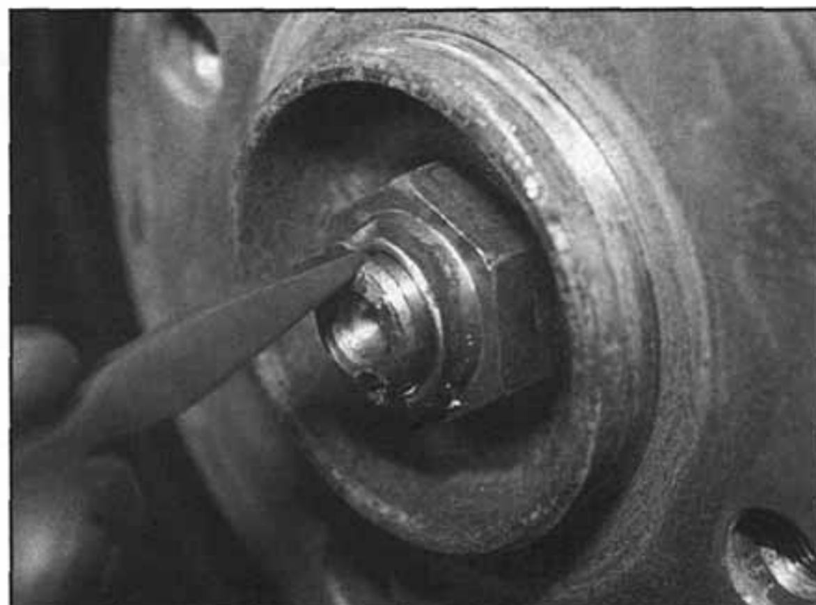
2.4 Narovnání zatemování matice hnacího hřídele
