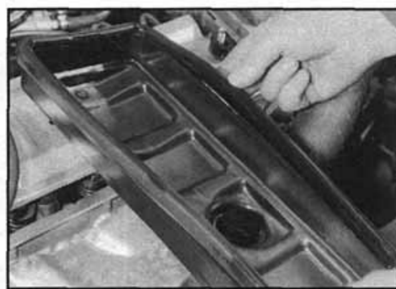
4.8 Při montáži zkontrolujeme usazení gumového těsnění na víku hlavy válců
