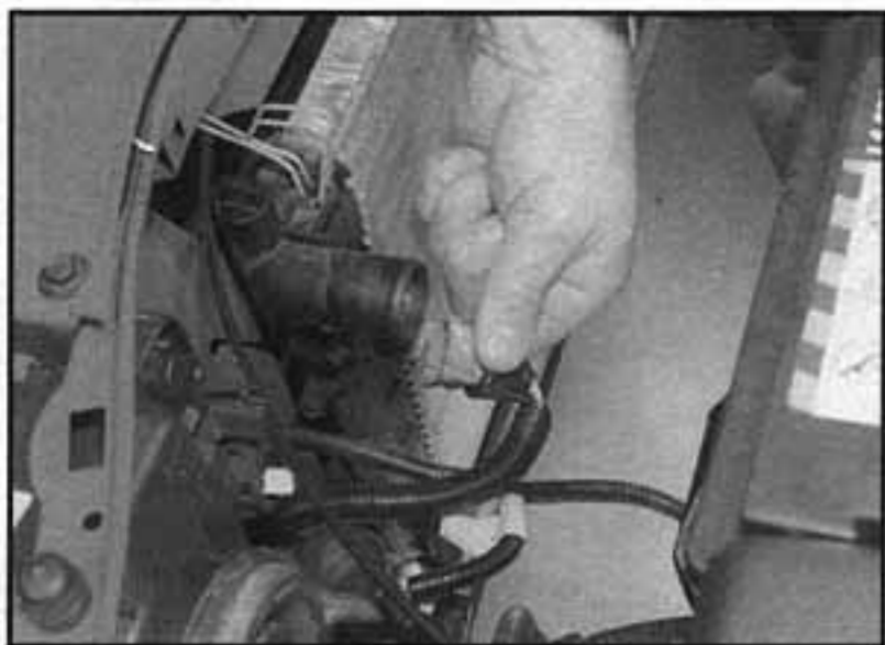
3.7 Odpojíme kabeláž od spínače ventilátoru
