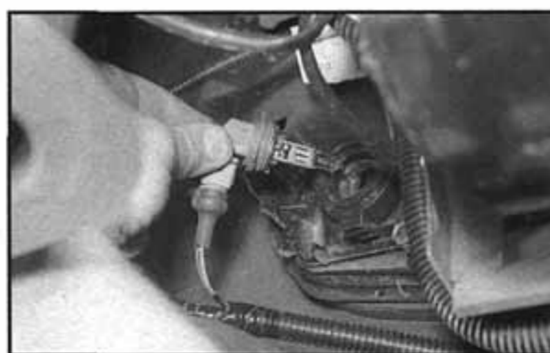
5.25 Otočíme držákem v protisměru hodinových ručiček pro jeho demontáž
