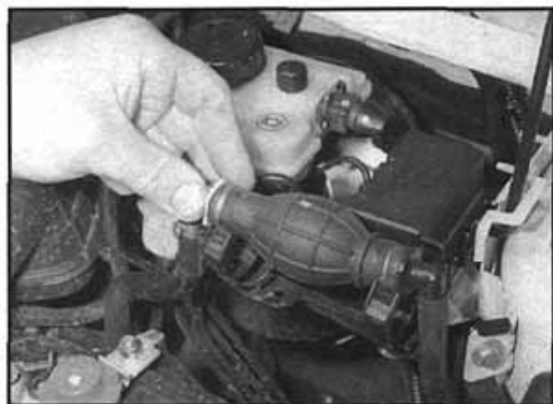
16.4 U vznětových motorů uvolníme ruční vstřikovací pumpu z jejího upevnění a dáme ji stranou
