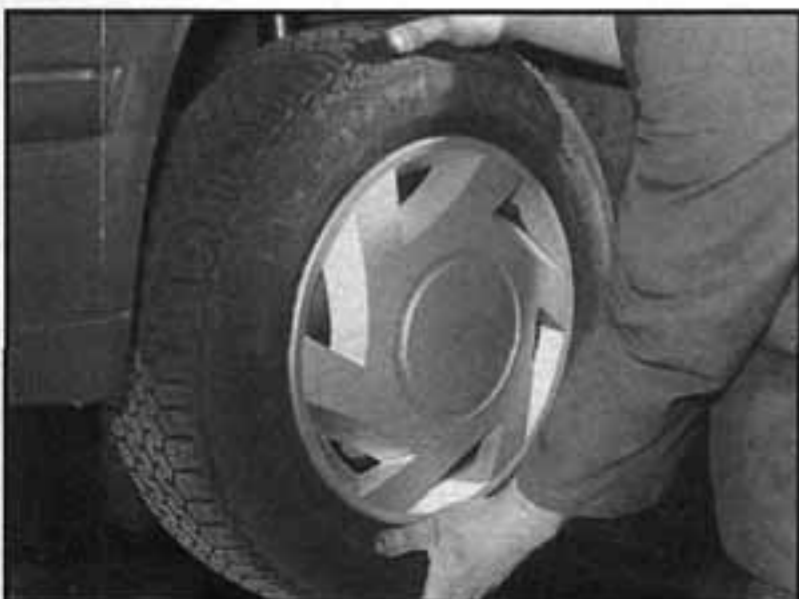
6.4 Uchopíme kolo, zavikláme jím a zkontrolujeme tak stav jeho ložisek
