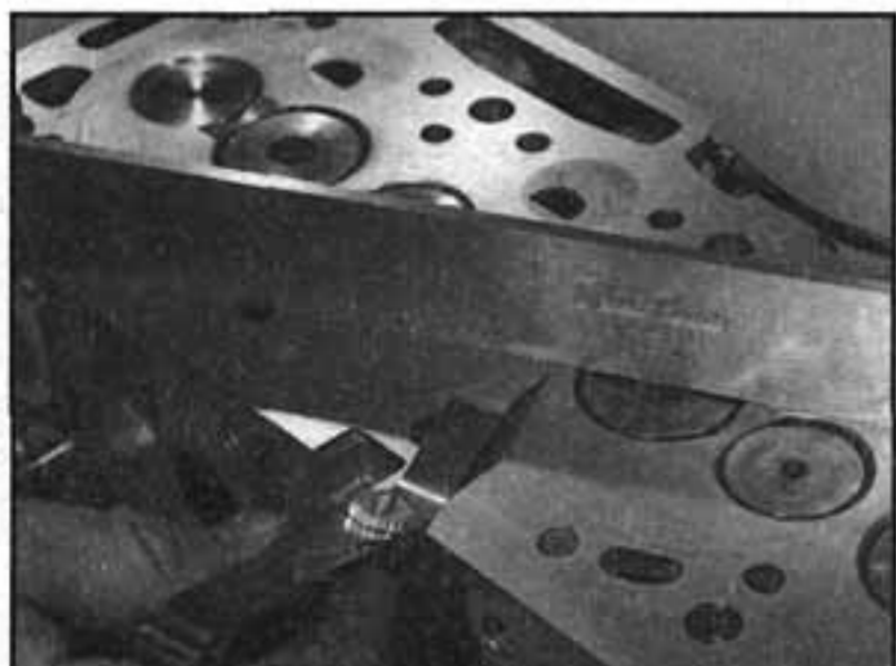
7.6 Kontrola povrchu těsnění hlavy válců
