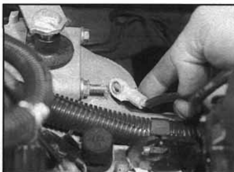
8.10 Uvolníme upevňovací matici a odpojíme ukostřovací pásek z horní části skříně převodovky
