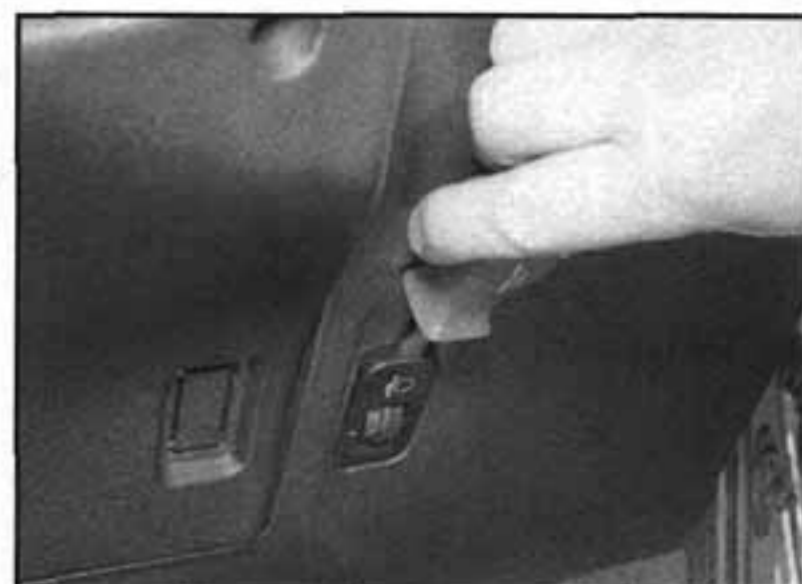
4.17a Vypáčíme spínač seřízení světlometů...
