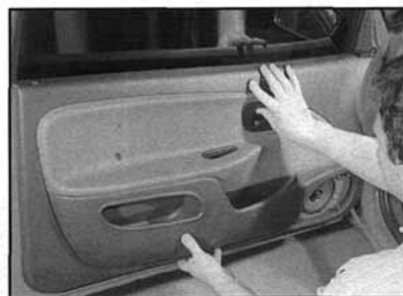
12.6b ...poté demontujeme obložení ze dveří
