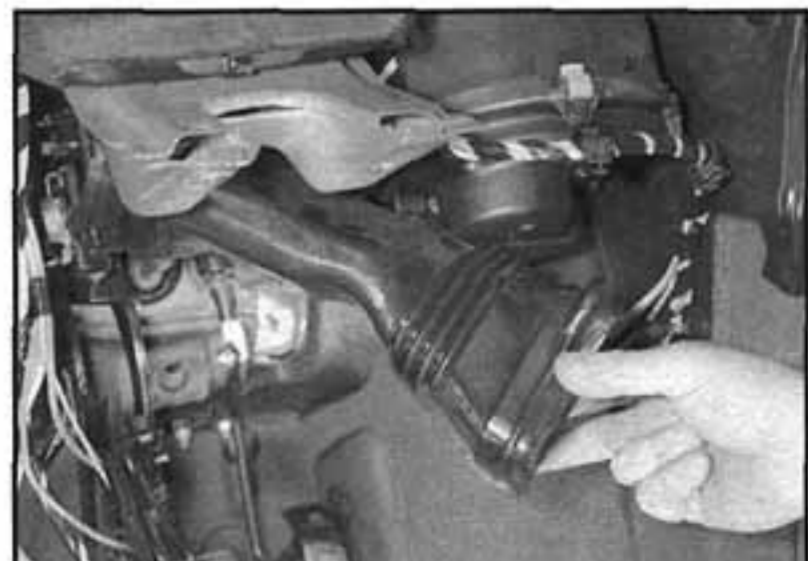
9.22 Oddělíme vzduchové potrubí ze strany krytu motoru ventilátoru
