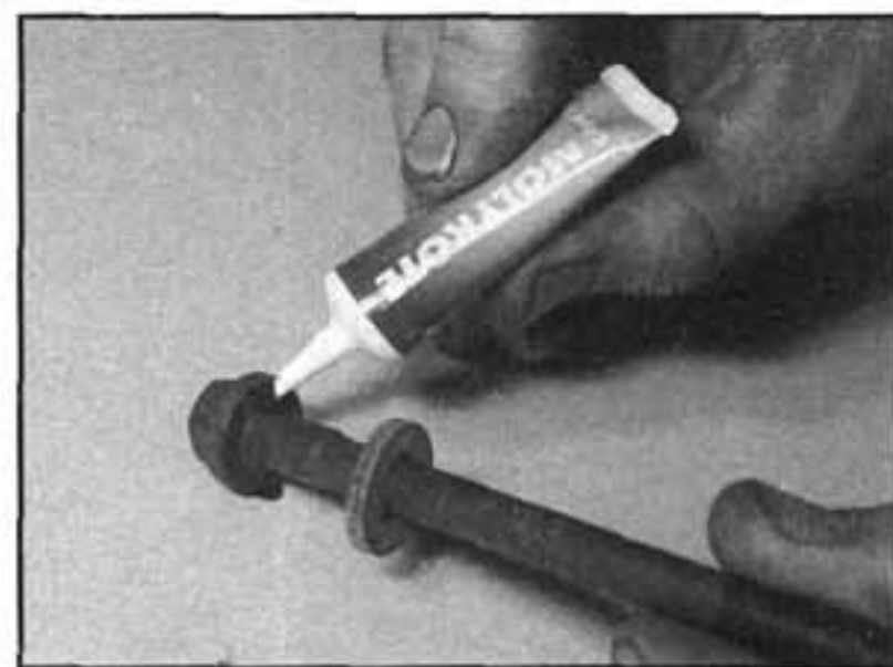
11.30 Naneseme malé množství specifikovaného maziva na spodní stranu hlav a závitů všech šroubů hlavy válců
