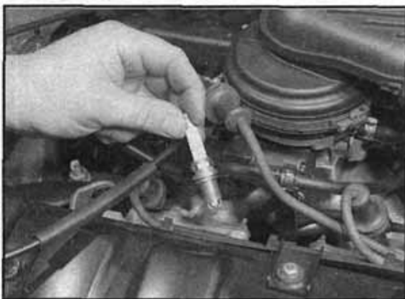
17.6b ...a demontujeme ji z hlavy válců
