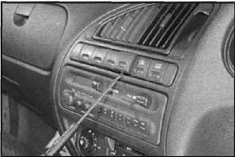
4.9a Vypáčíme slepý spínač v blízkosti spínače, který chceme demontovat...
