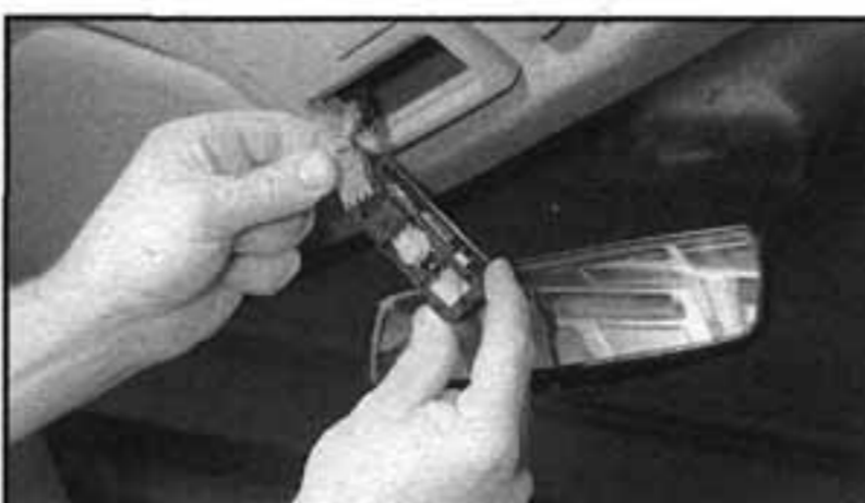
21.2 Odpojení konektoru kabeláže z vnitřního osvětlení vozidla
