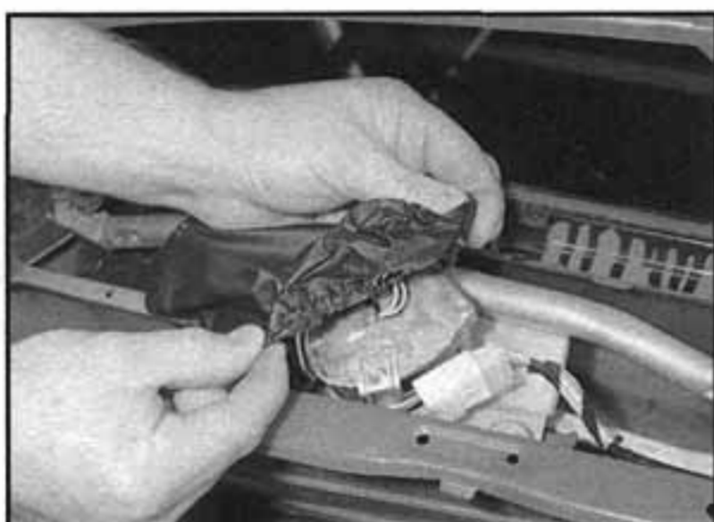
16.6 Demontáž pružného krytu z elektromotoru stěračů
