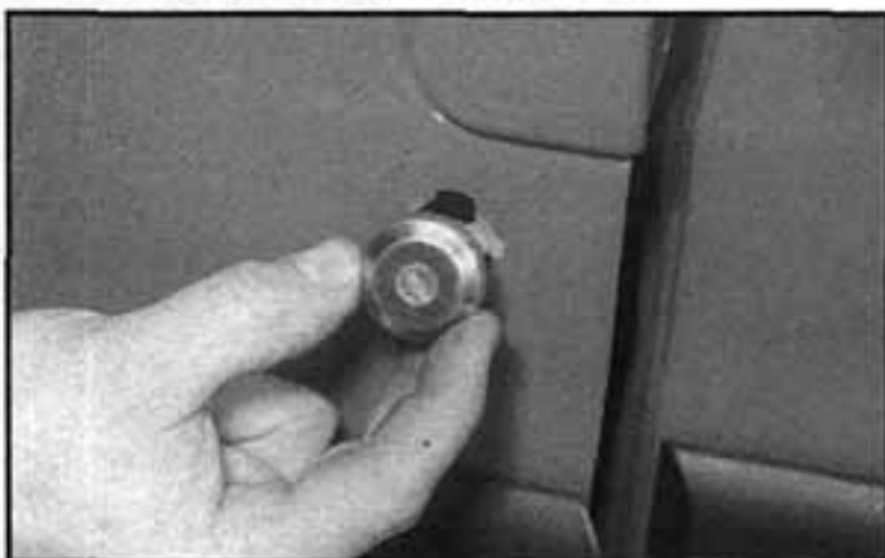
13.11a Po uvolnění upevňovací svorky vytáhneme vložku zámku...
