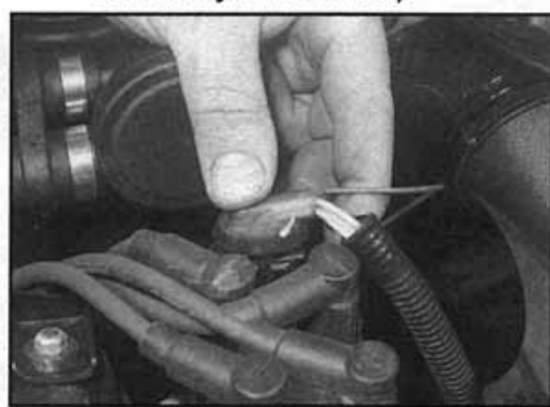
D Zkontrolujeme, zda je patřičně připojena kabeláž zapalovací cívky (modely se zážehovým motorem).
