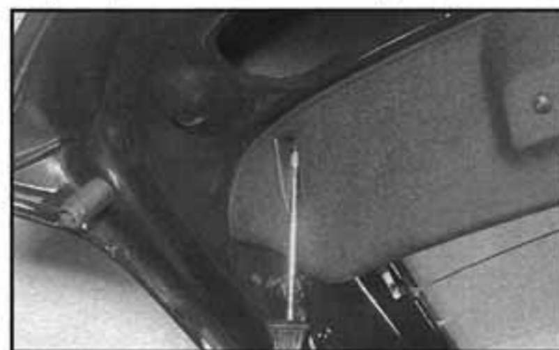
16.2a Demontujeme na každé straně šroub obložení výklopné zádě...
