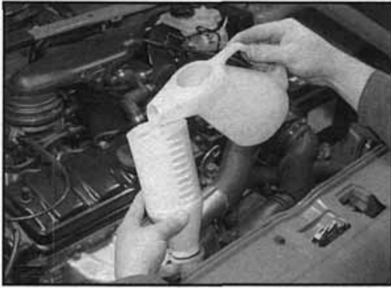
25.23 Naplníme chladicí systém pomocí doma vyrobeného rezervoáru (viz Tip)
