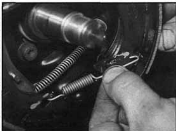
5.19 Montáž spodní vratné pružiny
