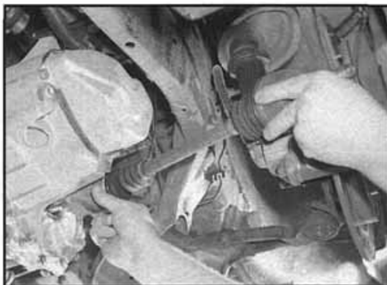
2.11 Vyjmeme hnací hřídel z převodovky (ukázka – levý hnací hřídel)
