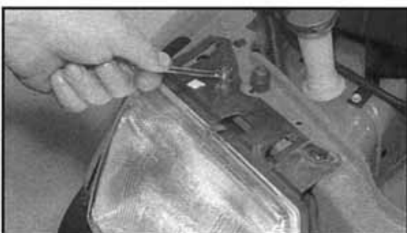
7.3a Demontáž upevňovacího šroubu světlometu z horní části...
