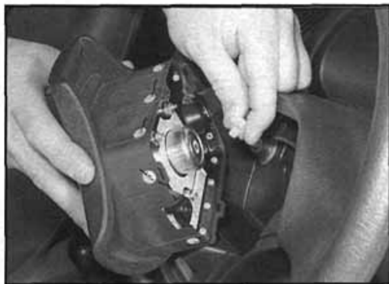
24.3 Odpojíme konektor kabeláže z jednotky airbagu
