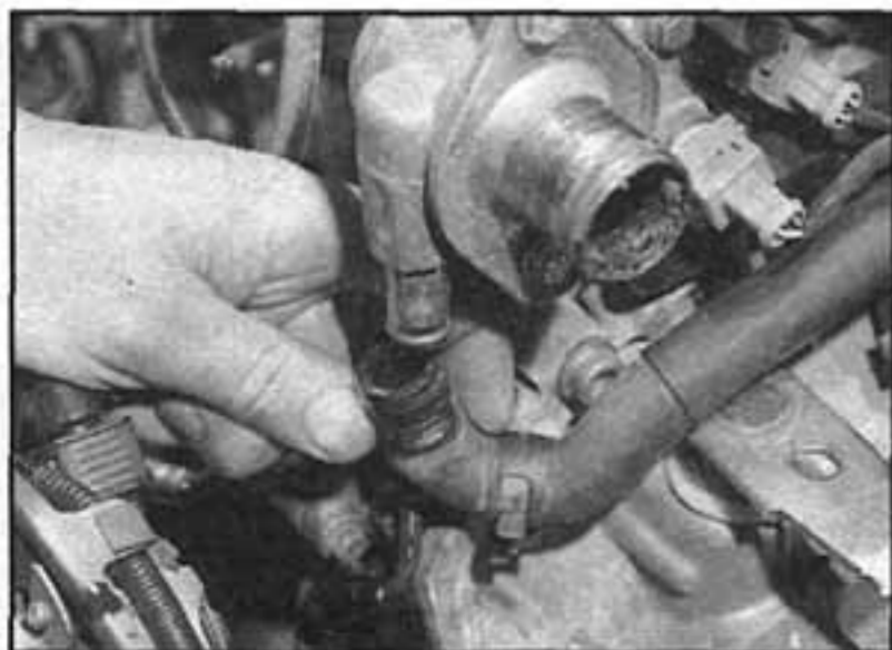
12.12 Odpojíme hadice chladicí soustavy z tělesa termostatu
