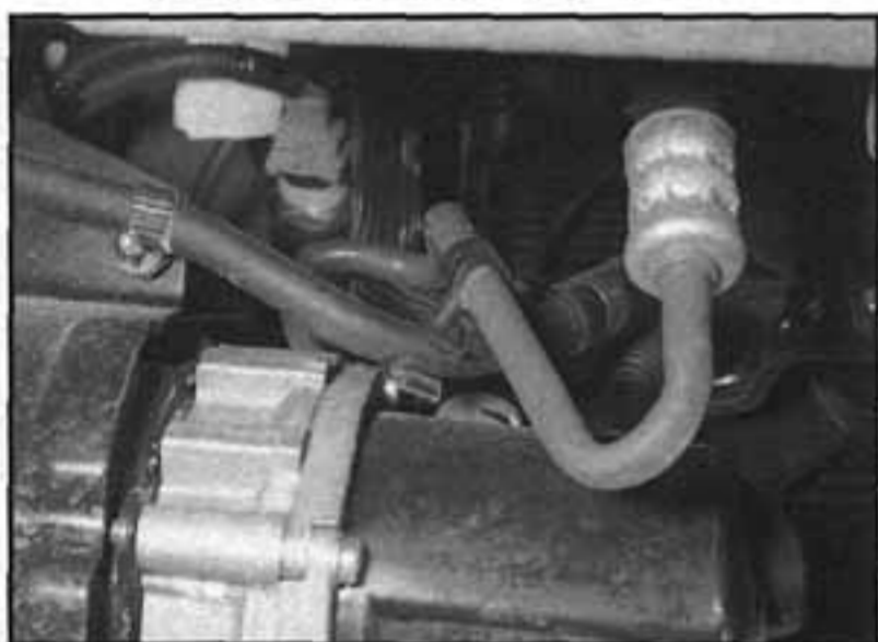
17.17 Uvolníme potrubí kolem čerpadla
