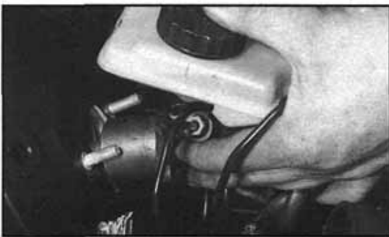
16.10b ...a odmontujeme hlavní brzdový válec od servomechanismu
