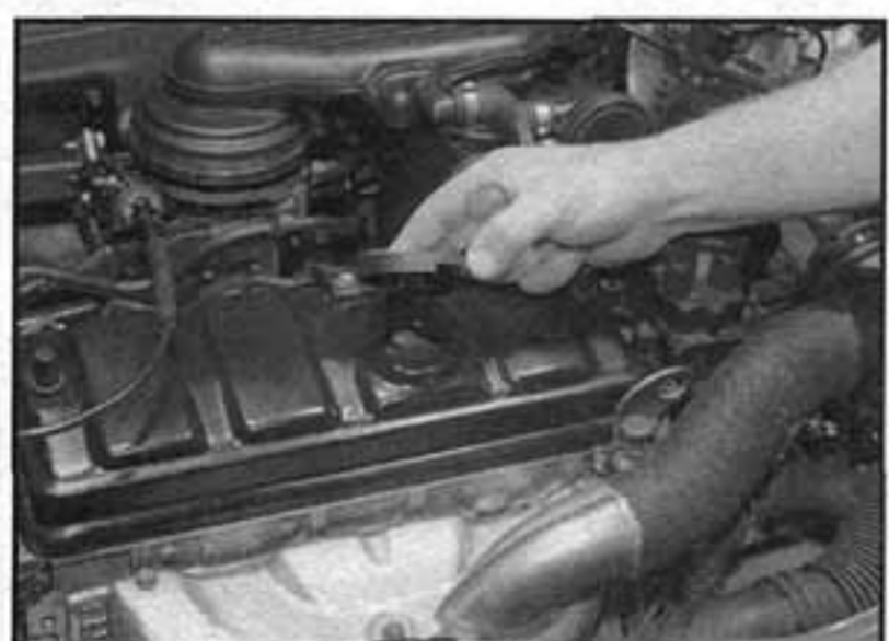
3.11c ...poté vyšroubujeme uzávěr plnicího hrdla z víka hlavy válců
