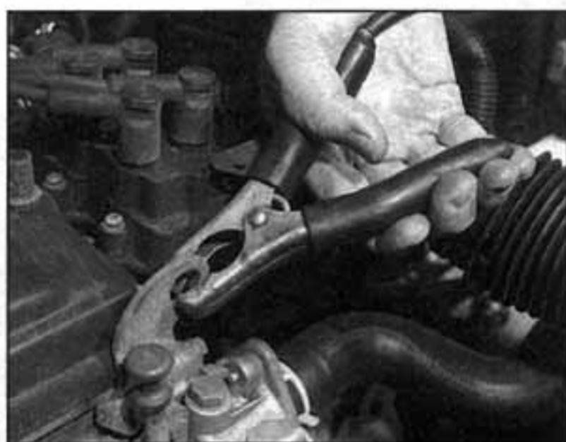
4 Druhý konec černého startovacího kabelu připojíme dostatečně daleko od baterie na dobře ukostřené (lesklé) místo na bloku motoru vozidla s vybitou baterií, např. na šroub hlavy válců.
