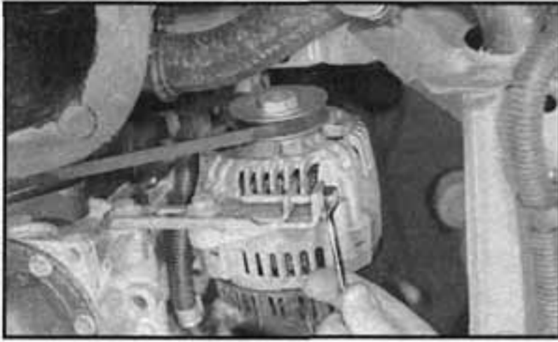
23.8a Otočíme nastavovacím šroubem pro uvolnění napnutí klínového řemenu
