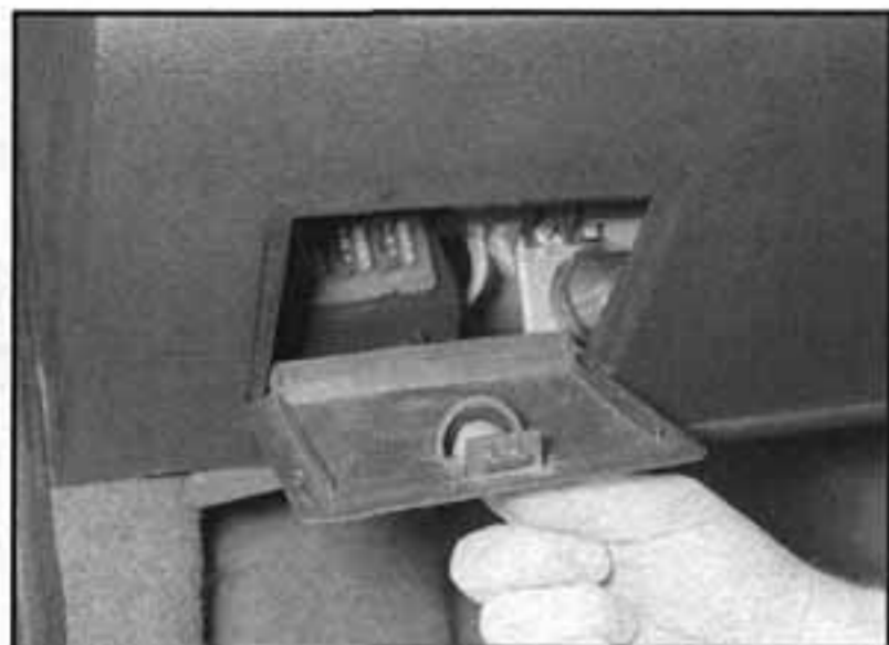
3.3 Vypáčíme kryt pojistkové skříňky pro přístup k pojistkám
