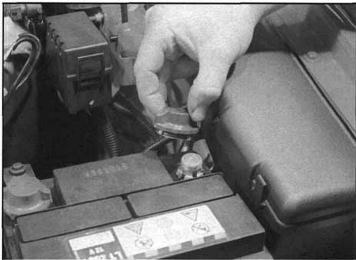
4.2 Vyšroubujeme plastovou matici a odpojíme ukostřovací (-) kabel od baterie
