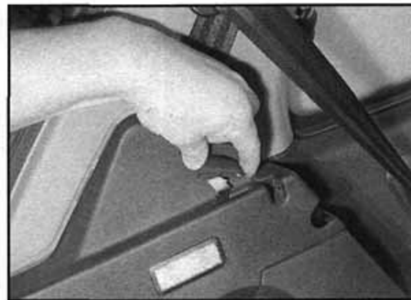
26.10c ...poté vytáhneme knoflík z uvolňovací páky opěradla sedadla
