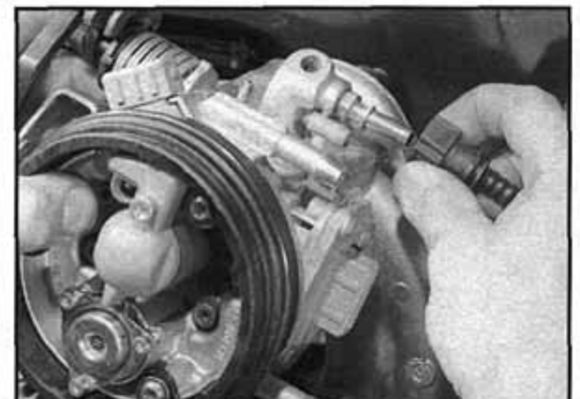
15.4 Odpojíme podtlakovou hadici odvzdušňovacího ventilu ze zadní potrubí
