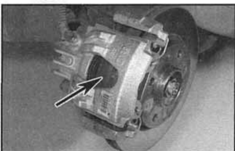
10.2 Tloušťka třecího materiálu je viditelná přes kontrolní otvor v přední části třmenu kotoučové brzdy
