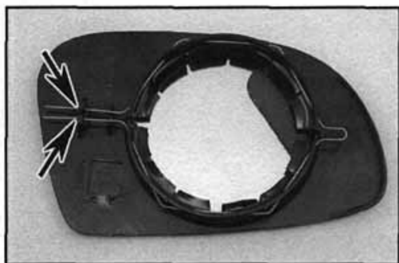
19.9 Před montáží skla zrcátka se ujistíme, že jsou čepy upevňovací svorky následovně usazeny (viz šipky)
