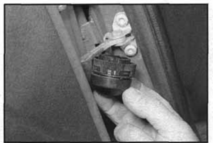
11.5 Ujistíme se, že je oranžové značení na objímce po připojení kabeláže vyrovnané
