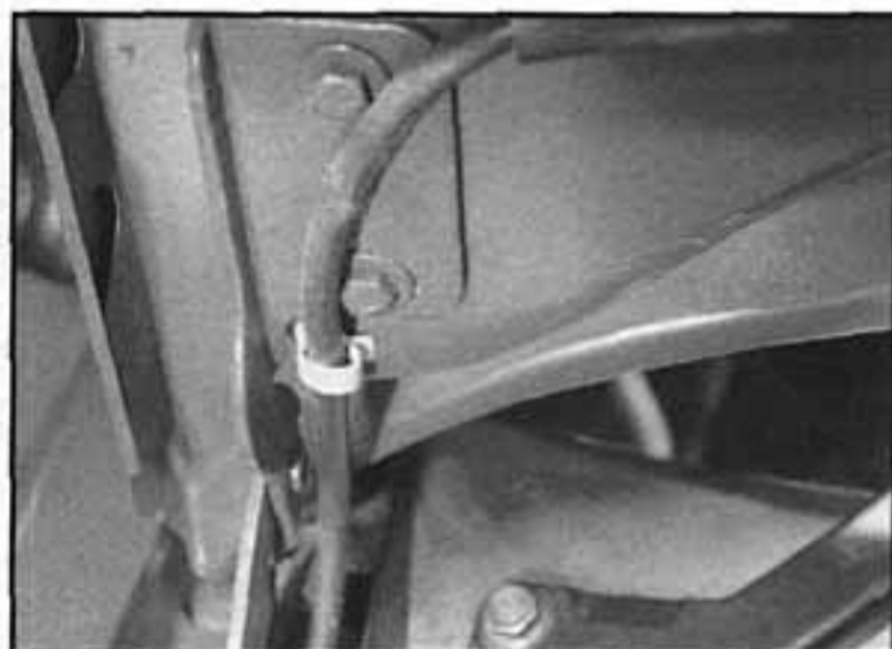
8.2a Hadička kapaliny do ostřikovače je upevněna ke kapotě...
