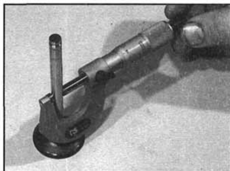
7.12 Měření průměru dřívku ventilu
