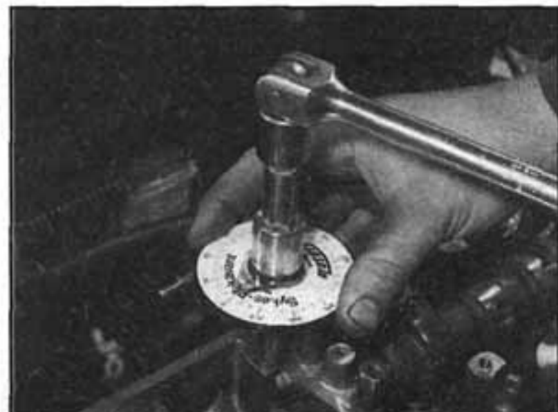
11.33 ...a utahování s použitím speciálního klíče s úhloměrem, viz text
