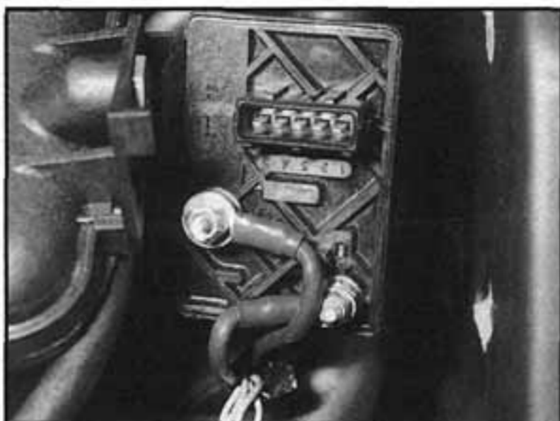
3.4b ...poté vyšroubujeme dvě upevňovací matice od řídicí jednotky hlavní kabely
