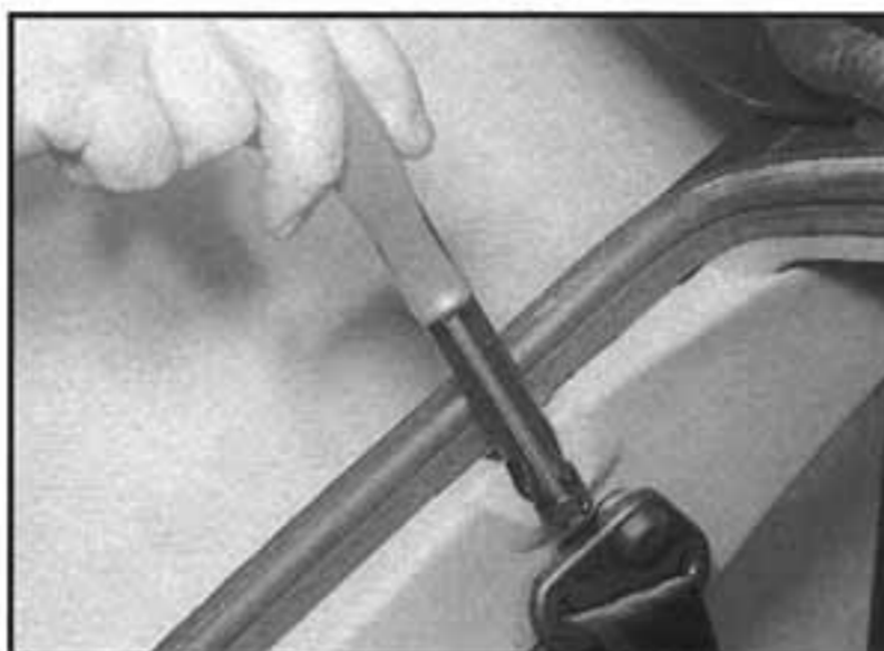
15.9 Vypáčení spodní pružné svorky vzpěry výklopné zádě
