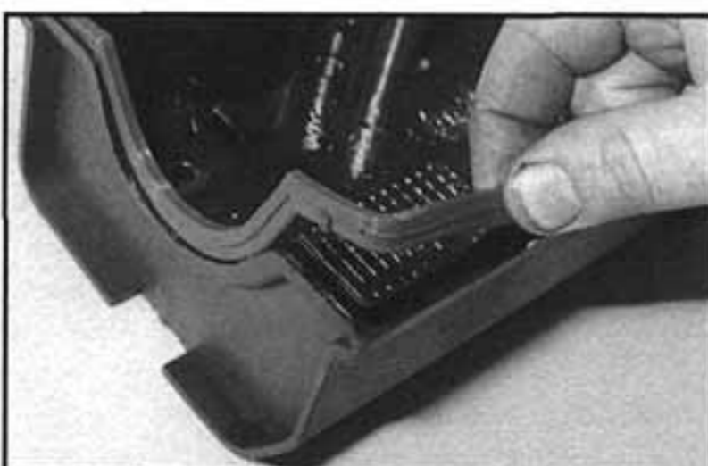
4.6 Ujistíme se, že je pryžové těsnění patřičně usazeno
