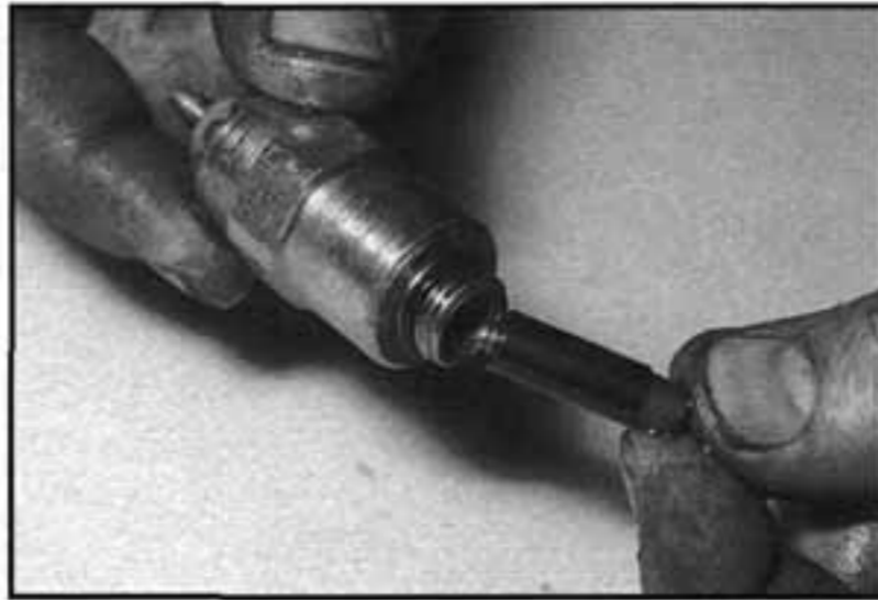
11.6b Demontujeme elektromagnet a vyjmeme plunžr a pružinu
