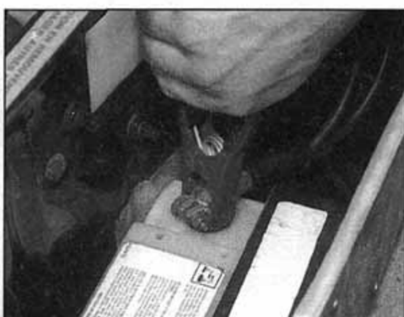
2 Druhý konec červeného startovacího kabelu připojíme na (+) pól pomocné baterie.
