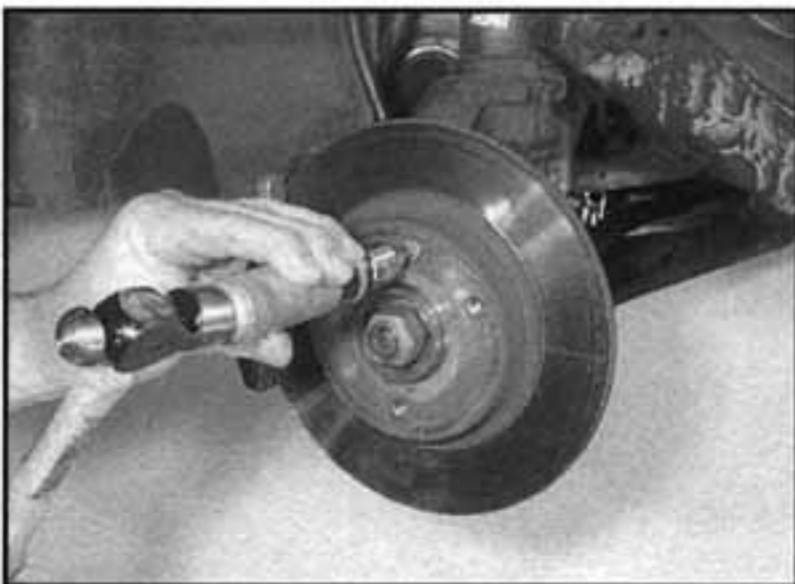
7.8a Použijeme elektrický šroubovák pro uvolnění upevňovacích šroubů brzdového kotouče
