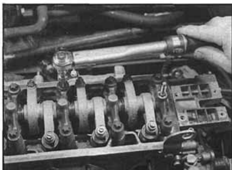
12.34a Provedeme 1. etapu utažení šroubů hlavy válců
