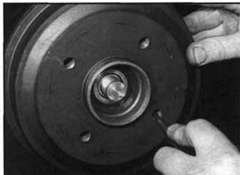
8.6 Pomocí šroubováku uvolníme seřizovací mechanismus brzdové čelisti – model se čtyřmi šrouby
