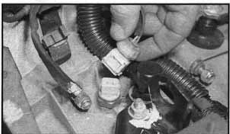
6.4 Odpojíme konektor kabeláže od spínače zpětných světlometů
