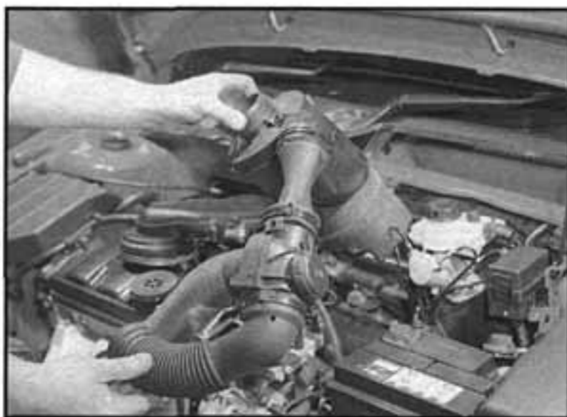
2.6 Vyzvedneme vzduchový filtr a sací potrubí z motorového prostoru
