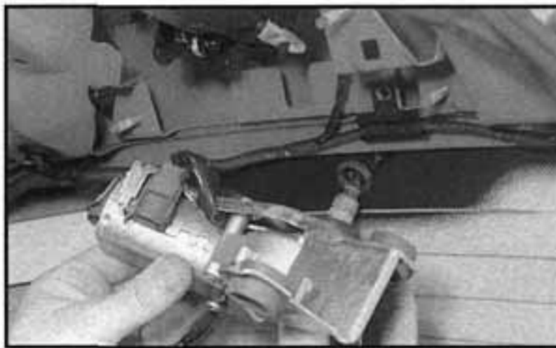
17.7b ...a demontujeme sestavu elektromotoru z výklopné zádě
