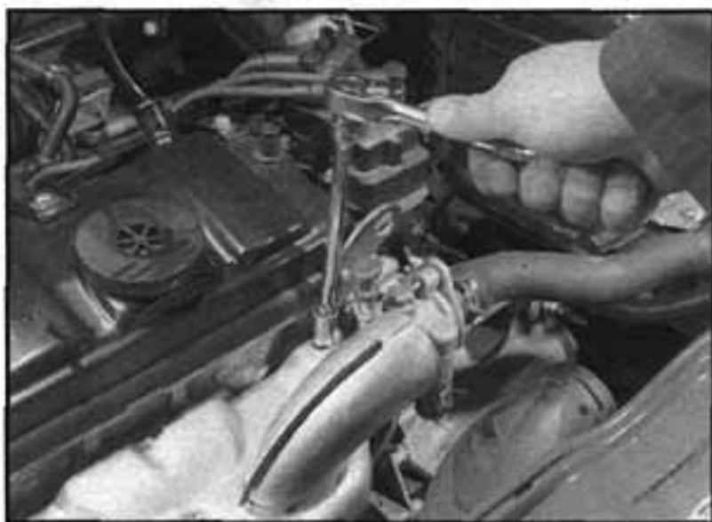
2.2 Odmontujeme kryt horní části výfukového sběrače
