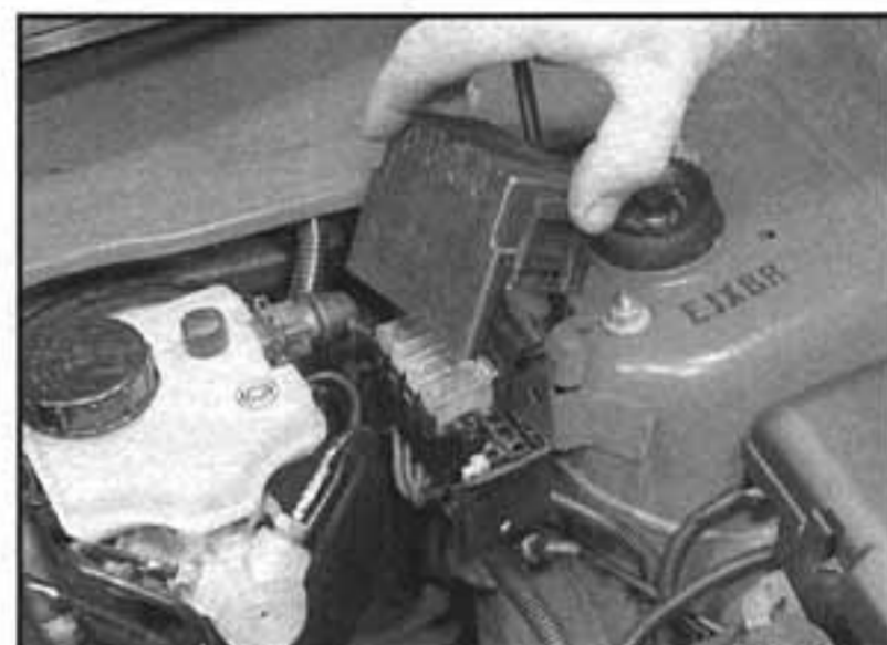
4.21c U zážehových motorů demontujeme kryt ze skříňky tavných pojistek...
