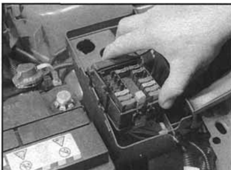
4.21e Z pojistkové/reléové skříňky vyjmeme základní část...
