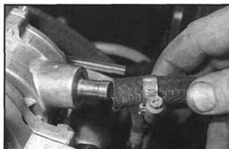
11.13 Odpojíme hadici od vývěvy brzdového systému
