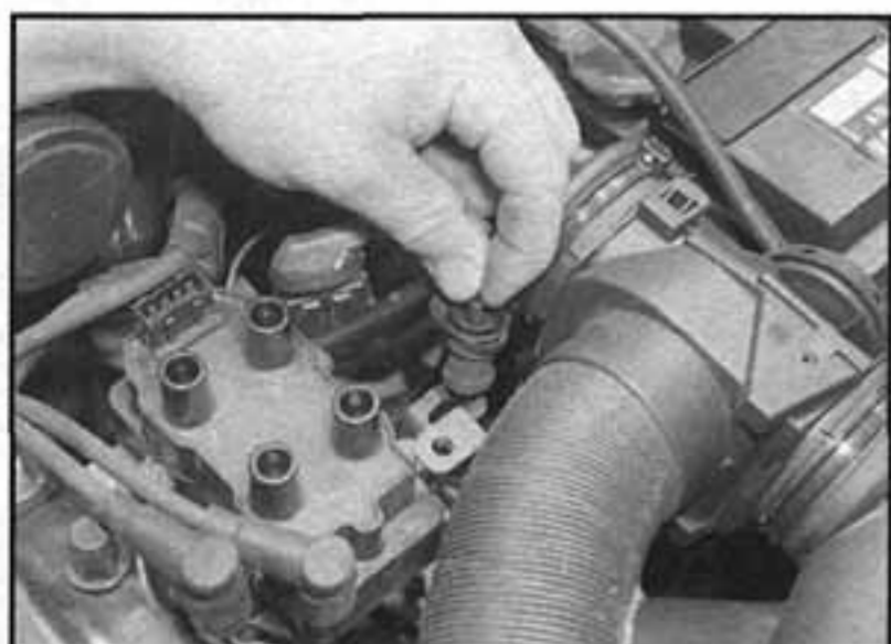
2.5 Otočíme rychloupínací příchytku pro uvolnění sacího potrubí z jeho držáku přiléhajícímu k modulu zapalovací cívky
