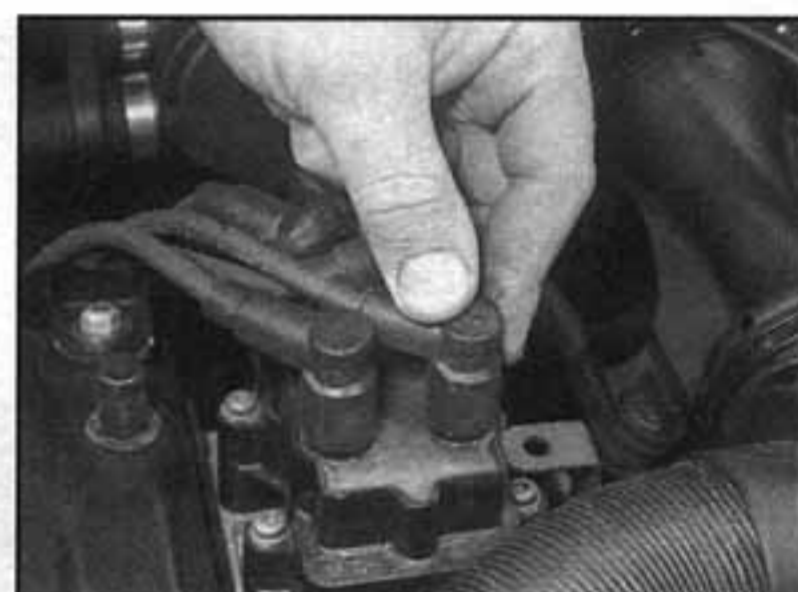
C Rovněž zkontrolujeme připojení čtyř zapalovacích kabelů k zapalovací cívce (modely se zážehovým motorem).
