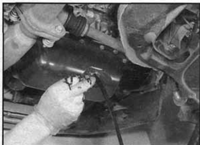
3.3b ...poté demontujeme zátku a necháme olej vytéci do nádoby
