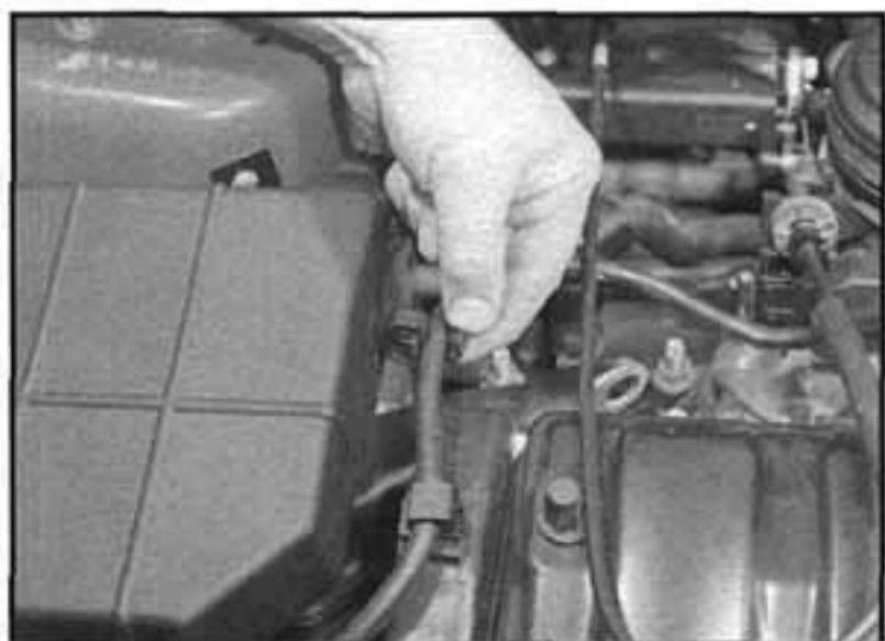
14.26a Uvolníme podtlakovou hadici odvzdušňovacího ventilu ze strany umělohmotného krytu ECU
