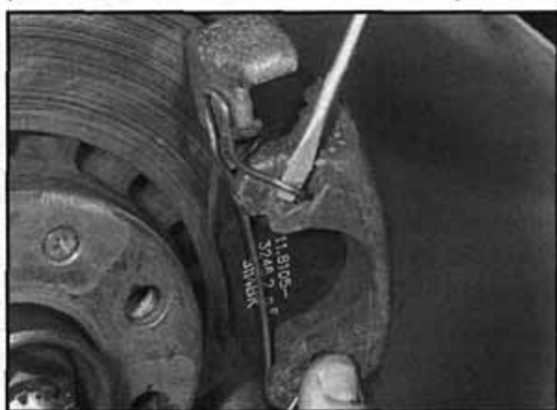
4.30 Vypáčíme upevňovací svorku destičky z třmenu brzdy - třmen kotoučové brzdy ATE (chlazený kotouč)
