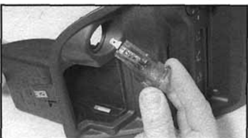
12.3 Případně můžeme zapalovač demontovat spolu s jeho rámečkem
