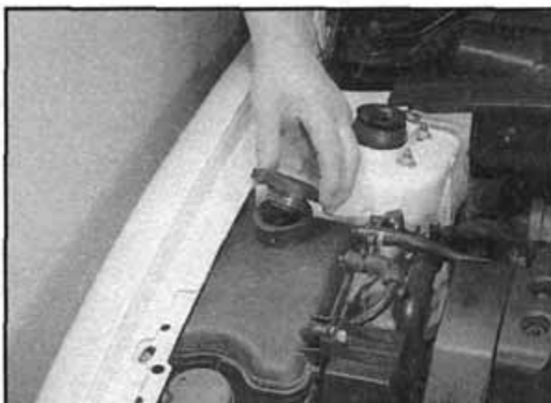
23.19 Demontáž víčka vyrovnávací nádržky
