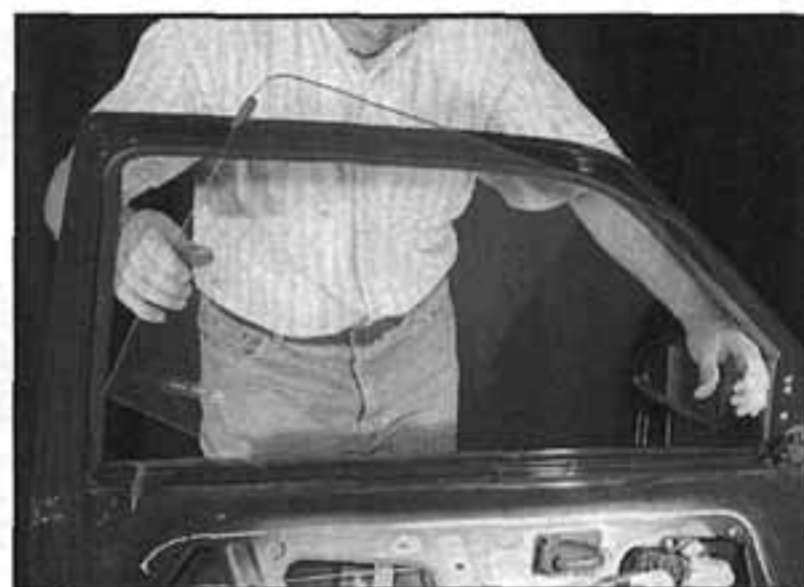
14.6 Nakloníme sklo směrem dopředu a vyjmeme ho z okna
