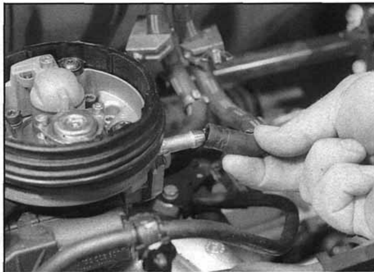
12.4b Uvolníme upevňovací svorky a odpojíme palivové hadice ze sestavy tělesa škrticí klapky
