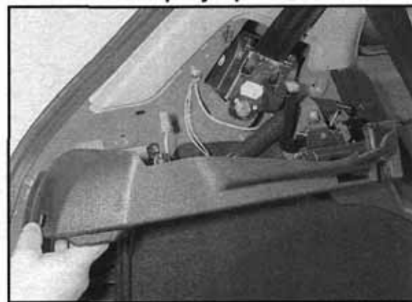
26.12 Demontáž nosiče odkládací police za zadními sedadly
