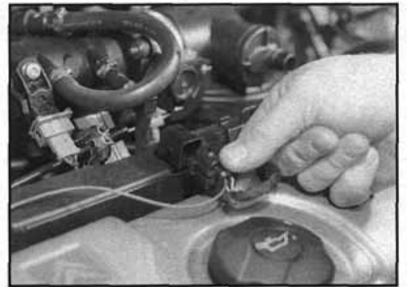
3.6 Vypojíme konektor kabeláže z horní části modulu zapalovací cívky
