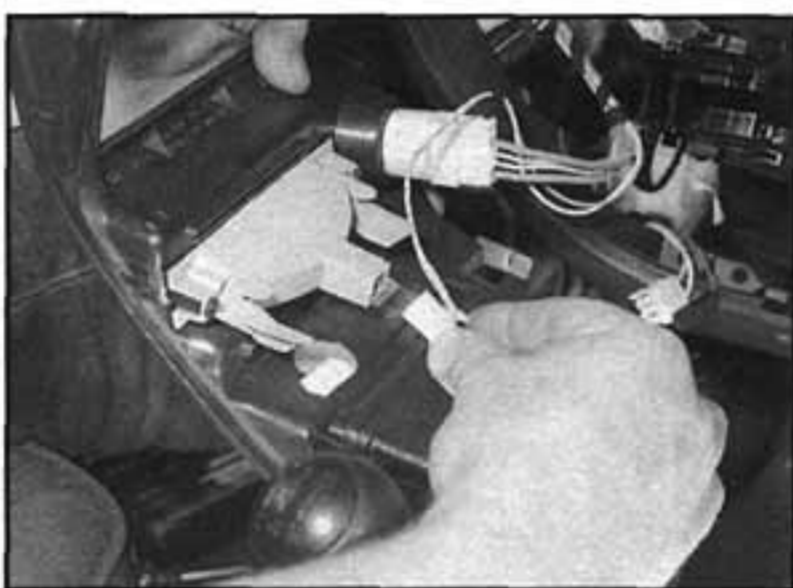
9.7a Ze zadní části panelu odpojíme veškerou kabeláž
