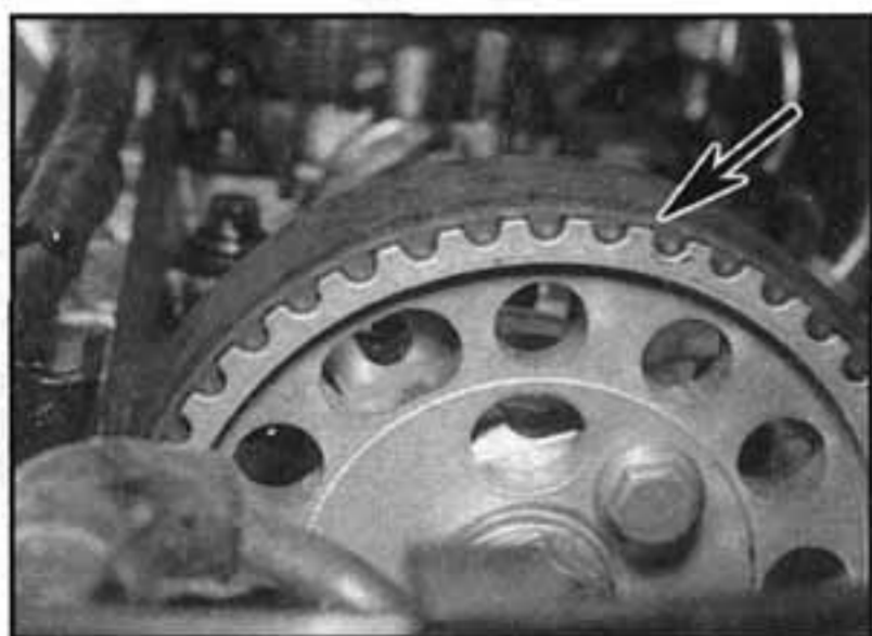
6.15 Sesadíme rozvodový řemen s ozubeným kolem vačkového hřídele, viz text
