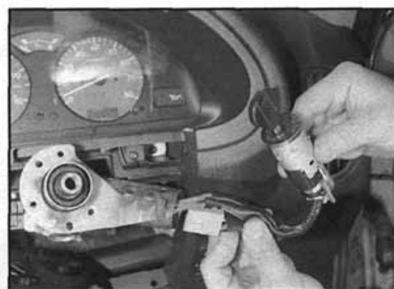
12.8 Vyjmeme spínač zapalování a kabeláž otvorem ve válcové vložce zámku
