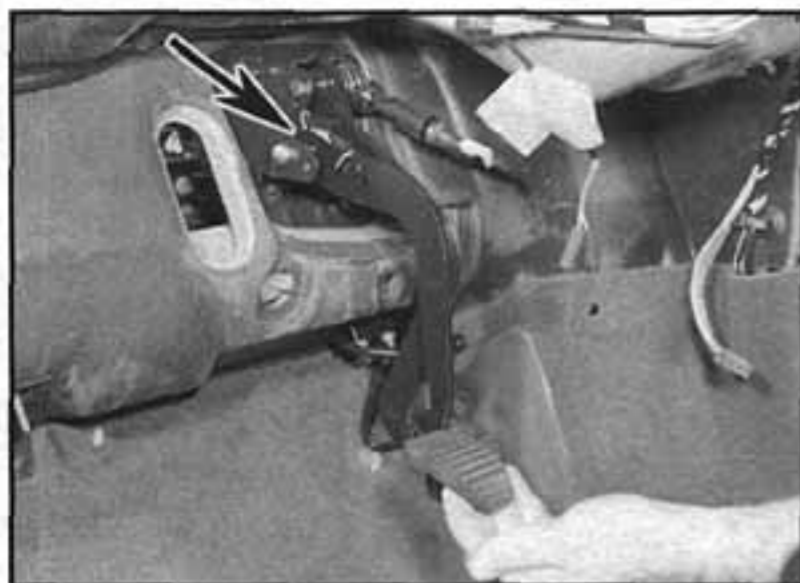
3.5 Zdvihneme pedál spojky, poté vyhákneme vnitřní táhlo spojky z horní části pedálu spojky (viz šipka) – přístrojová deska je na obrázku demontována pro lepší viditelnost
