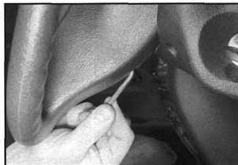
24.2 Demontáž upevňovacích šroubů airbagu ze zadní strany volantu
