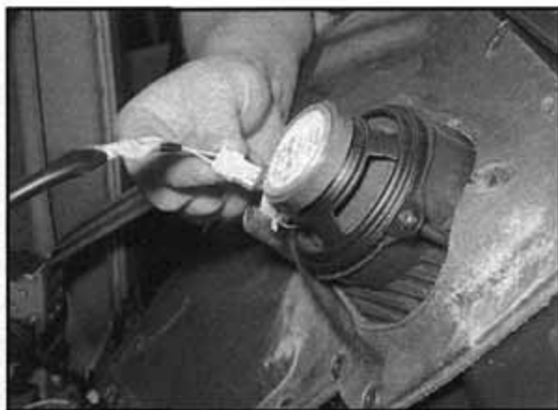
26.6b ...a odpojíme kabeláž zadního reproduktoru
