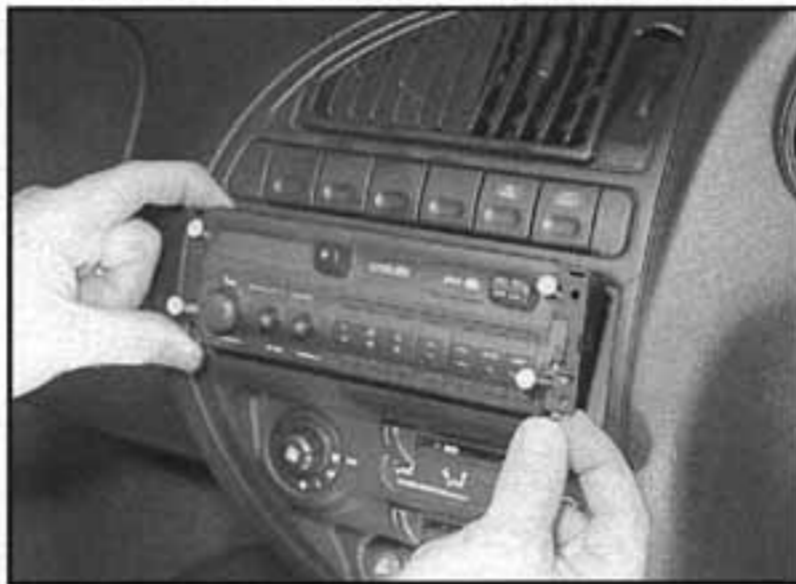
19.5 Demontáž rádia bez speciálních nástrojů
