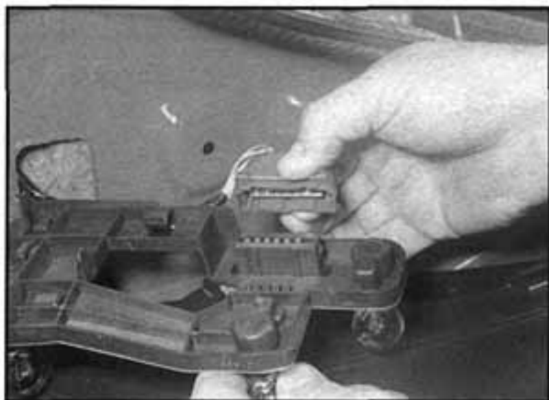
7.25 Odpojíme konektor kabeláže z držáku žárovky
