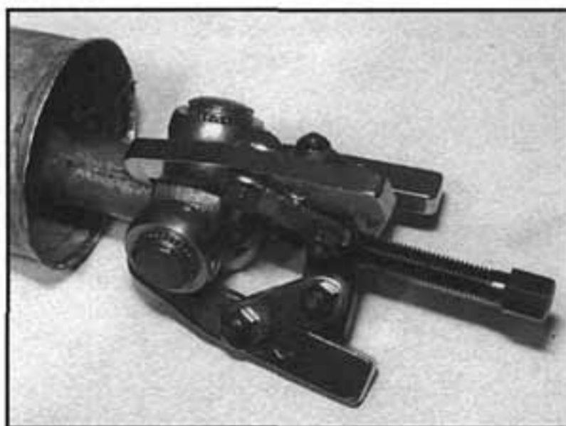
4.17a Použití trojnohého stahováku pro demontáž vnitřního kloubu
