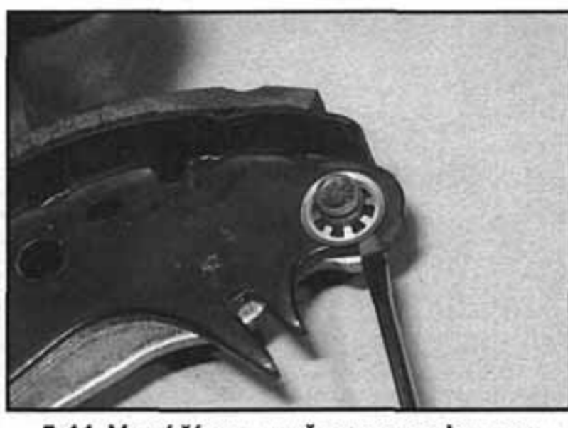
5.11 Vypáčíme pružnou svorku pro demontáž seřizovací páky z úběžné brzdové čelisti
