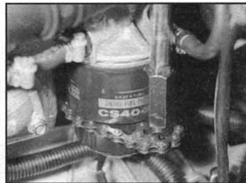
15.4 Použijeme řetězový klíč pro vyšroubování palivového filtru
