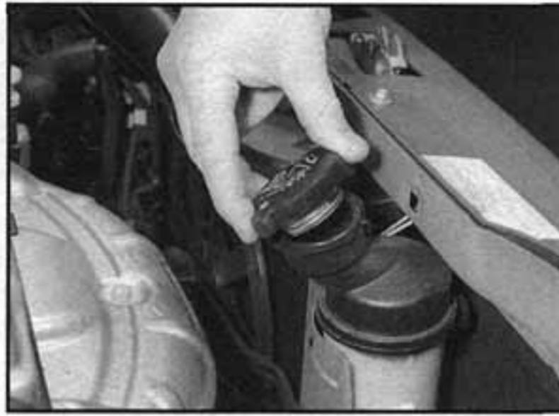
25.25 Namontujeme a pevně utáhneme uzávěr plnicího hrdla chladicího systému
