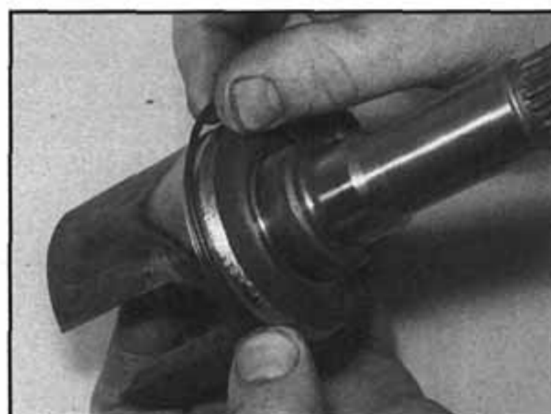
4.25c ...a těsnicí O-kroužek
