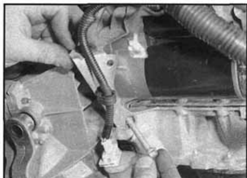
10.5 Uvolníme tři upevňovací šrouby startéru a vyjmeme vzpěru potrubí přívodu vzduchu
