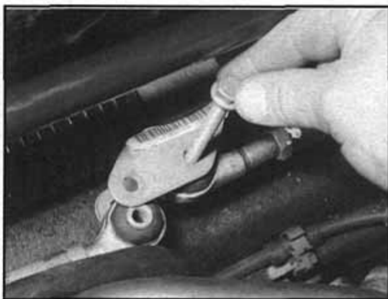
15.2 Demontujeme upevňovací šrouby řídicí tyče
