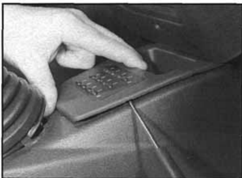
27.1a Uvolníme svorky klávesnice stlačením směrem dovnitř a nahoru...
