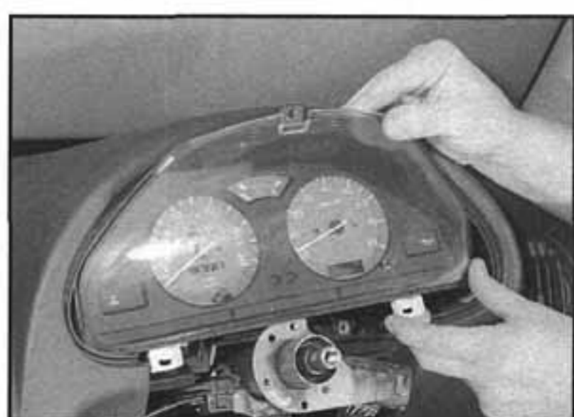
9.5b ...poté vyjmeme panel z jeho pozice v palubní desce
