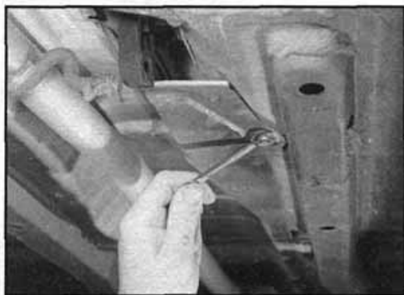
13.7a Uvolníme a vyjmeme upevňovací šrouby a matice...
