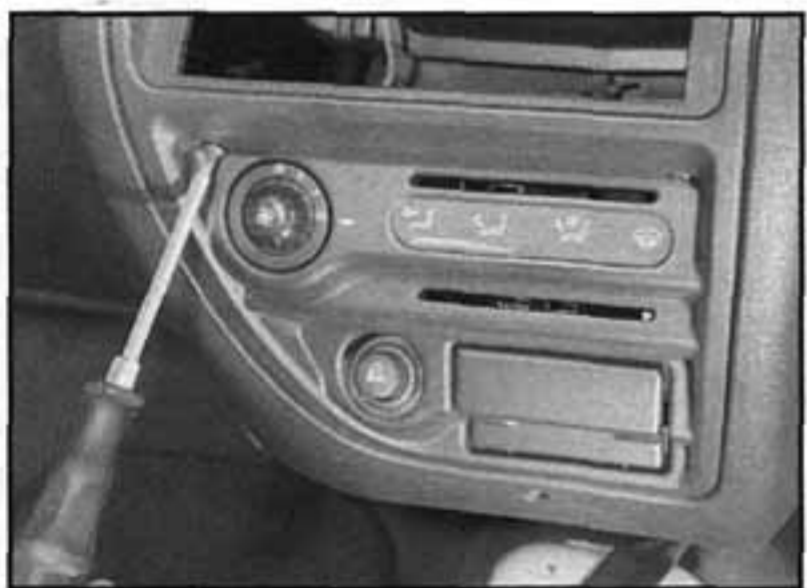
9.5 Uvolníme a vyjmeme dva šrouby umístěné nad posuvným spínačem topení
