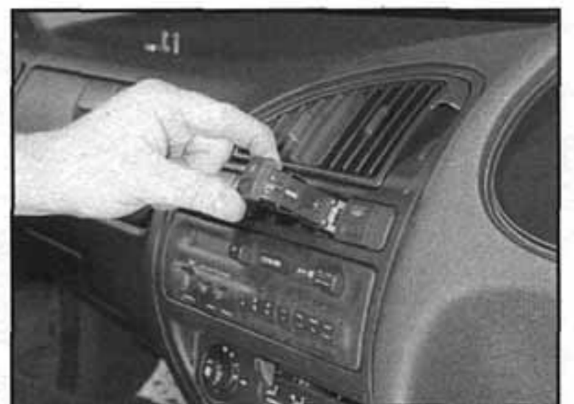
4.10b ...a vyjmeme ho z přístrojové desky
