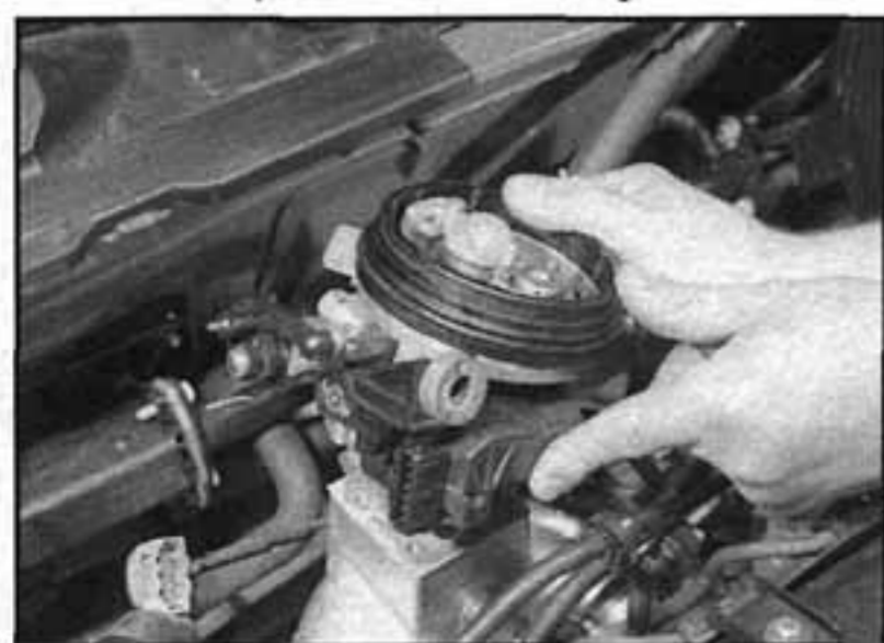
12.7b ...poté demontujeme sestavu tělesa škrticí klapky ze sacího potrubí
