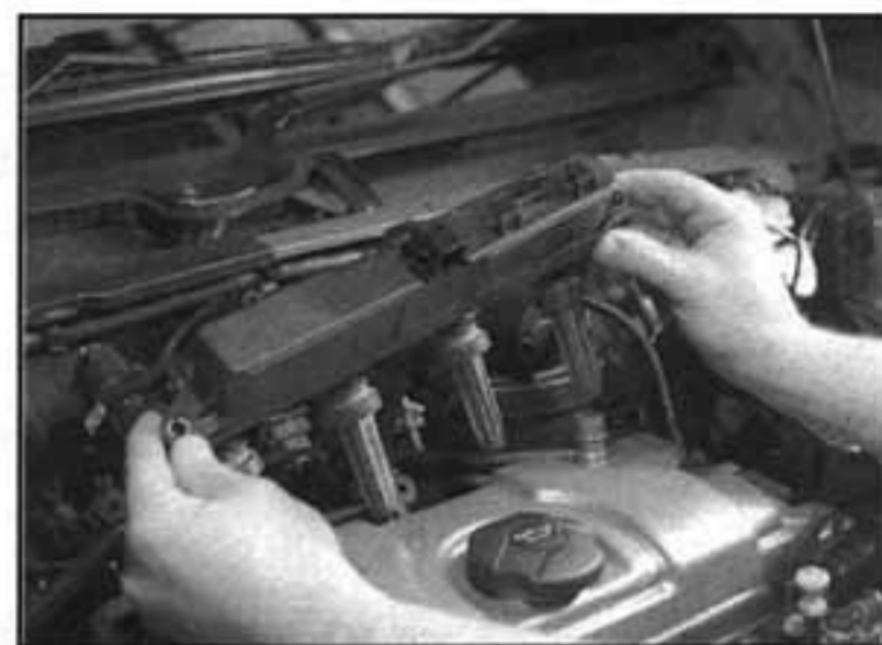
3.9b ...a vyzvedneme modul zapalovací cívky z jeho montážních kolíků
