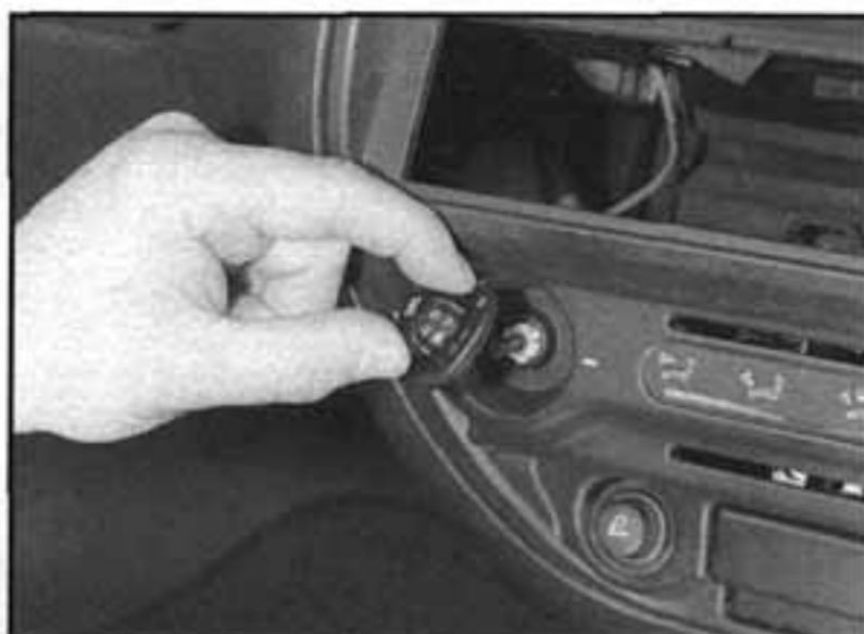
4.13 Vytáhneme knoflík ovládání motoru ventilátoru
