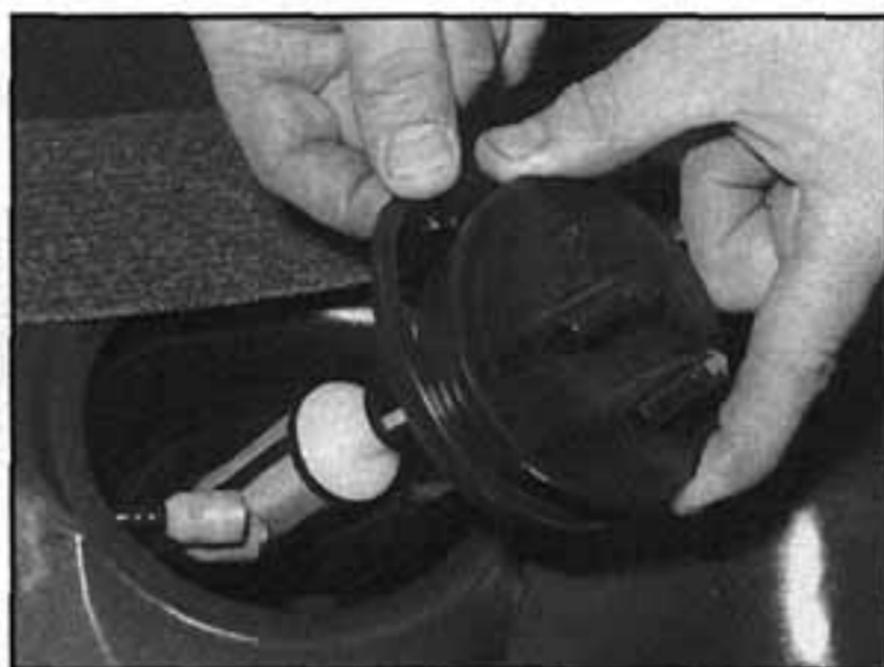
6.8 ...poté nadzvedneme sací síto a sejme pryžový těsnicí kroužek
