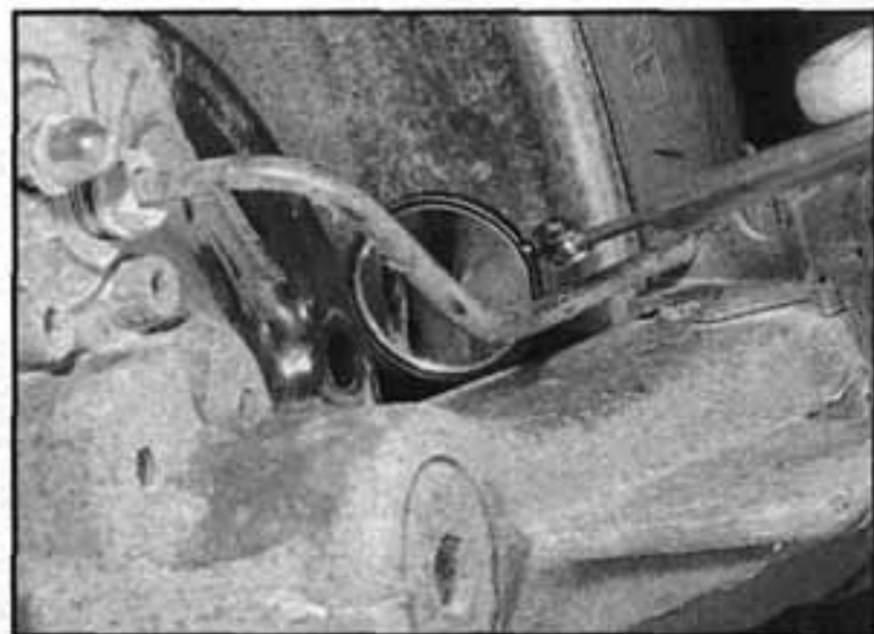
18.2b Pohled na tloušťku obložení brzdové čelisti pomocí malého zrcátka
