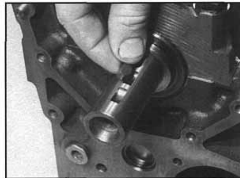
10.10c Vyjmeme úsečové pero z klikového hřídele
