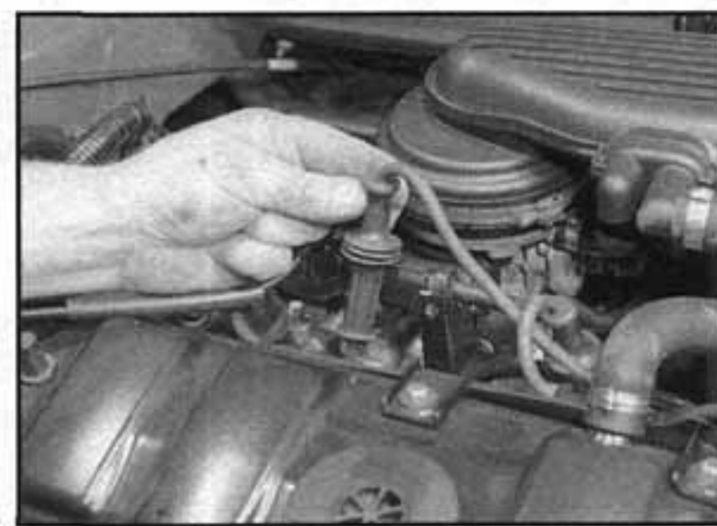
17.3 Odpojíme zapalovací kabely od zapalovacích svíček (na obrázku je model 1,1 l)
