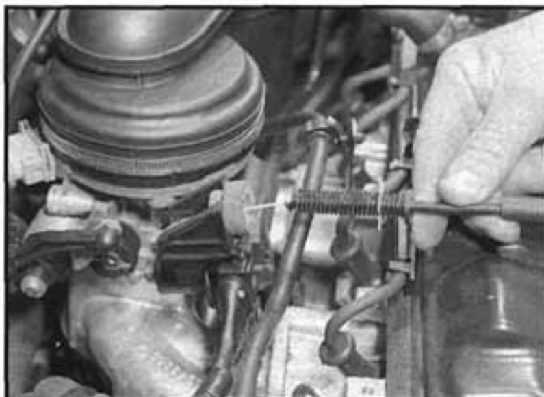
4.2 Vyjeme táhlo plynu z jeho pryžové průchodky
