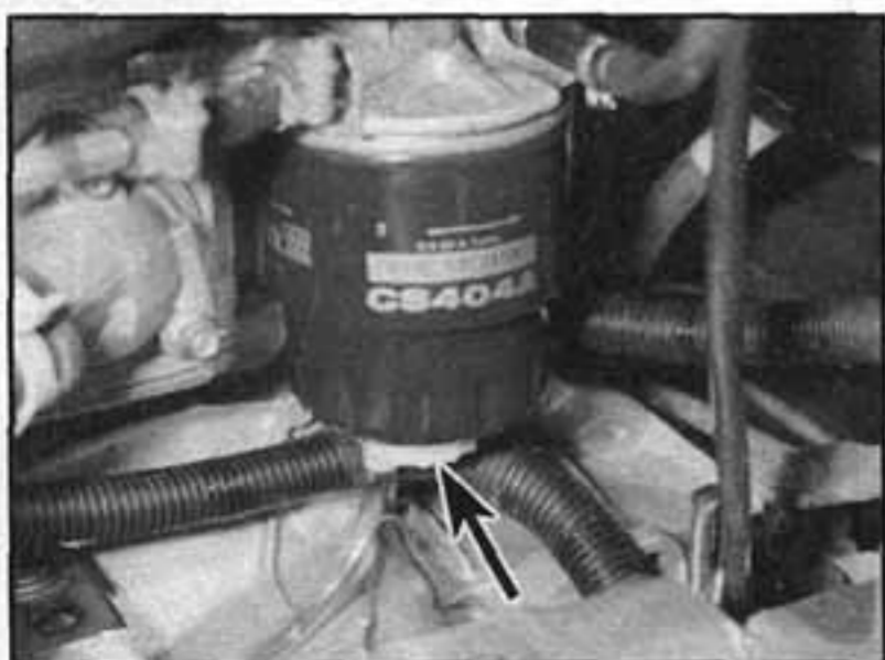
11.1 Šroub pro odvod vody z palivového filtru (viz šipka) – na obrázku je pro lepší viditelnost demontována baterie a sací potrubí
