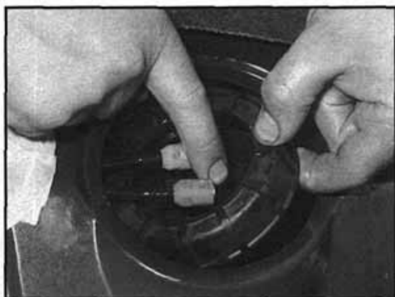
6.7 Vyšroubujeme pojistný kroužek...
