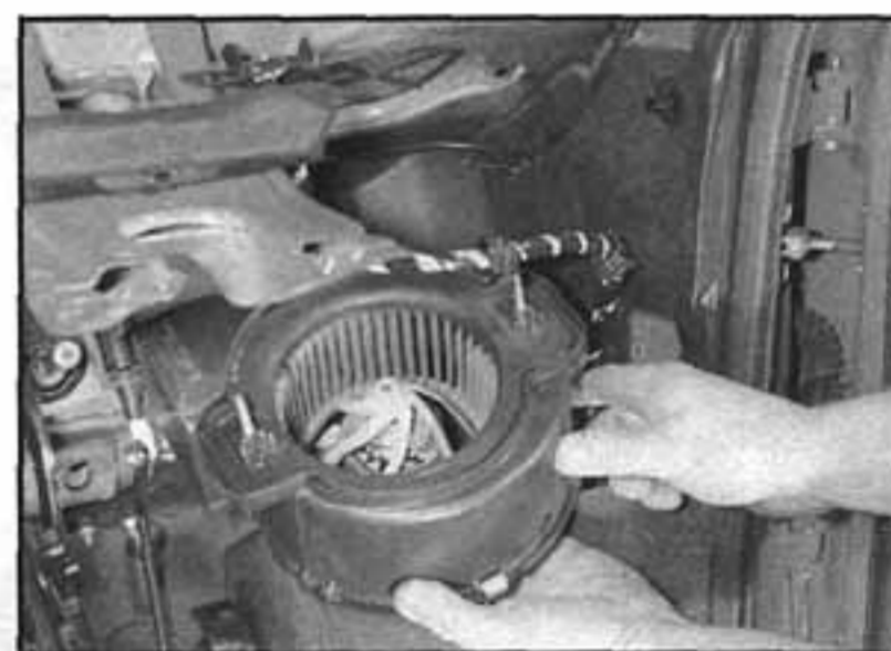
9.28b ... a spustíme sestavu ventilátoru topení dovnitř vozidla
