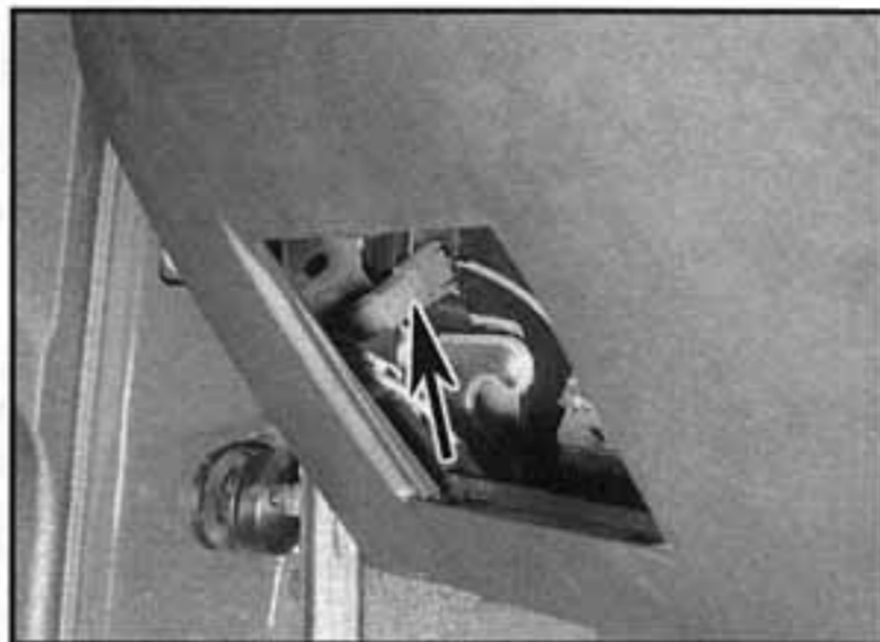
28.8 Odpojíme kabeláž airbagu/napínače bezpečnostního pásu
