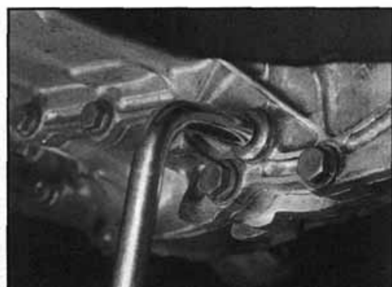
2.4b Vyšroubujeme vypouštěcí zátku z převodovky
