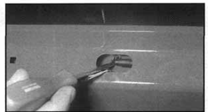
18.13a Pracujeme přes otvor třetího brzdového světla a vytlačíme trysku
