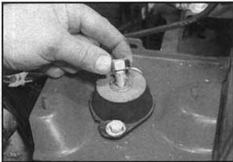
18.15a Uvolníme a demontujeme středovou matici a podložku gumového lůžka...
