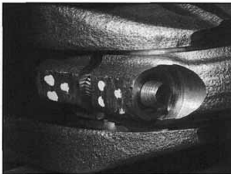
9.3 Identifikační značky ojnice a víka ojničního ložiska
