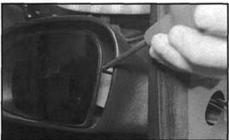
19.7 Pomocí tenkého šroubováku vyhákneme upevňovací svorku zrcátka
