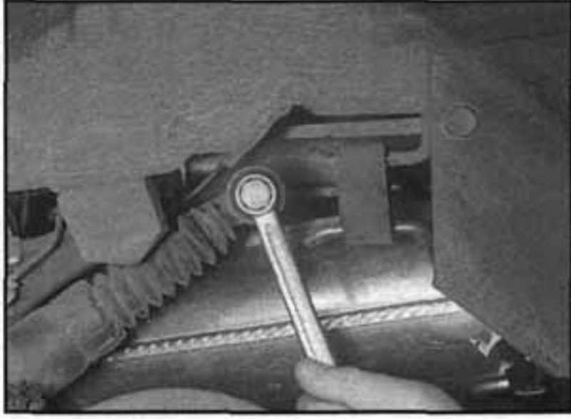
8.8 Při montáži neutahujeme úplně upevňovací šrouby až do doby, kdy je vozidlo spuštěno na kola
