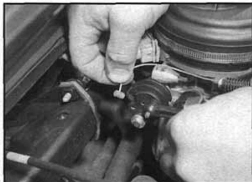
4.1 Uvolníme vnitřní táhlo plynu z tělesa škrticí klapky
