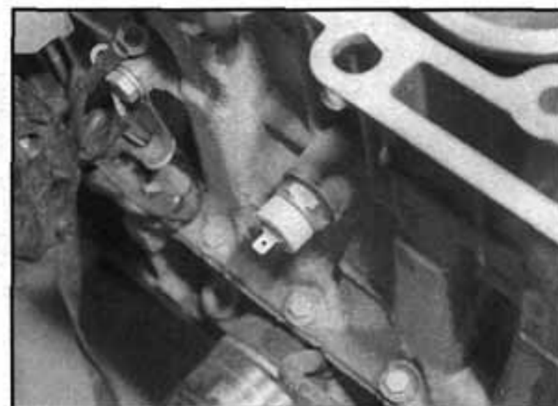
13.1 Umístění spínače tlaku oleje – modely se zážehovým motorem se slitinovým blokem válců
