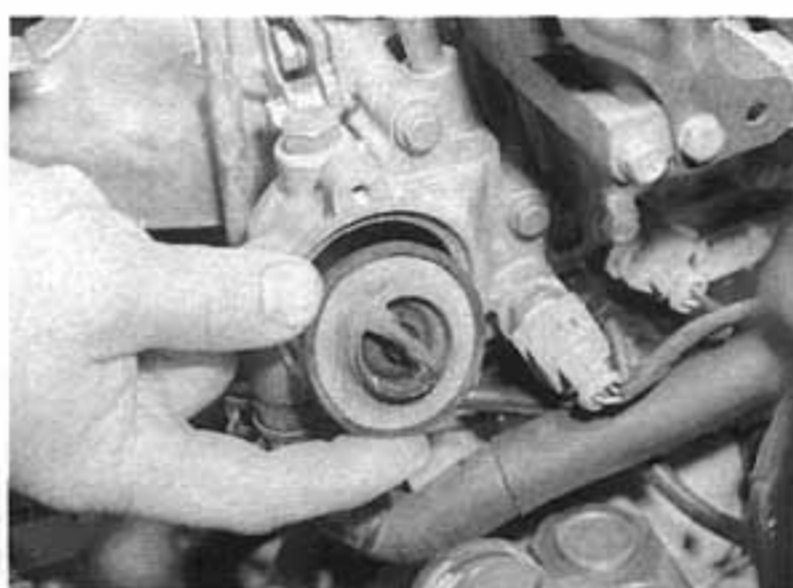
4.5a Vyjmeme termostat ven z tělesa...
