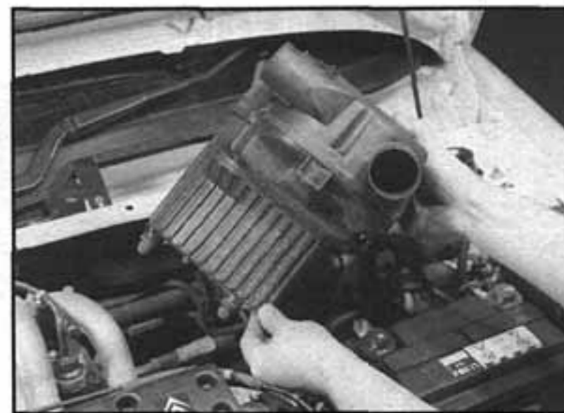
2.5b ...poté vyzvedneme vzduchový filtr z jeho spodního držáku
