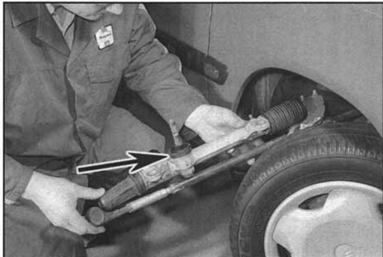
14.9 Vyjmutí převodky řízení – všimněme si těsnění hřídele hřebenového válce (viz šipka)
