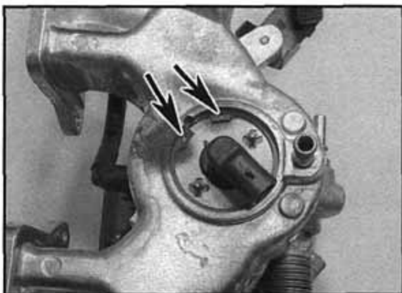
14.39 Uvolníme pojistný kroužek a vyjmeme topný článek ze spodní strany rozdělovacího potrubí
