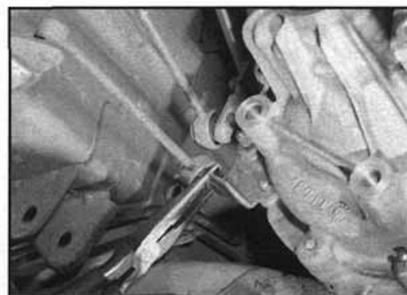
8.11 Vypáčíme řídící táhla mechanismu řazení převodových stupňů z jejich patřičných kulových kloubů na převodovce
