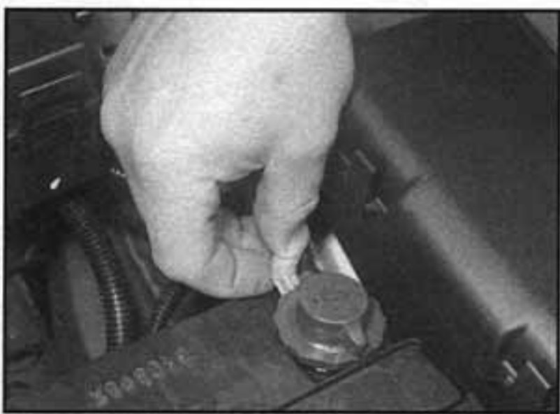
A Zkontrolujeme zabezpečení a stav koncovek baterie.
