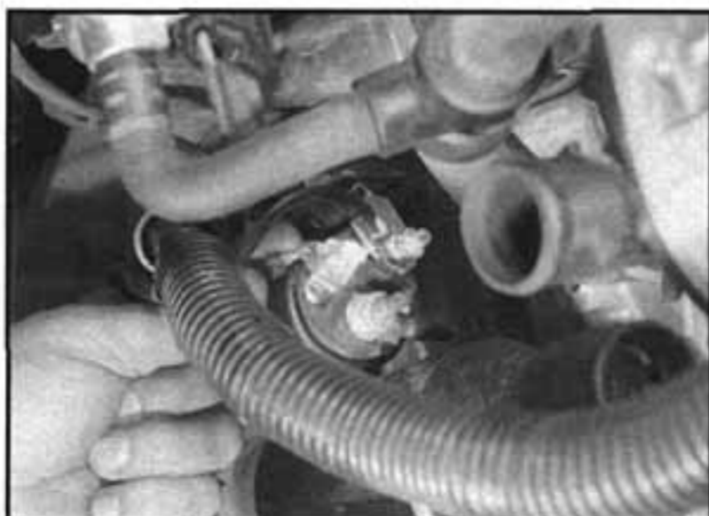
10.4 Demontujeme dvě upevňovací matice a odpojíme kabeláž od magnetického spínače startéru
