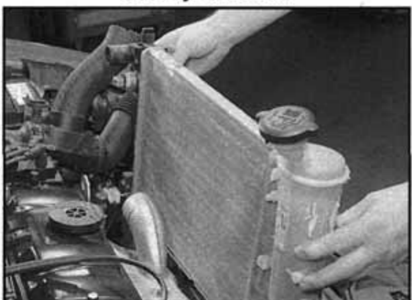
3.10a Vyjmeme chladič z motorového prostoru
