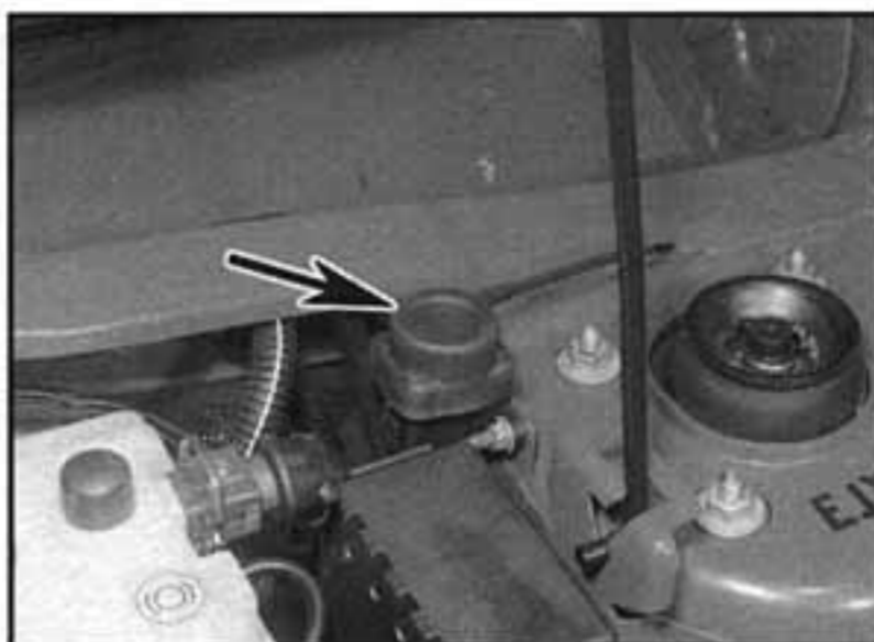
25.1 Umístění bezpečnostního vypínače
