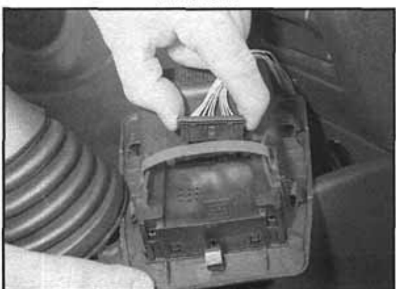
27.1c ...a odpojíme kabeláž
