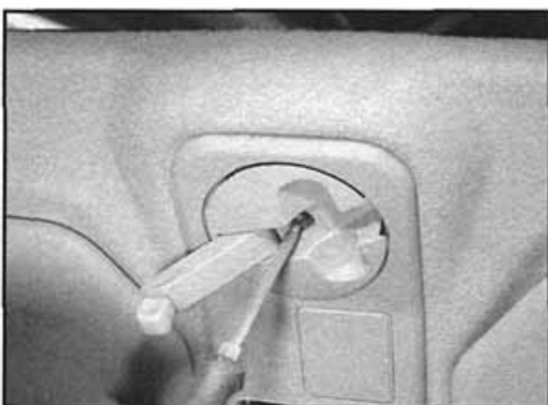
26.46a Demontujeme šroub upevňující kliku střešního okna...
