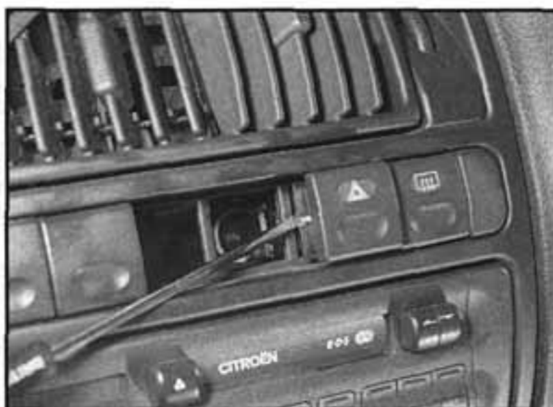
4.10a Vypáčíme spínač z panelu...
