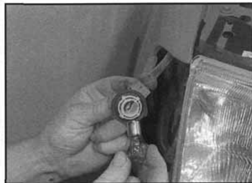
5.16 Otočíme držákem žárovky a žárovku demontujeme
