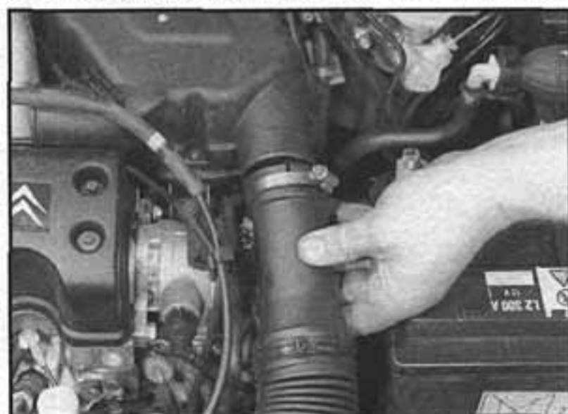
2.4 Uvolníme hadicovou svorku a povolíme vedení studeného vzduchu z přední části pouzdra vzduchového filtru
