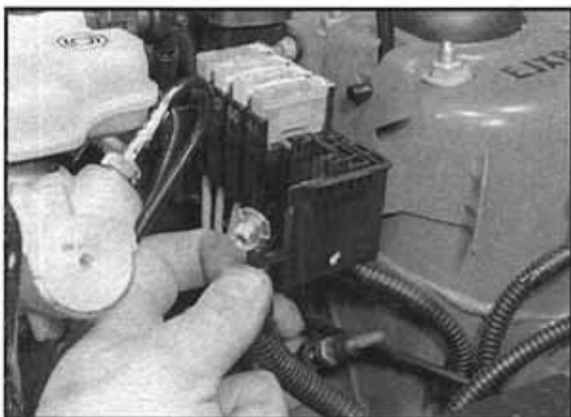
4.21d ...poté vyšroubujeme upevňovací matice a odpojíme kabelové vedení
