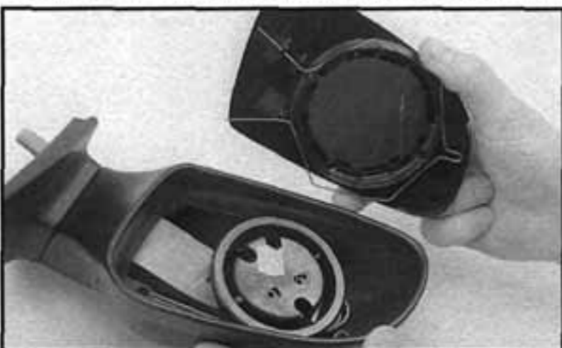
19.8 Demontované sklo zrcátka – vyháknutá upevňovací svorka
