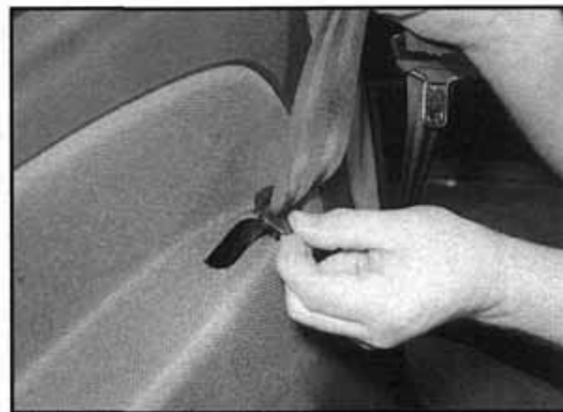
26.7 Vypáčíme kluznici bezpečnostního pásu a vytáhneme pás otvorem
