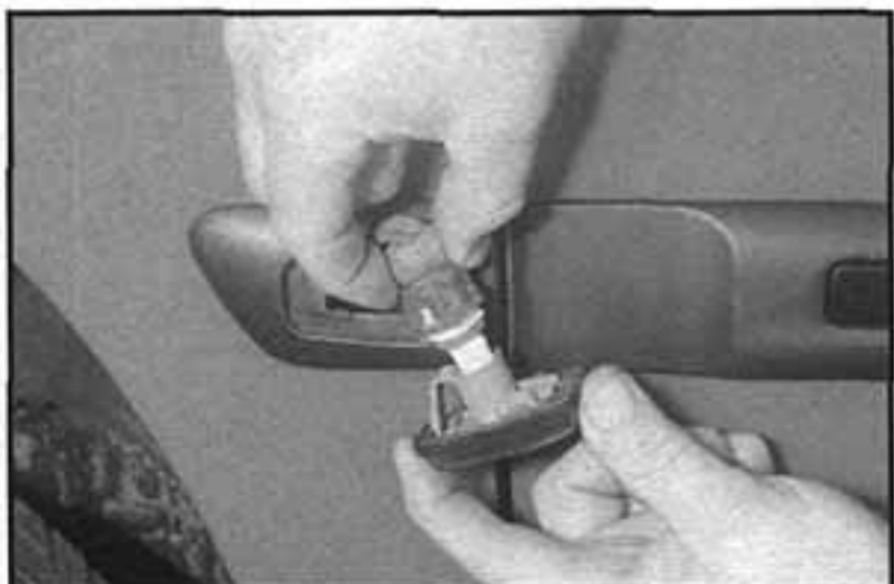
7.16 Odpojíme konektor kabeláže z držáku žárovky a demontujeme jednotku světla
