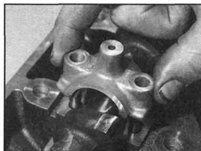
9.14 Nasadíme víka ložisek a ujistíme se, že jsou nasazeny správně, a to podle identifikačních značek
