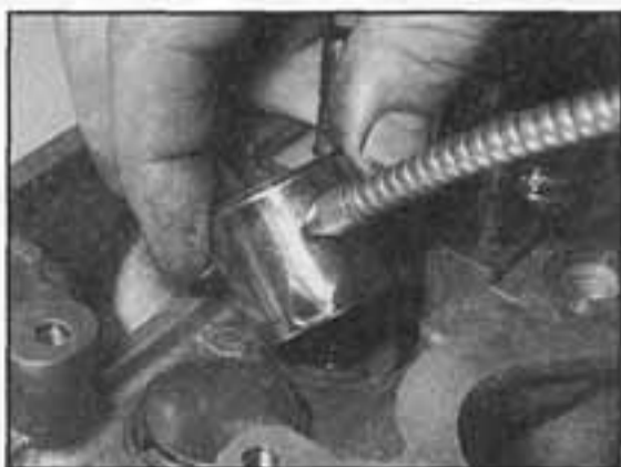
9.10 Namažeme zdvihátka motorovým olejem a nasadíme je do původních otvorů v hlavě válců
