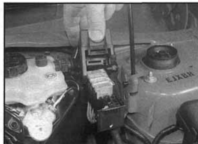
3.5 Tavné pojistky jsou zakryty v malé pojistkové skříňce v blízkosti věže úchyty pružící jednotky McPherson
