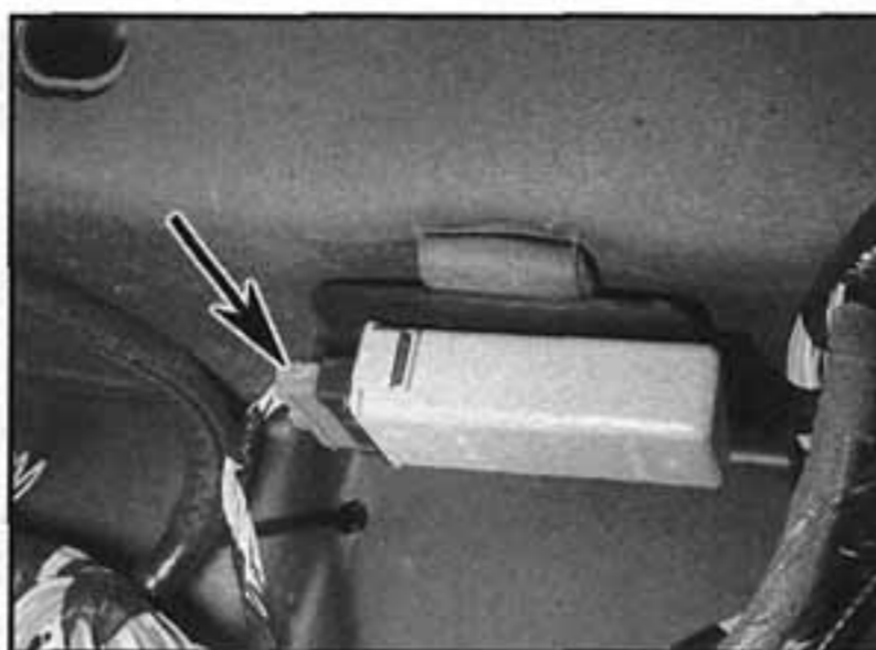
17.2 Řídicí jednotka centrálního zamykání umístěná za příruční schránkou – konektor kabeláže (viz šipka)
