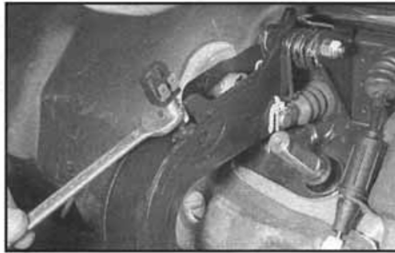
21.7a Uvolníme pojistnou matici spínače brzdových světel
