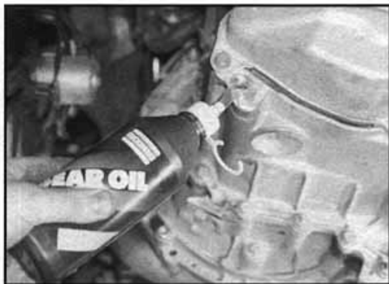
2.8 Dolijeme do převodovky požadované množství specifikovaného oleje
