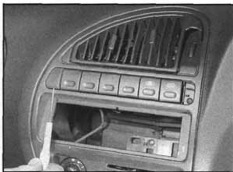
9.4a Uvolníme krytky panelu z obou stran ze středové rozvodné desky...
