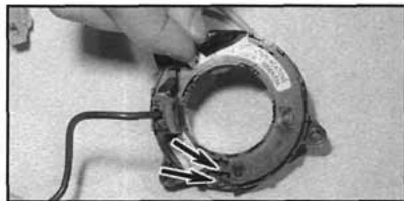
24.20 S vyrovnanými oranžovými šipkami (viz šipky) upevníme kontaktní jednotku prostřednictvím lepicí pásky, aby se neprotáčela
