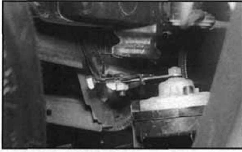
13.1 Umístění klaksonu – vidíme přes podběh kola
