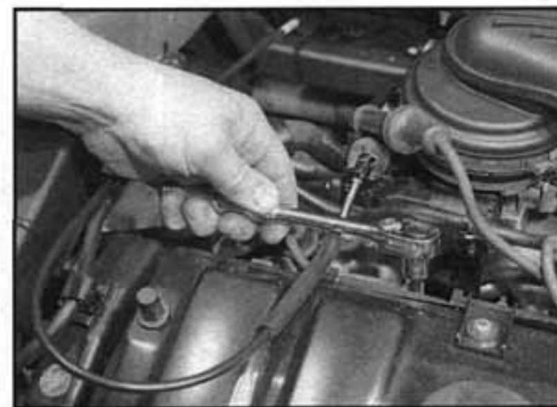
17.6a Vyšroubujeme zapalovací svíčku...
