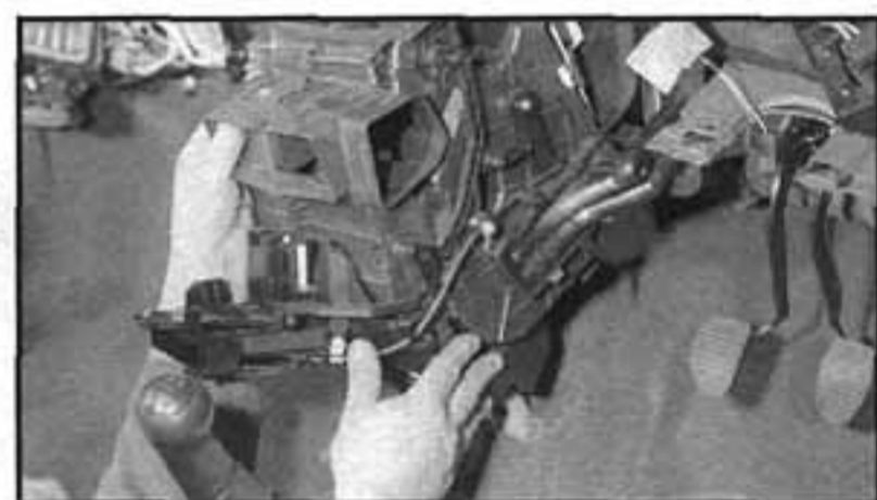
9.15b ...až do doby, kdy je průchodka potrubí topení uvolněna ze stěny mezi motorovým prostorem a prostorem pro nohy řidiče
